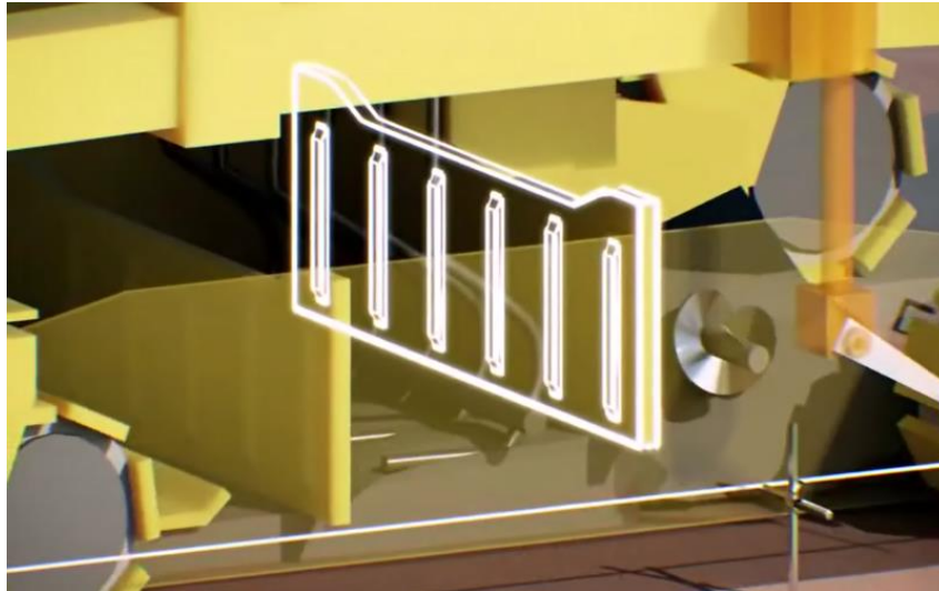
Imagen N° 18. Compuerta de alineación del concreto
