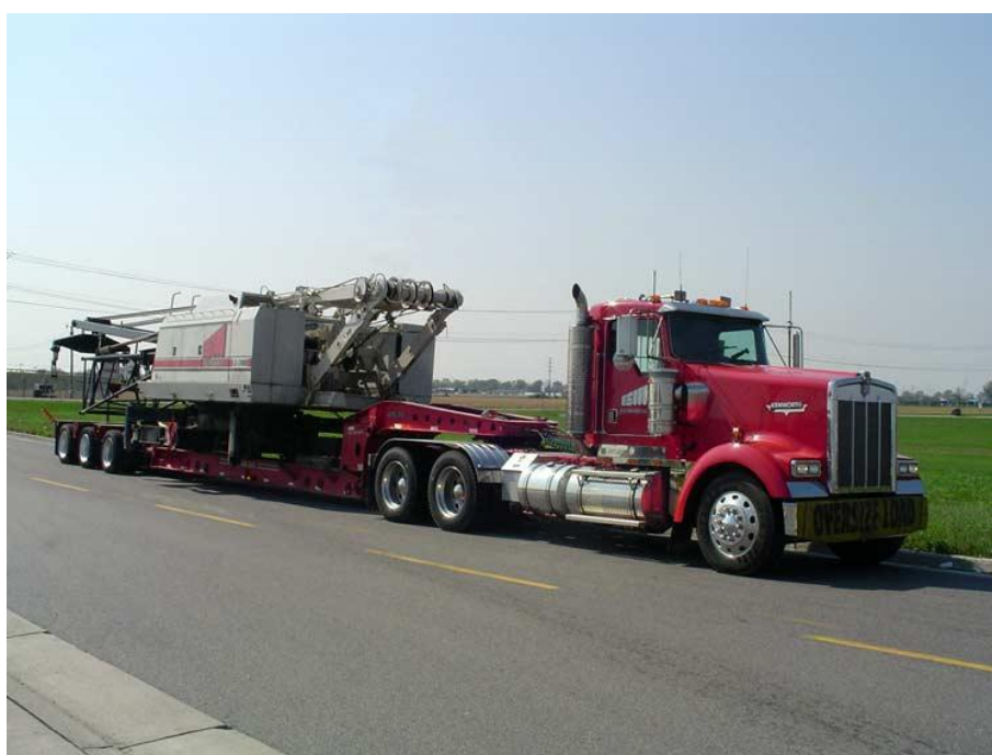
Imagen N° 9. Movilización de la pavimentadora de concreto
