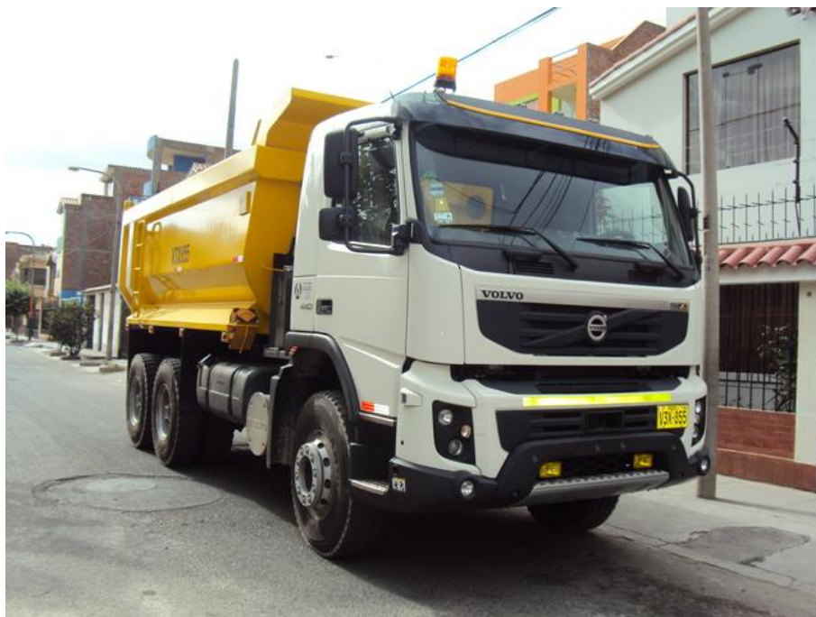
Imagen N° 2. Volquete de 15 m 3 , que transporta los equipos y materiales
