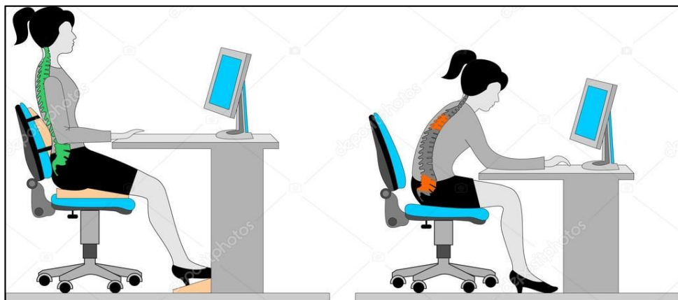
Figura 4: Diseño Correcto e incorrecto de una estación de trabajo para la corrección de la carga postural.
