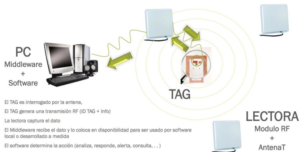
Figura 1. Como actúa RFID
