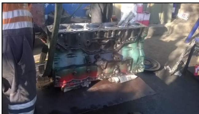
Figura 71. Forma tradicional de posicionamiento en el área de trabajo de los motores D12
