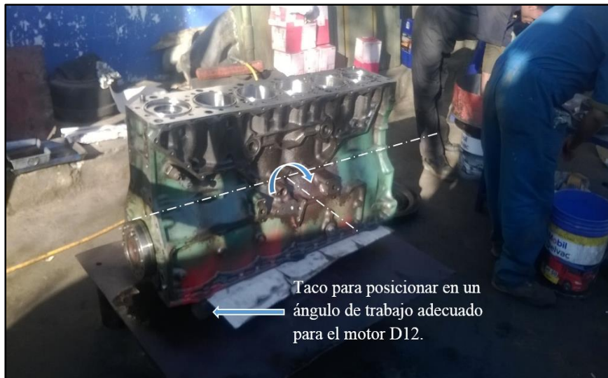
Figura 73. Forma tradicional de rotación horizontal (Ángulo de trabajo) de los motores D12
