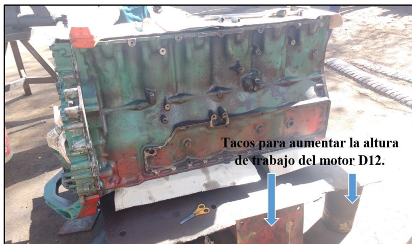
Figura 72. Forma tradicional de desplazamiento vertical o altura de trabajo de los motores D12
