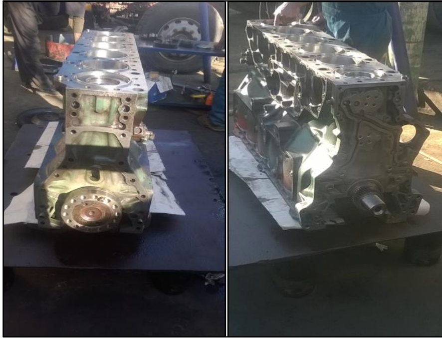
Figura 74. Reparación manual de motores D12 de forma tradicional
