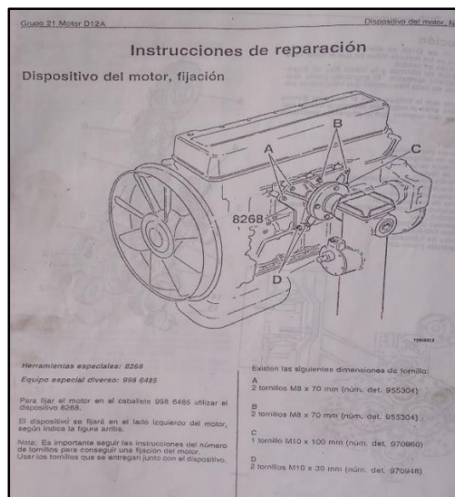
Figura 85. Forma correcta de reparar motores D12A
