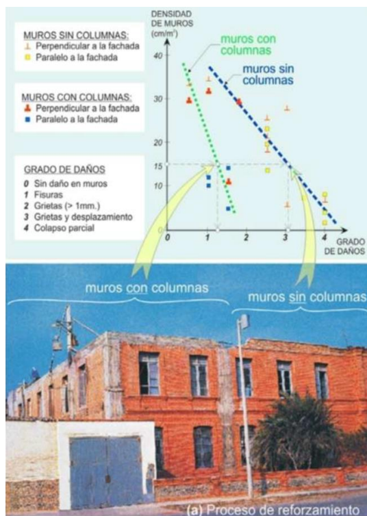
Figura 34. Relación directa entre la densidad de muros y el nivel de daño entre las edificaciones de albañilería confinada, este estudio aún mantiene vigencia
