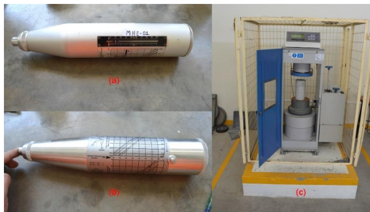
Figura 53. Instrumental utilizado para determinar la resistencia a la compresión relativa del esclerómetro. (a) esclerómetro 2, (b) esclerómetro 1, (c) Prensa de rotura ADR 1500
