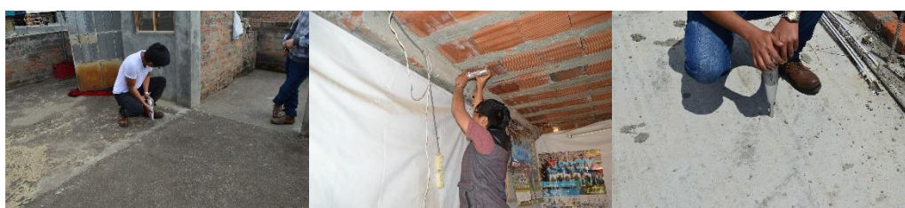
Figura 69. Ejemplos de toma de muestra para medir la resistencia a la compresión en vigas
