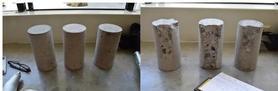
Figura 54. Probetas antes y después del ensayo a la compresión realizado por la prensa de rotura ADR
