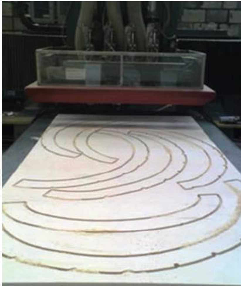
Figura 2: Fresadora CNC cortando plancha de plywood 18mm
