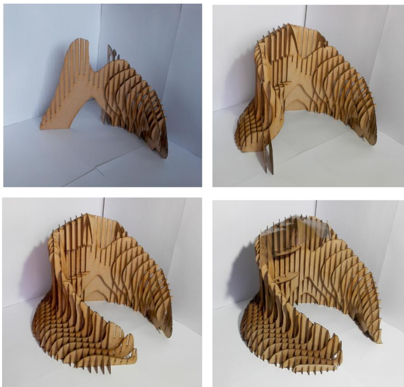
Figura 135: Proceso de ensamblado del prototipo seleccionado a escala 1/5
