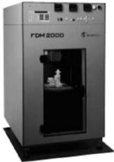
Figura 5: Maquina Stratasys de Modelado de deposición por fusión
