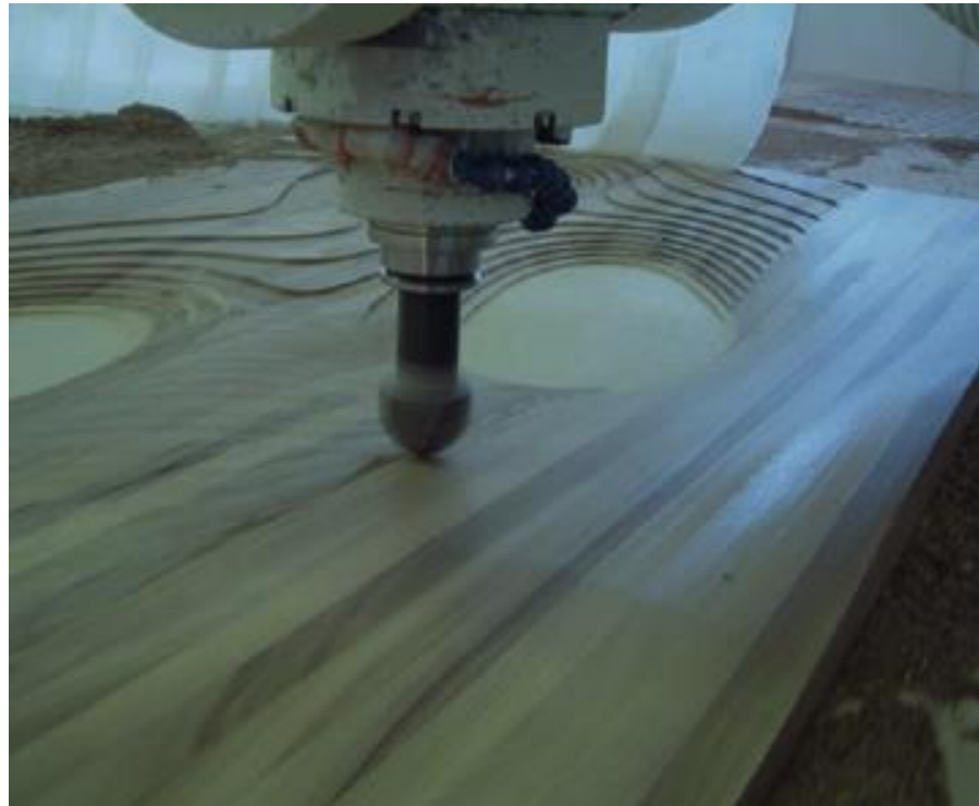
Figura 7: Proceso de contorneado con maquina CNC
