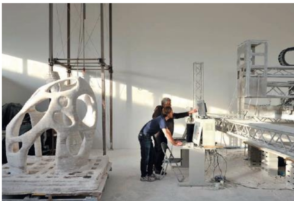
Figura 4: Prototipo del Pabellón Radiolaria fabricado con Estereolitografía
