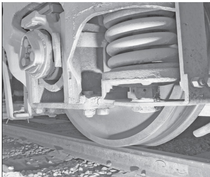
Figura 88: Las suspensiones de resorte inducen vibraciones en vehículos en movimiento, como en este carro de ferrocarril. Para predecir su comportamiento debemos analizar las vibraciones. Fuente: Hibbeler, 2010, p. 630.
