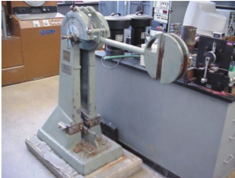
Figura 74: Una prueba de impacto Charpy se usa para determinar la cantidad de energía absorbida por un material durante el impacto, al restar la energía potencial gravitatoria final del brazo a su energía potencial gravitatoria inicial. Fuente: Beer, 2010, p. 1107.
