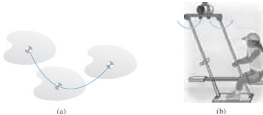
Figura 58: a) Un objeto en traslación no gira. b) La parte en traslación del columpio, sobre la que está sentada la niña, permanece en su nivel. Fuente: Bedford & Fowler, 2008, p. 281.
