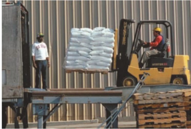
Figura 63: Montacargas y su carga en movimiento pueden analizarse como un sistema de dos cuerpos rígidos conectados en movimiento plano. Fuente: Beer, 2010, p. 1036.
