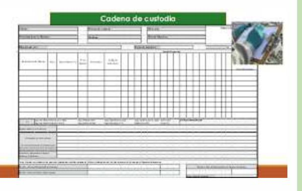
Llenar la cadena de custodia indicando los parámetros a evaluar, tipo de frasco, tipo de muestra de agua (agua residual cruda, agua residual tratada), volumen, número de muestras, reactivos de preservación, condiciones de conservación, operador del muestreo y otra información relevante.
