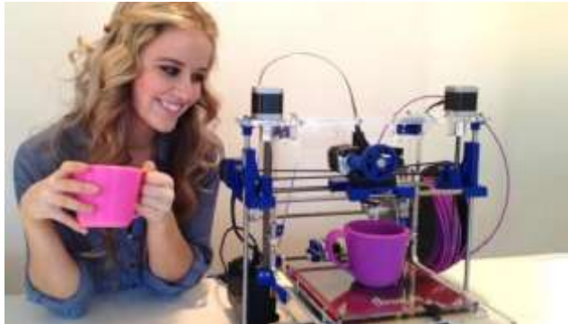
Producción de tazas con filamento ABS.
