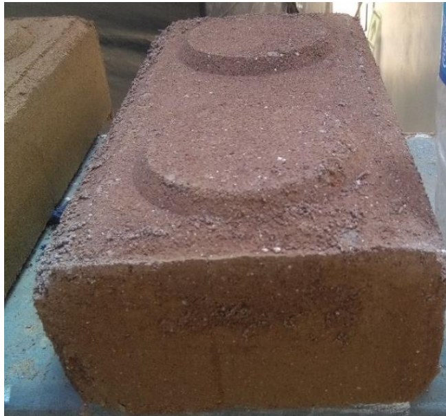
Fotografía 37: BTC-E-23 durante la etapa de curado
