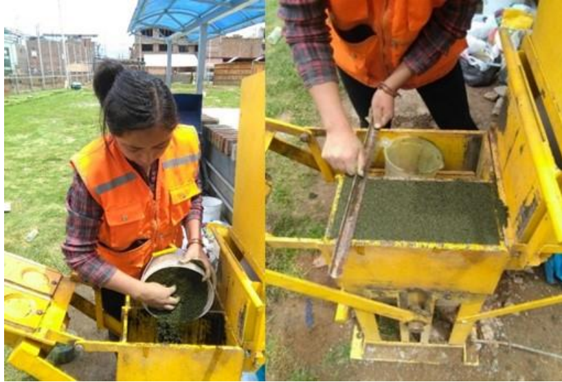
Fotografía 8: Mezcla para BTC en el molde
