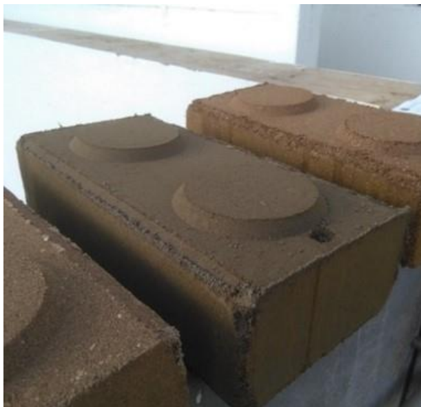
Fotografía 25: BTC-E-13 después de ser retirado de la maquina prensadora
