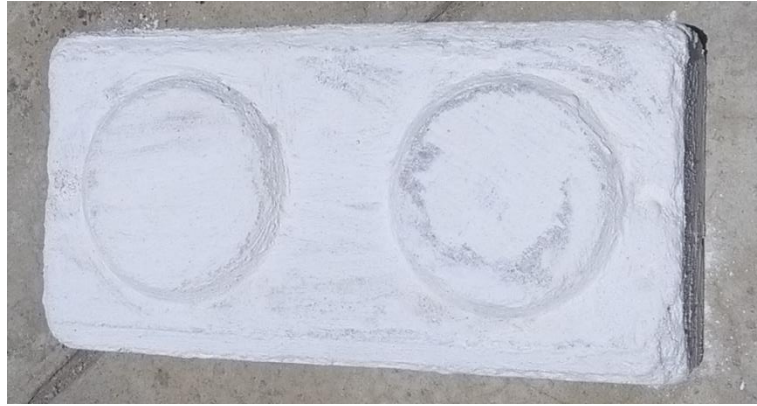
Fotografía 40: Bloque con impermeabilizante de pintura de cal
