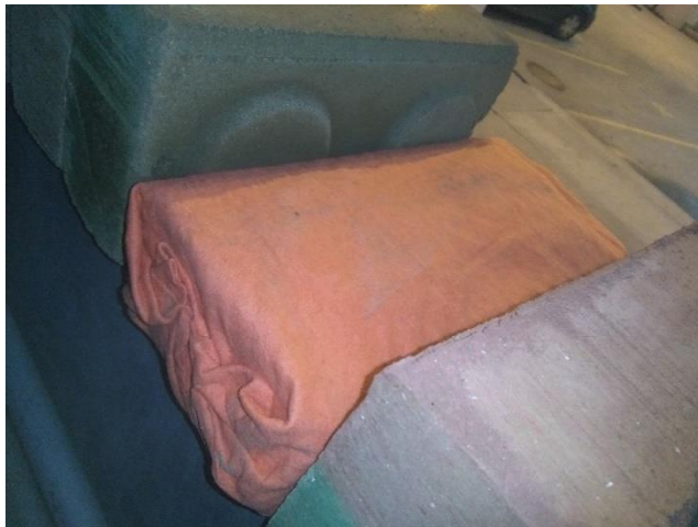
Fotografía 11: Curado de BTC por recubrimiento con lona
