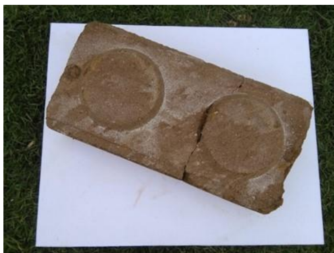
Fotografía 41: Bloque con Impermeabilizante con lechada de Cal
