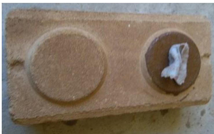
Fotografía 47: Bloque aplicando impermeabilizante aceite de linaza
