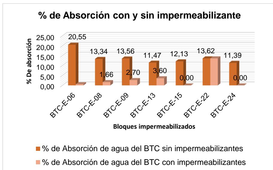
Figura 29: Porcentaje de absorción con y sin impermeabilizante
