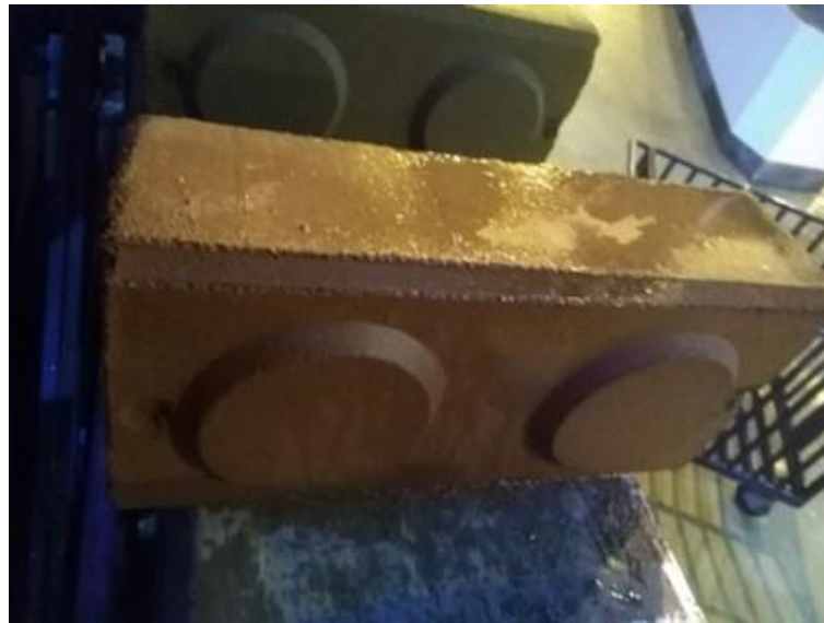
Fotografía 12: Curado de BTC por aspersión de agua
