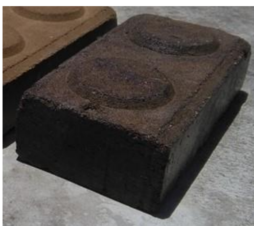
Fotografía 46: BTC con impermeabilizante sellador de Barniz
