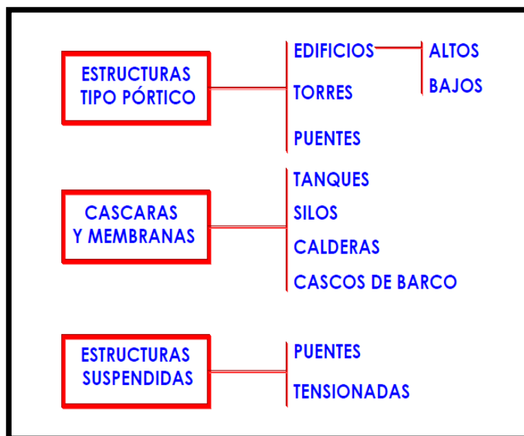
Figura 01: Sistemas estructurales de acero en la actualidad
