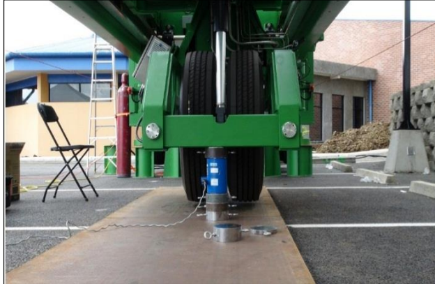
Fotografía N° 5: Calibración celda de carga (HVS)
