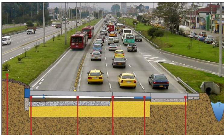
Figura N° 1: Composición Estructural Autopista Norte
