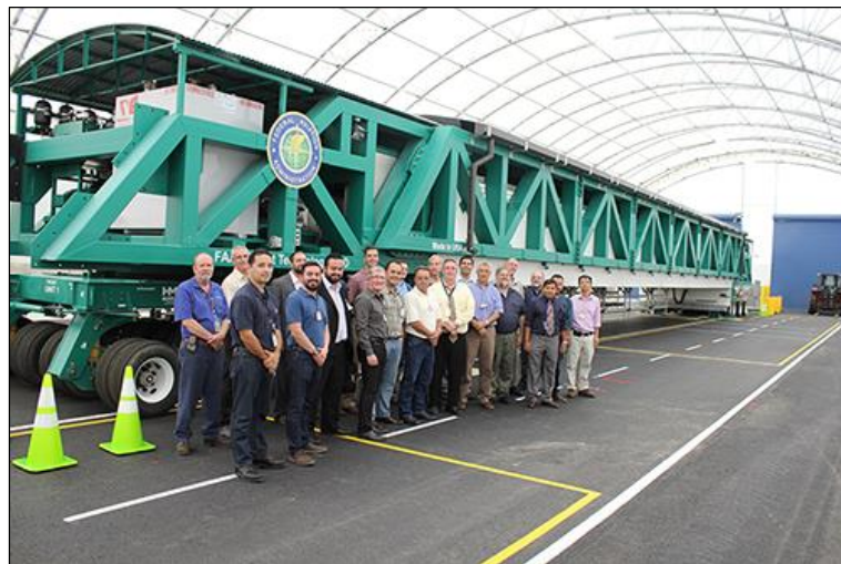
Fotografía N° 1: Modelo del Heavy Vehicule Simulator (Mark VI) adquirido por el LanammeUCR.
