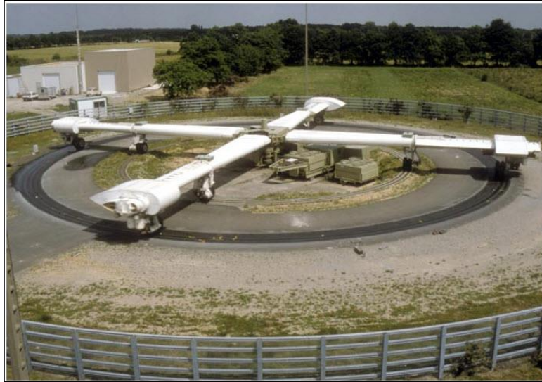
Figura N° 2: Carrusel para estudio de la fatiga en los pavimentos LCPC
