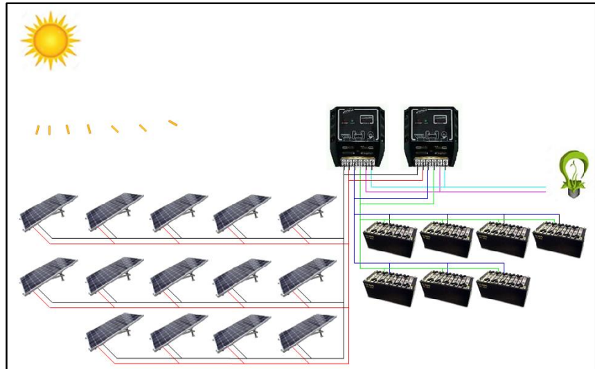
Gráfico 21. Modelamiento del sistema solar fotovoltaico.
