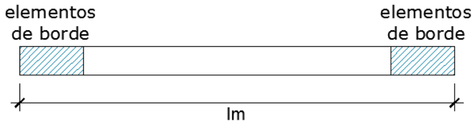
Figura 83: Elementos de borde de una placa.
