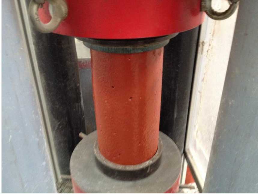
Descripción: Probeta con cuatro capas de recubrimiento en equipo compresor.
