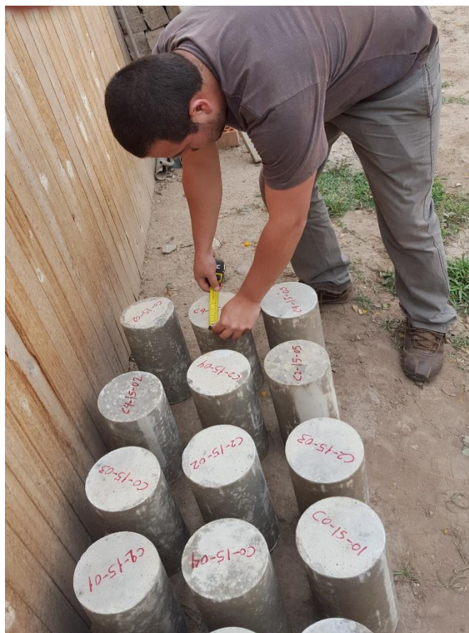
Descripción: Medición del diámetro de testigos sin recubrimiento.
