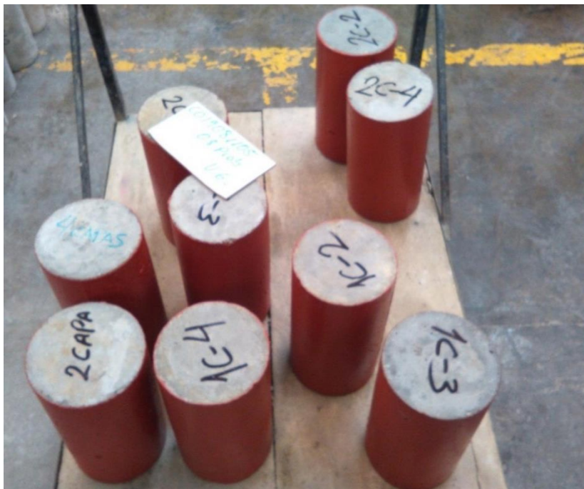
Descripción: Probetas de concreto por ensayar (con dos y cuatro capas de cobertura)
