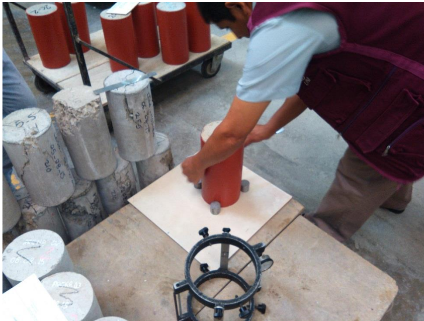
Descripción: Preparación de la probeta para el ensayo de módulo de elasticidad.
