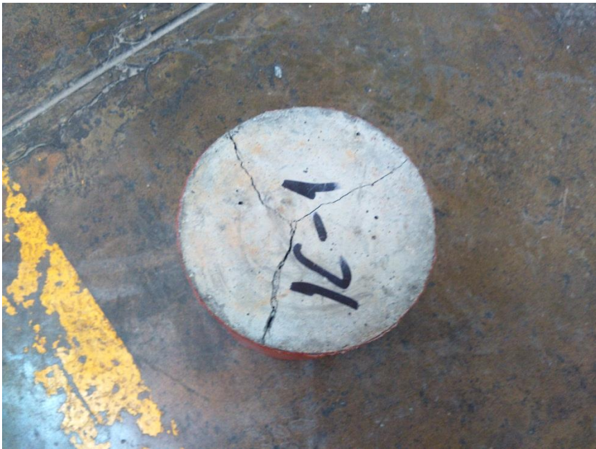
Descripción: Falla de probeta con dos capas de recubrimiento.
