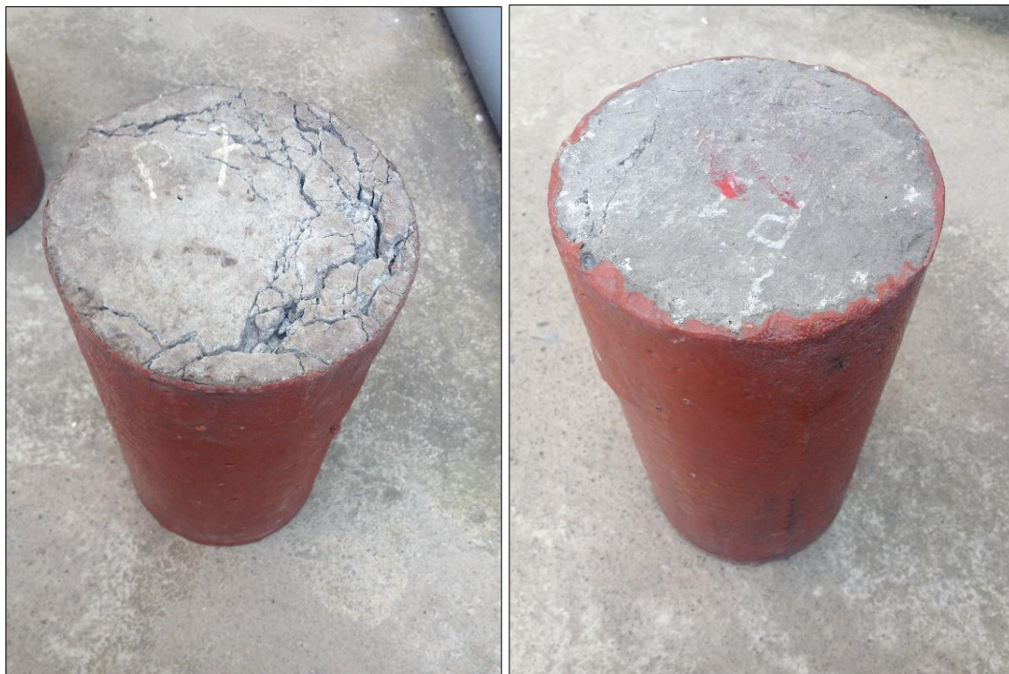
Figura 46: Falla de probetas revestidas con polímero NexSpray a cuatro y seis capas.
