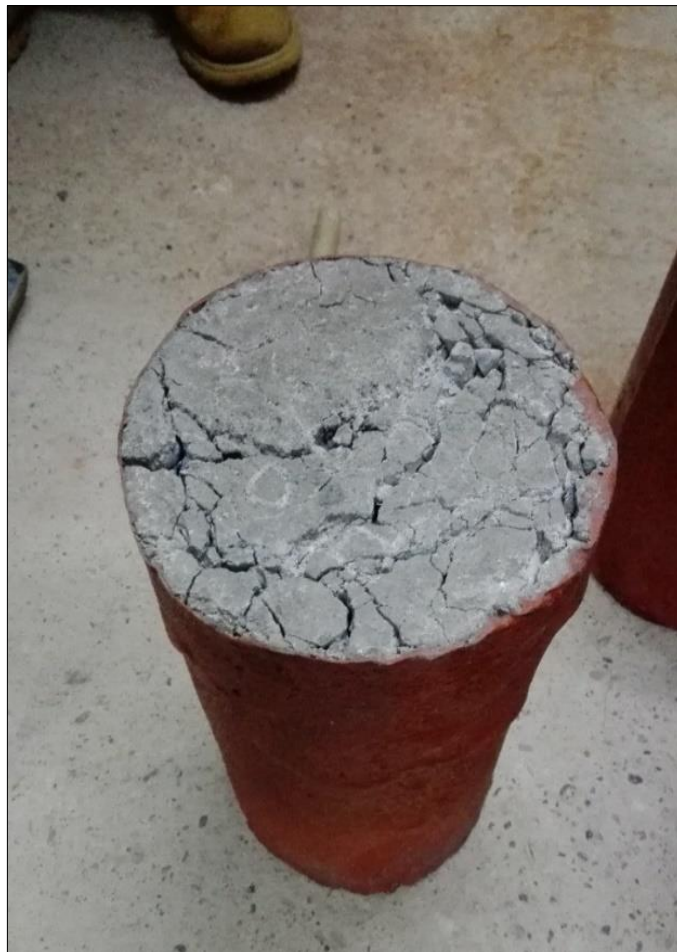
Figura 45: Falla de probetas patrón y probetas revestidas con polímero NexSpray a dos capas.
