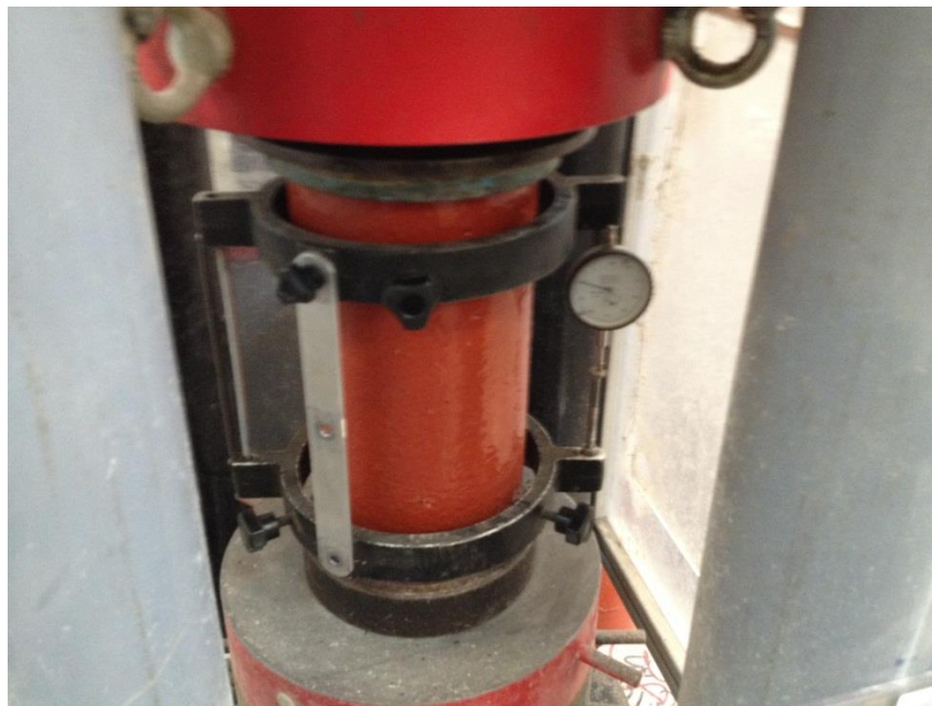
Descripción: Probeta para realizar el ensayo de módulo de elasticidad y diagrama Esfuerzo deformación.
