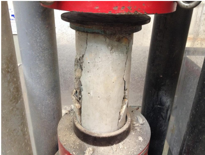
Descripción: Falla de probeta sin recubrimiento.
