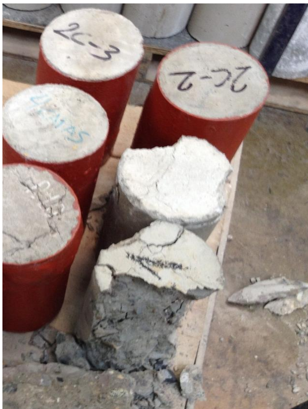
Descripción: Probetas ensayadas con y sin recubrimiento.
