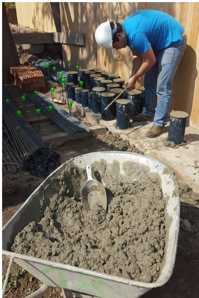
Descripción: Compactación de la mezcla de concreto para la obtención de testigos de concreto.
