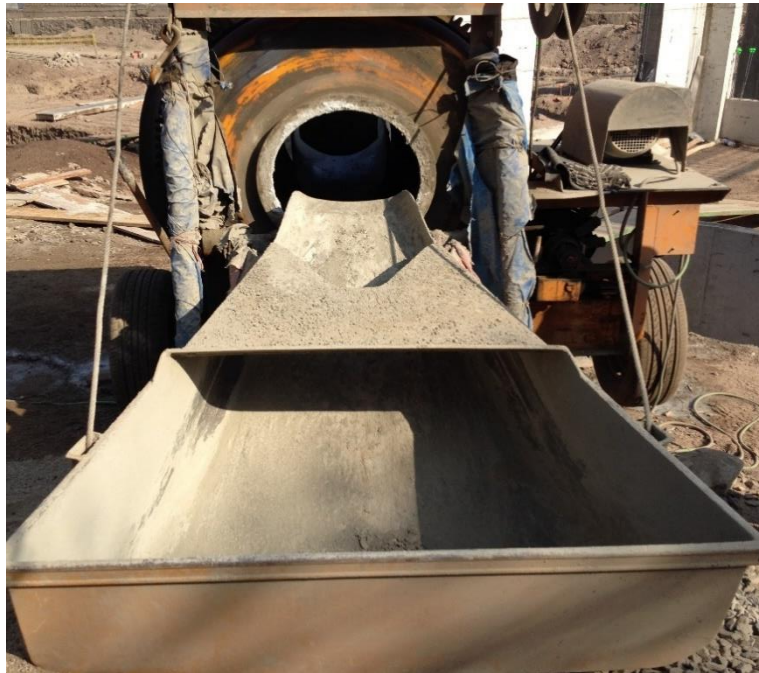
Descripción: Mezcladora tipo Tolva para el mezclado de arena, piedra, agua y cemento.
