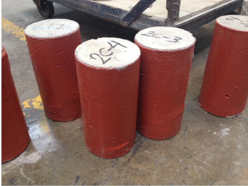
Descripción: Probetas ensayadas con cuatro capas de recubrimiento.
