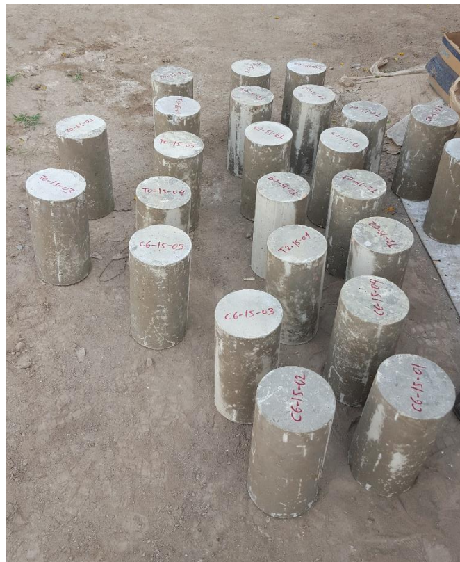
Descripción: Probetas de concreto a ensayar para ser colocar recubrimiento.
