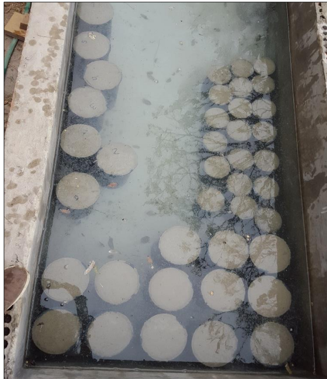
Figura 4: Curado de especímenes de concreto.
