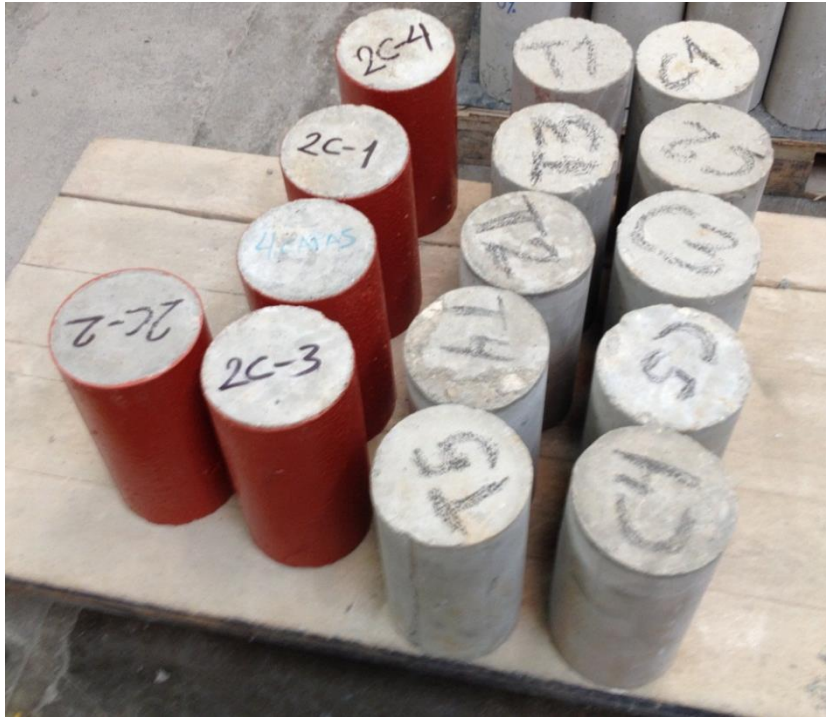
Descripción: Probetas de concreto a ensayar (sin y con cuatro capas de recubrimiento)
