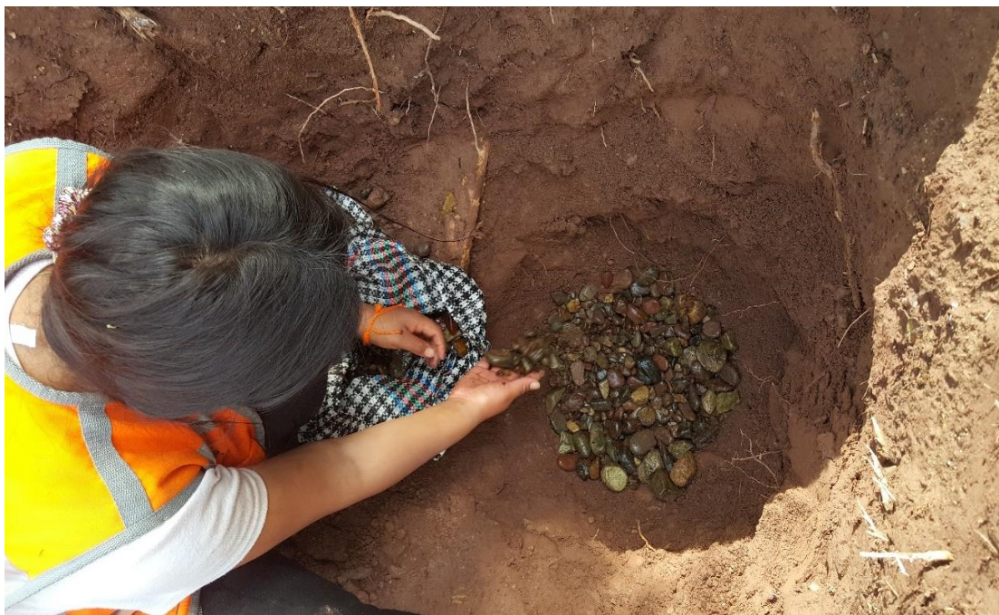
Figura 113. Test de percolación para determinación de Ubs.
