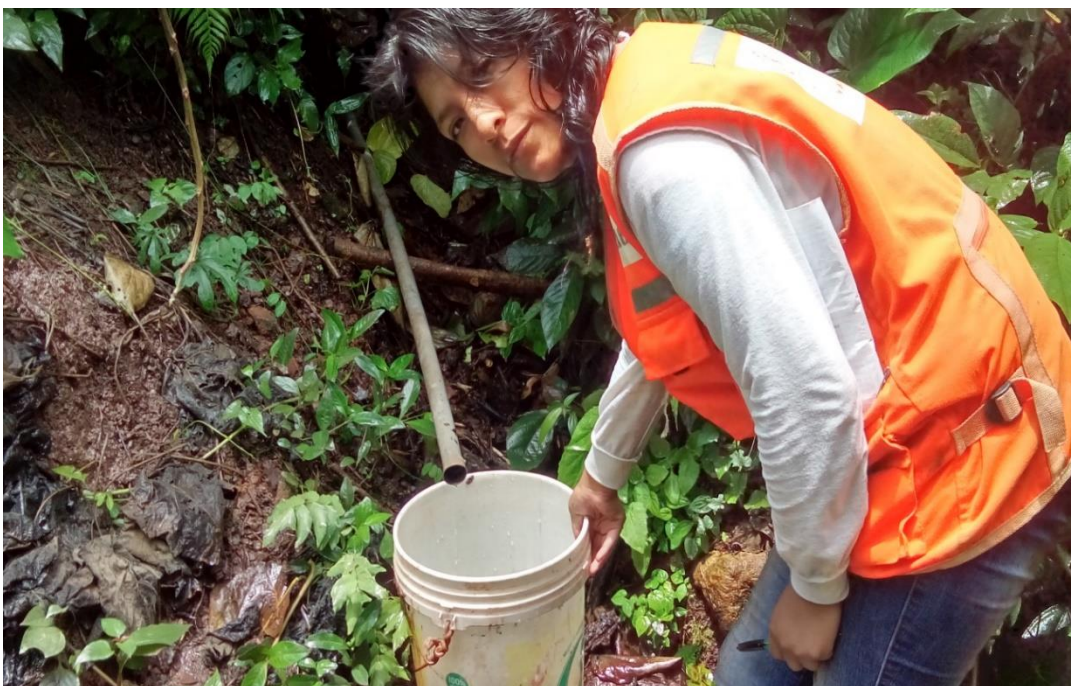
Figura 77. Aforo de agua , tomado del segundo punto de agua
