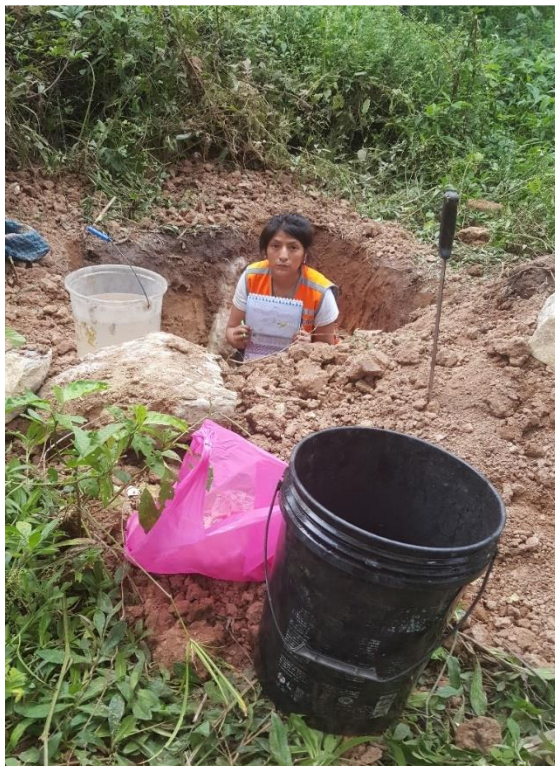
Figura 112. Test de percolación para determinación de UBS.
