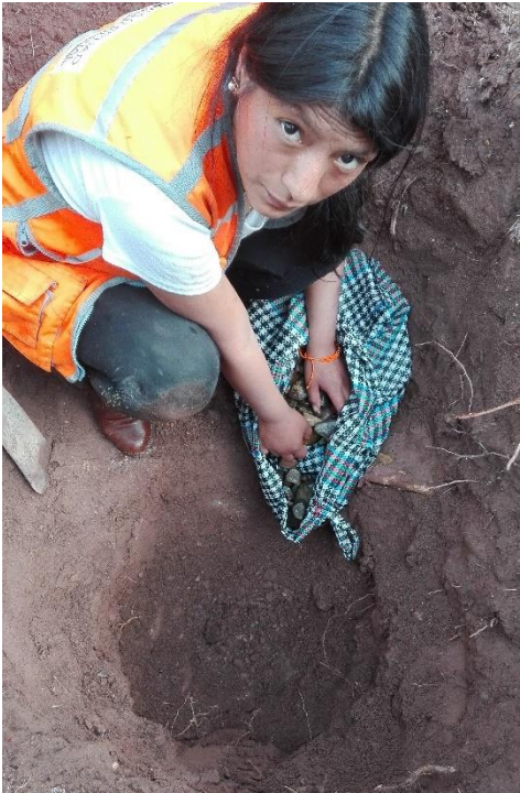
Figura 107. Test de percolación para determinación de UBS.
