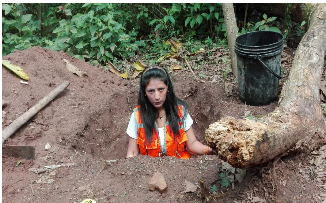
Figura 101. Test de percolación para determinación de UBS
