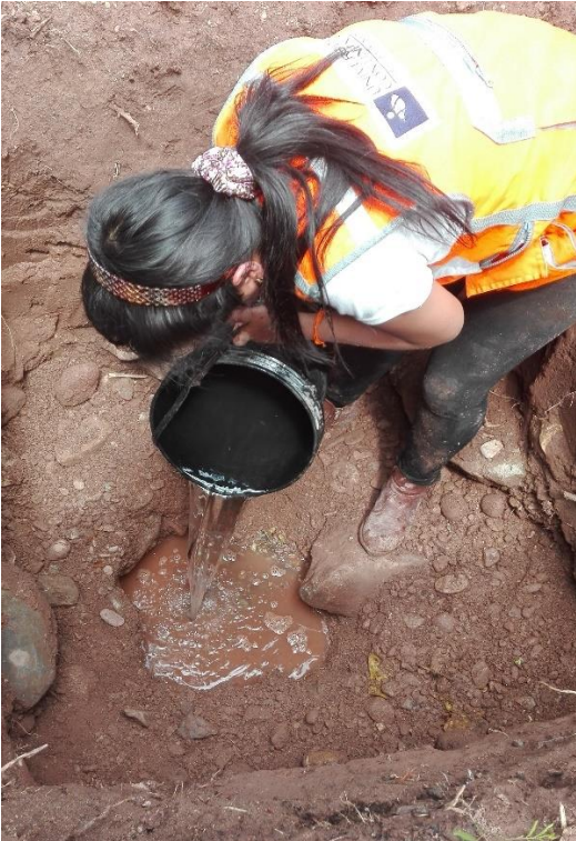
Figura 105. Test de percolación para determinación de UBS
