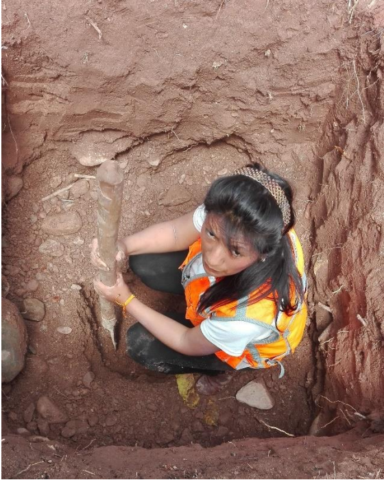
Figura 102. Test de percolación para determinación de UBS.
