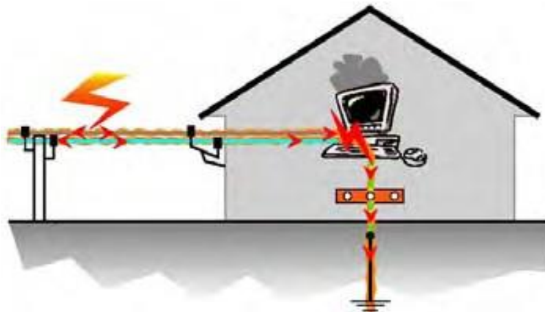
Gráfico 45. Descargas directas sobre líneas de potencia aérea
