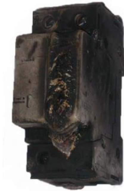
Gráfico 38. Efectos de una sobretensión temporal en un protector
