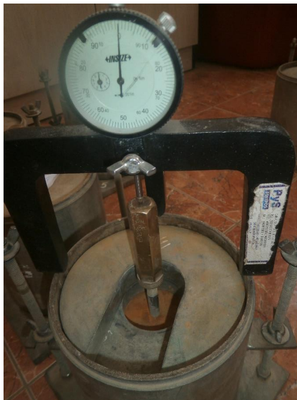
Ilustración 17. Colocación del trípode para ensayo de expansión.
