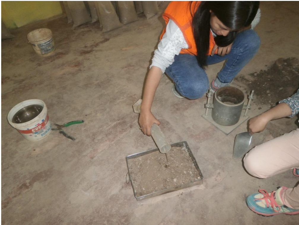
Ilustración 15. Compactado del molde de CBR con 10, 25 y 56 golpes.
