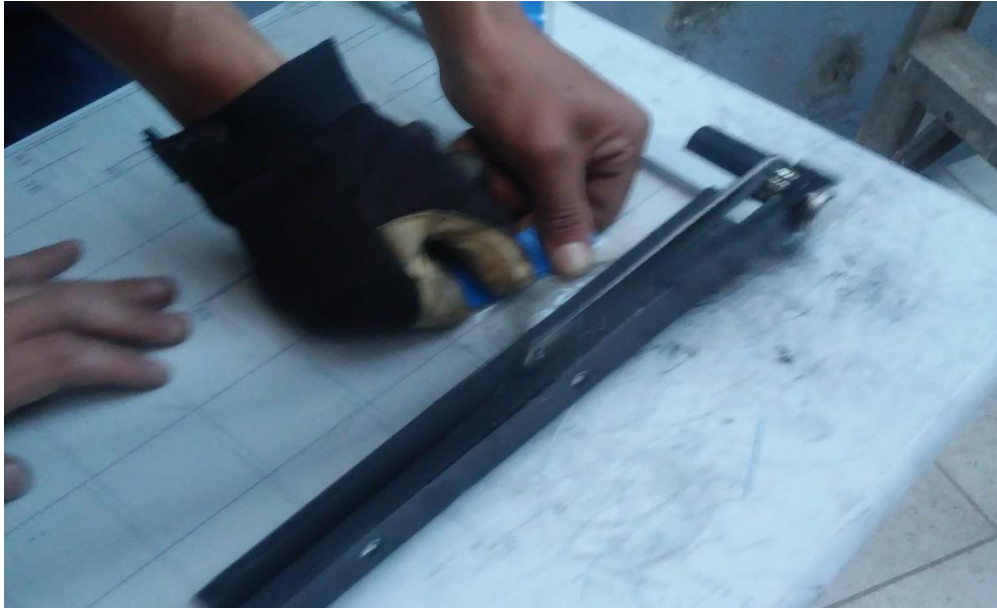
Ilustración 27. Obtención del aditivo PET con el uso de cizalla de papel.
