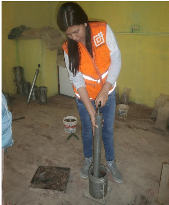
Ilustración 15. Compactado del molde de CBR con 10, 25 y 56 golpes.
