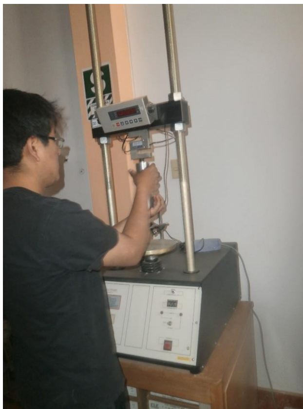
Ilustración 19. Preparación de la prensa de CBR para el ensayo de penetración, con apoyo del técnico de Daset.
