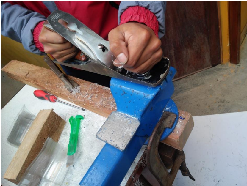
Ilustración 28. Obtención del aditivo PET con el uso de cepillo de madera.
