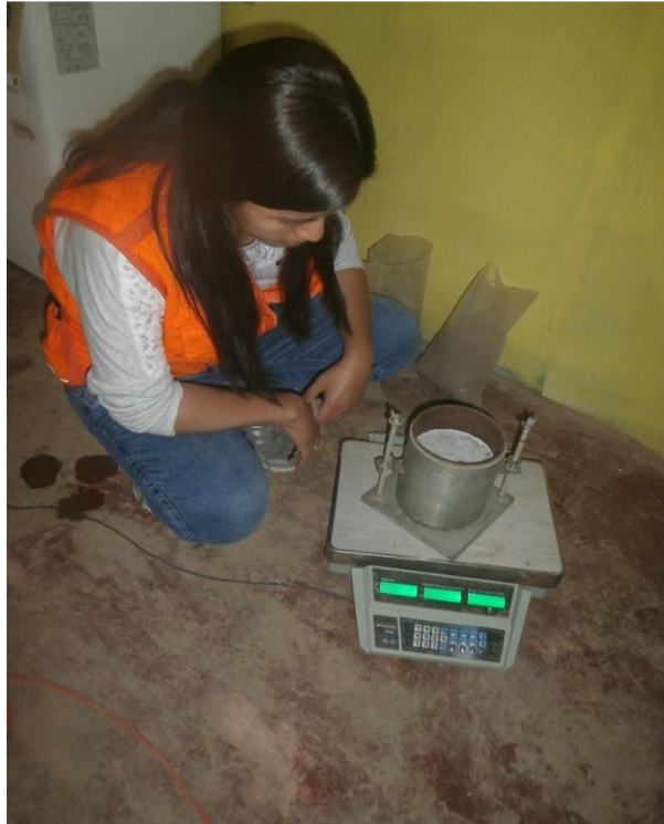
Ilustración 17. Colocación del trípode para ensayo de expansión.
