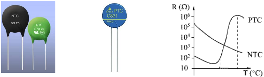
Figura 01. Resistencias NTC, PTC y curva característica.
