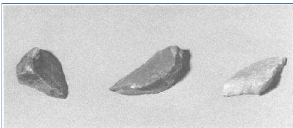
Figura: 3 Partículas Fracturadas (Bordes agudos, Superficies Alisadas)
