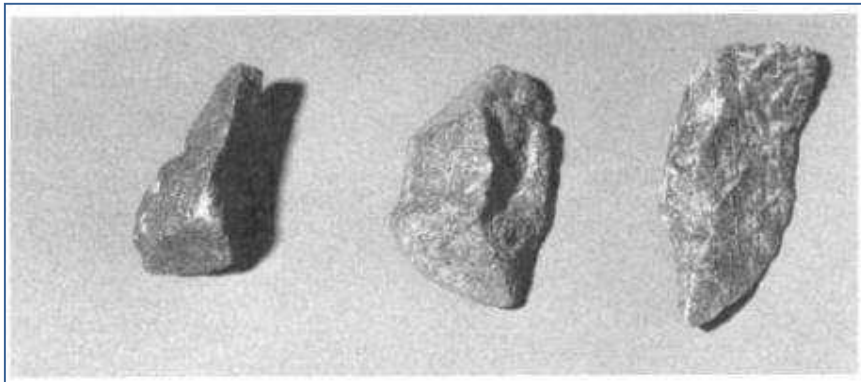
Figura: 2 Partículas Fracturadas (Bordes Agudos, Superficies Rugosas)
