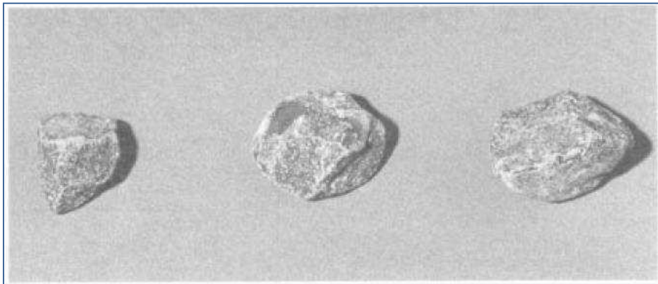
Figura: 4 Partículas Fracturadas (Bordes redondeados, Superficie Rugosa)
