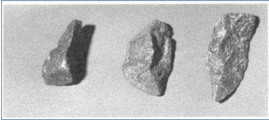
Figura: 2 Partículas Fracturadas (Bordes Agudos, Superficies Rugosas)
