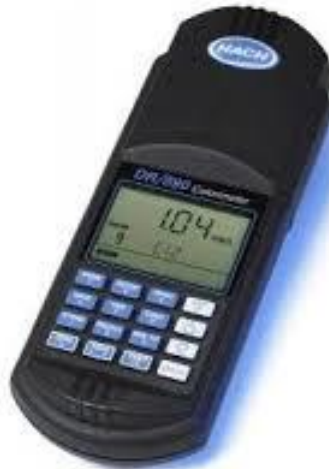
Figura N4: Colorímetro el que nos permite cuantificar la cantidad de materia oxidable ya sea orgánica e inorgánica
