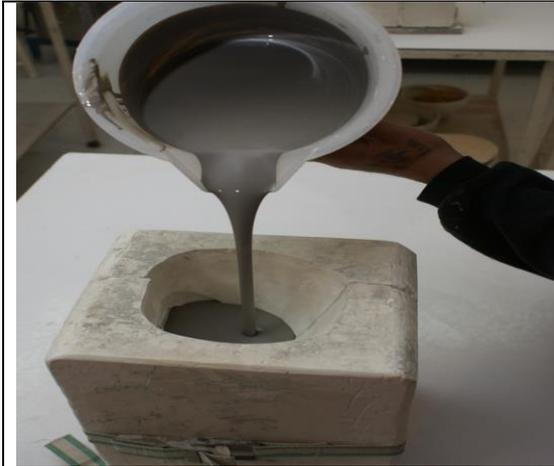
Seco y limpio el molde realizamos la primera prueba. Las dos partes del molde se sujetan con un cincho para que queden bien ajustadas. Se vierte la barbotina que se haya elegido.
