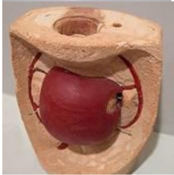
La figura de cera recubierta de material refractario (se presenta en sección para que se vea el interior). Dentro de la figura hay arcilla o arena que sirve de alma para que el final quede hueco. Las líneas que se ven son los canales de aireación por los que saldrá el aire al entrar el bronce por el agujero superior. Al calentar este molde se derrite la cera y sale, quedando el hueco que ocupará el bronce.
