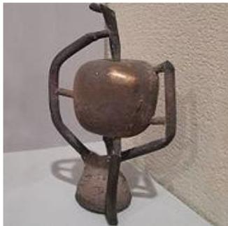
Enfriado el metal, se saca del molde. Quedan unas varillas que son los canales de aireación. Estas varillas se cortan y se liman para que no dejen rastro.
