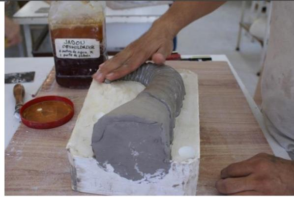
Aplicamos el jabón desmoldador en el área del yeso. Procurando no formar burbujas o dejar rayas o marcas que harían más difícil el desmolde. Normalmente uso jabón industrial, sin agregados de color ni aromatizantes. Comúnmente es de color ámbar y se debe diluir 6 partes de agua por 1 de jabón y se mezcla calentándolo en baño de María. Se guarda bien tapado. En caso de solidificarse se procede a calentar nuevamente.
