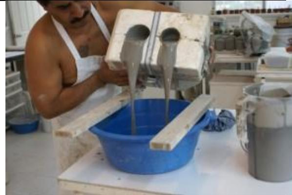
Compruebe la formación o el grosor de pared en el molde. Retire el excedente.
