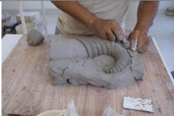
Tomando como eje la línea que marcan las dos partes del original, procedemos a formar el molde perdido con arcilla. Lo pulimos y lo recortamos.
