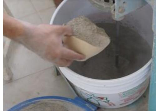
Mezcle y agregue poco a poco el material seco. De esta manera vaya agregando el defloculante y la arcilla seca, en forma alternada y poco a poco hasta llegar a la cantidad adecuada para su formulación. Cuide de no pasarse de los 100 gr. de máximo de defloculante.
