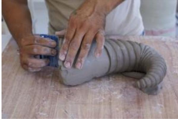
Partimos del modelado de la pieza original. Revisamos la simetría para evitar candados o trampas que atoren el yeso y la barbotina. Marcamos las dos partes. Agregamos, modelando, la boca de vaciado
