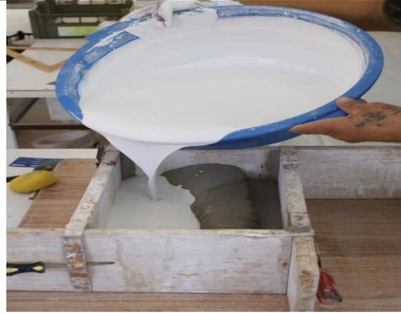
Cuando el yeso esta terso y fluido, lo vaciamos partiendo de una esquina de la cajonera hasta llenarlo completamente en una forma continua. Observarán que en este paso no se aplicó ningún desmoldante. Porque la arcilla y la madera no lo necesitan.
