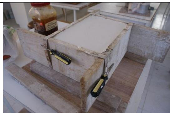
Con esto tenemos las dos caras del molde. Dejamos reposar unas horas. Pasado este tiempo procedemos a separar las dos partes y retirar el original. Ponemos a secar el molde. El tiempo de secado dependerá del clima, el grosor y peso del molde. Se puede acelerar el secado poniéndolo al sol o con ventilador de aire caliente. Nunca en horno ni con fuego, corremos el riesgo de calcinarlo. Pero siempre debemos de secar las dos partes juntas.
