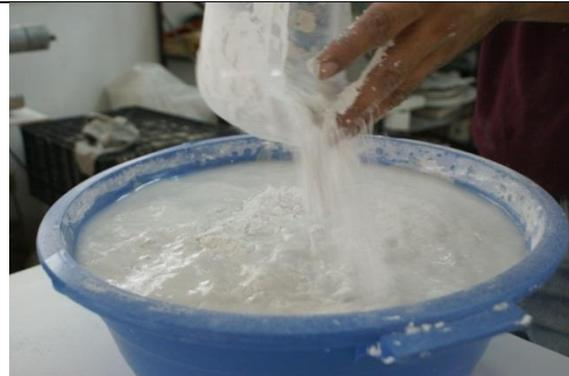
Para preparar el yeso cerámico, colocamos la cantidad de agua deseada a temperatura ambiente. Poco a poco, sin batir, agregamos el yeso.
