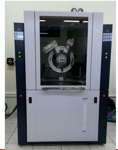
DIFRACTÓMETRO DE RAYOS X (DRX) Bruker – ECO Advance
