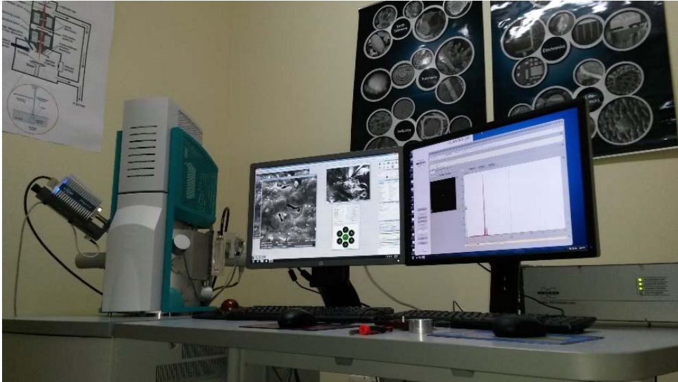
MICROSCOPIO ELECTRÓNICO DE BARRIDO – TESCAN VEGA 3 LMU – EDS-STEM
