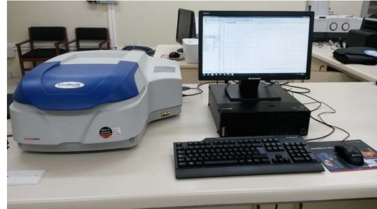
ESPECTROFOTÓMETRO – Analytik-Jena, SPECORD PLUS 250 190 – 1100 nm
