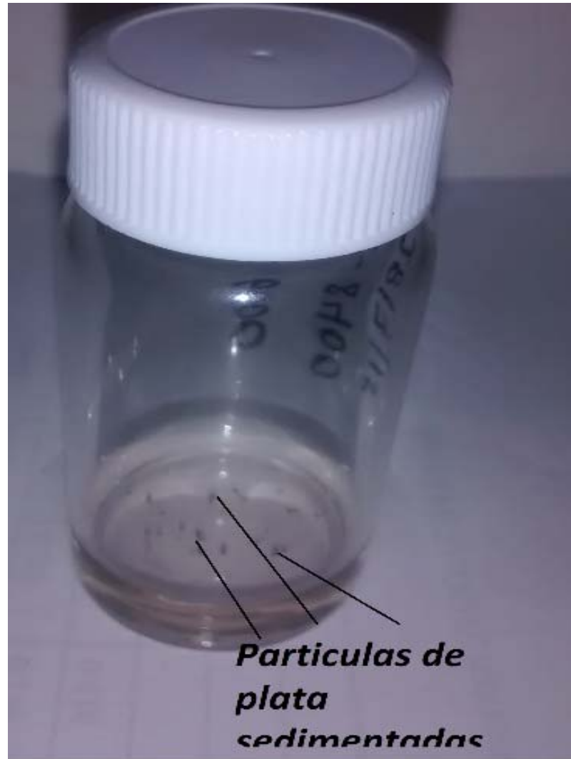
Fig. 17. Fotografía de los coloides de nanopartículas de plata generadas a 3600 pulsos y reablacionadas a 8400 pulsos, después de ocho días se observa sedimentación.
