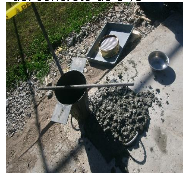
Figura 12. Asentamiento del concreto de 9 ½”
