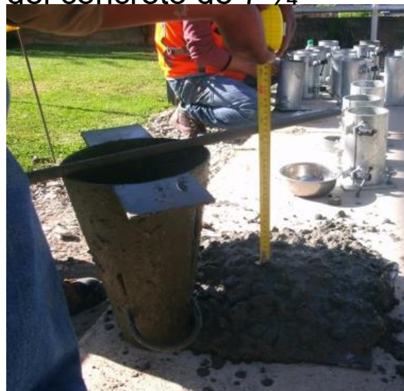
Figura 11. Asentamiento del concreto de 7 ¾”
