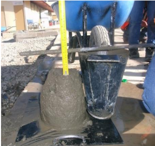
Figura 10. Asentamiento del concreto de 5 ½”
