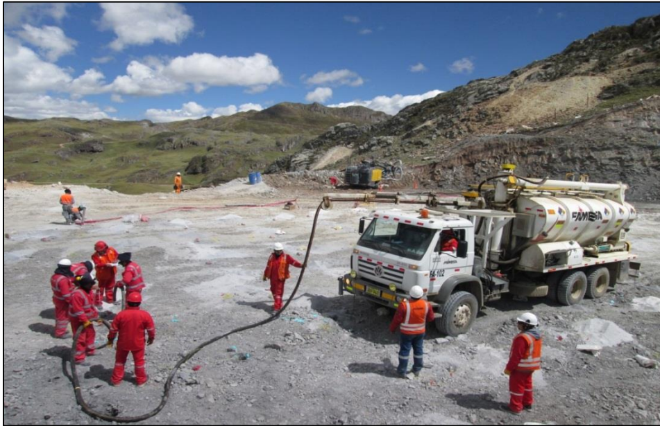
Figura 29: Carguío de taladros con camión fábrica en el tajo San Gerardo.
