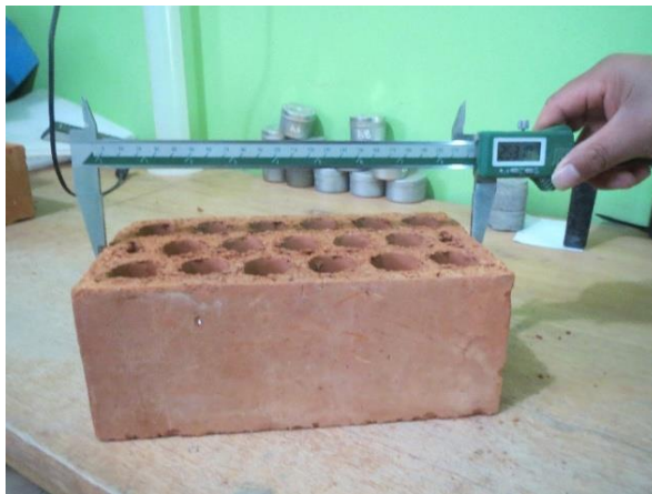
Figura 33: Cálculo del área bruta en un espécimen industrial
