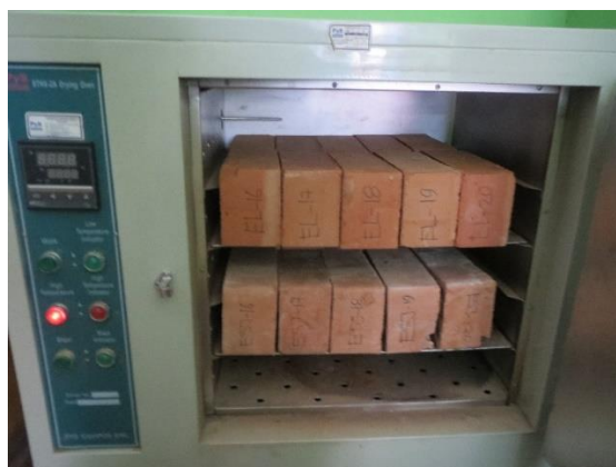
Figura 26: Muestras de ladrillos industriales secadas a 110°C por 24 horas.
