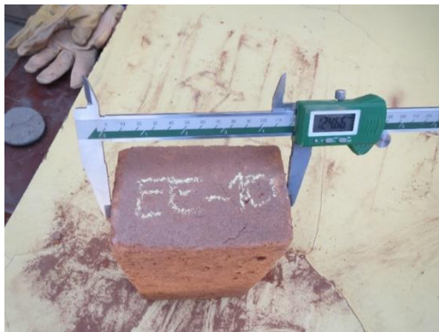
Figura 20: Medición del espesor de ladrillo artesanal.
