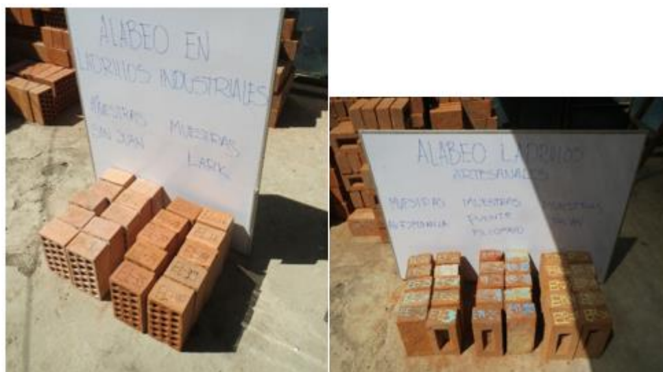
Figura 22: Muestras industriales a la izquierda, y artesanales a la derecha, separados para el ensayo de alabeo.
