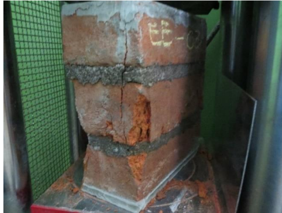
Figura 39: Espécimen artesanal de la feria de la Av. Esperanza se observa el agrietamiento vertical y descascaramiento después del ensayo de resistencia a compresión.
