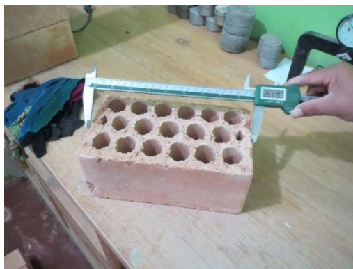
Figura 21: Medición del largo de ladrillo industrial San Juan.
