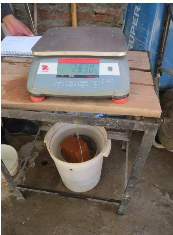
Figura 32: Pesaje espécimen industrial para determinar el volumen en cm 3 .
