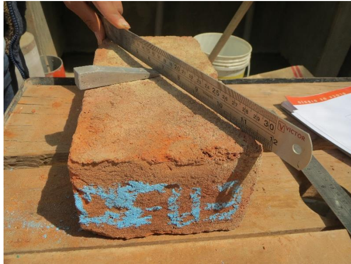
Figura 23: Muestra artesanal ensayada para calcular el alabeo.
