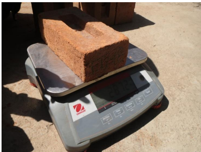
Figura 30: Pesaje de espécimen artesanal en estado natural.
