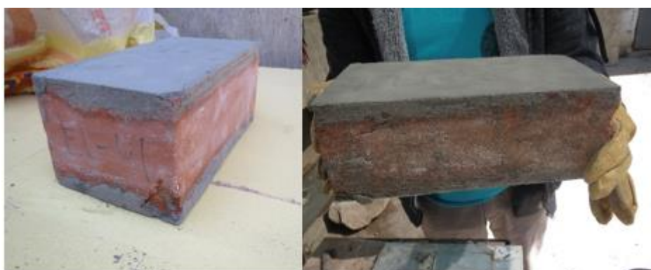
Figura 34: Espécimen industrial a la izquierda y espécimen artesanal a la derecha, ambos capeados con una mezcla de cemento y yeso (diablo fuerte)
