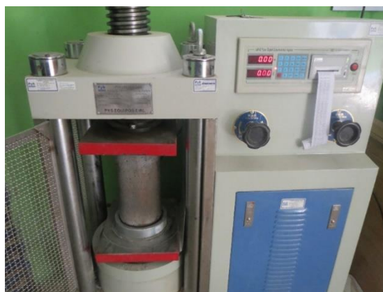
Figura 47: Probeta en la máquina de ensayo a la compresión.
