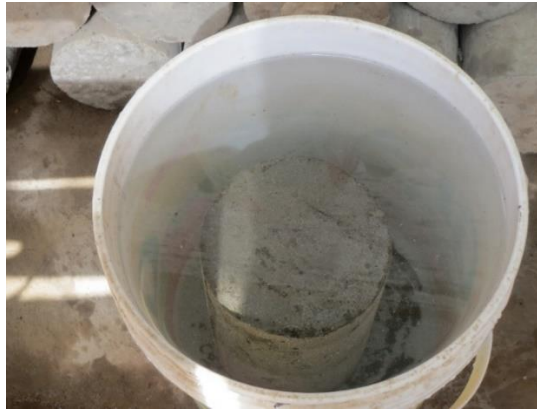
Figura 46: Curado de la probeta por 7 días.
