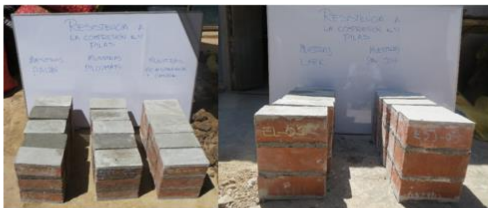
Figura 37: Pilas capeadas con diablo fuerte. Especímenes artesanales a la izquierda e industriales a la derecha.
