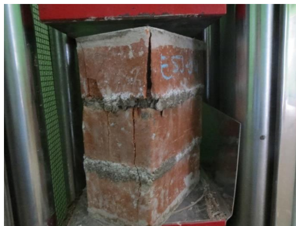
Figura 41: Pila de ladrillos industriales San Juan, se comportan de la misma manera, en la resistencia a la compresión, se genera un agrietamiento vertical, al finalizar el ensayo
