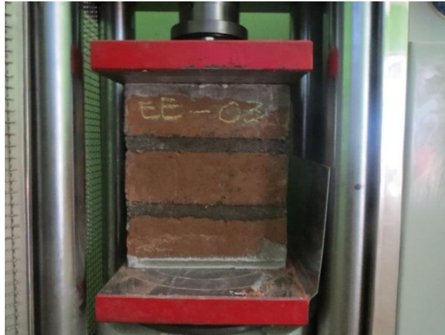
Figura 38: Pila de espécimen artesanal, capeado y en la máquina de compresión.
