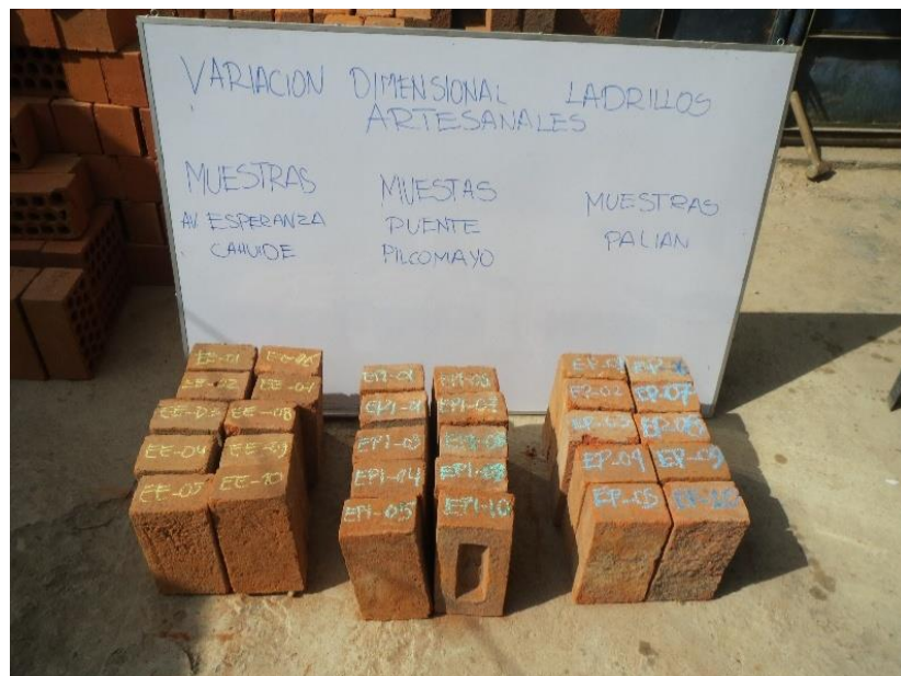
Figura 19: Muestras de ladrillos artesanales ensayados en variación dimensional.
