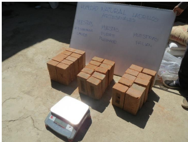
Figura 30: Pesaje de espécimen artesanal en estado natural.
