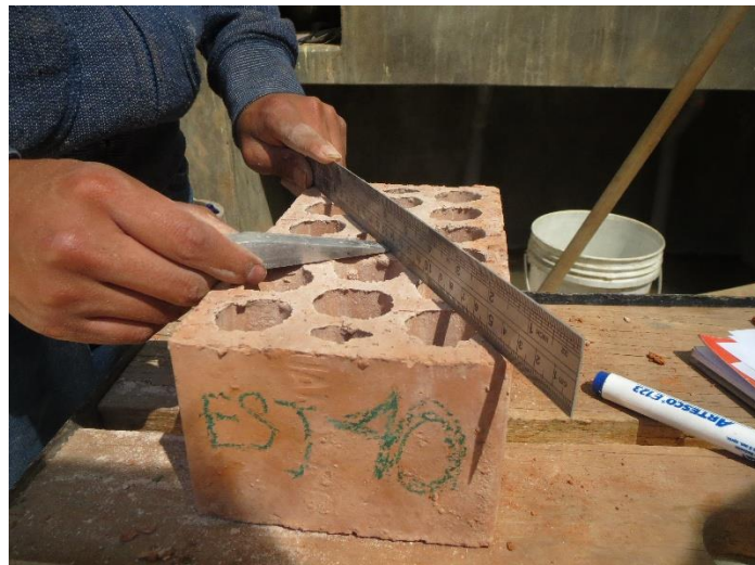
Figura 24: Muestra industrial ensayada para calcular el alabeo.
