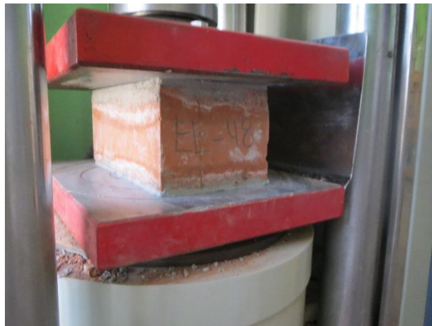
Figura 36: Especímen industrial en la máquina compresora.
