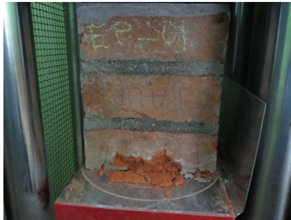
Figura 40: Espécimen artesanal de la feria Palián se observa un aplastamiento en la base, después del ensayo de resistencia a compresión.
