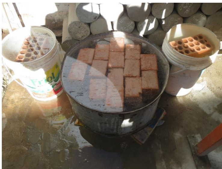
Figura 27: Muestras de ladrillos industriales sumergidos por 24 horas.
