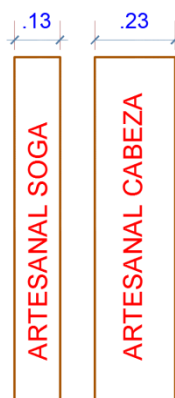
Figura 49: Espesores mínimos en sogá y cabeza
