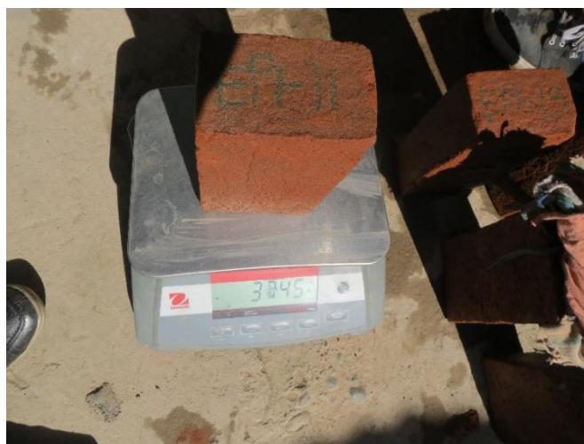
Figura 31: Pesaje de espécimen artesanal saturado superficialmente seco.
