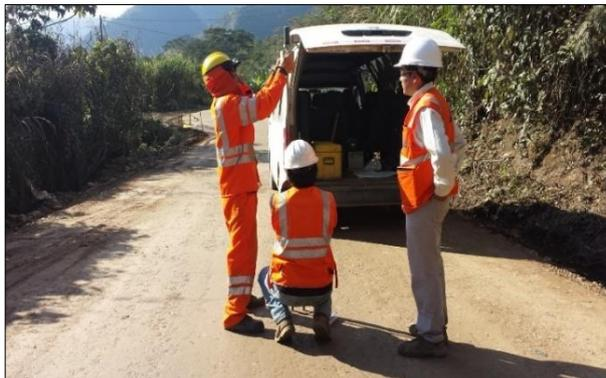
Figura 50. Control de penetración dinámica de cono (PDC)
