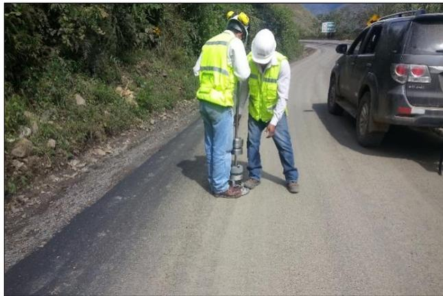
Figura 56. Medición con LWD en la base estabilizada con recubrimiento a los 7 días
