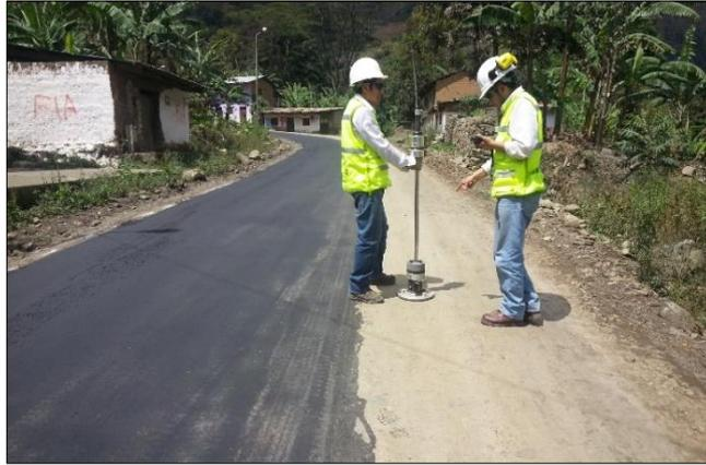
Figura 55. Medición con LWD en la base estabilizada sin recubrimiento a los 7 días
