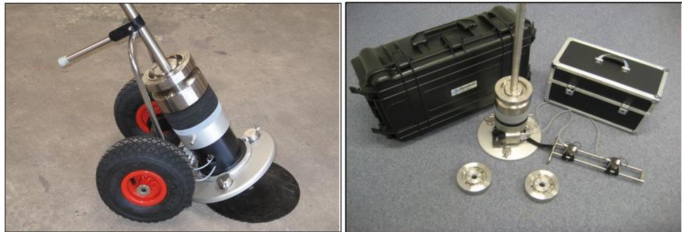
Figura 51. Configuración básica del LWD y elementos opcionales
