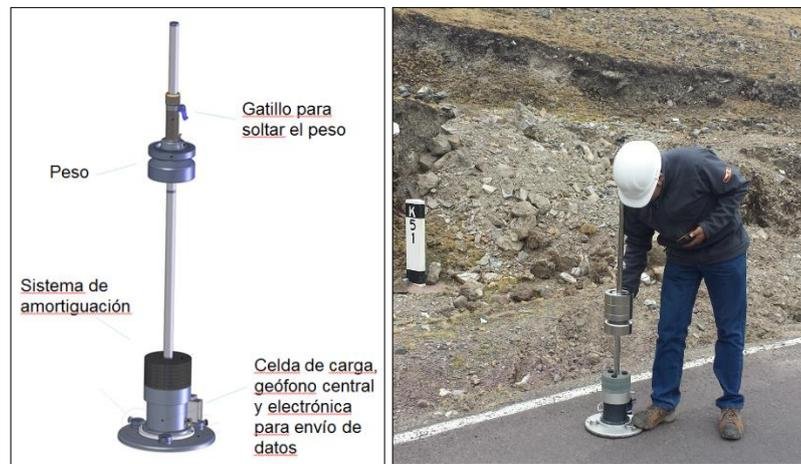
Figura 52. Partes del LWD y operación en terreno
