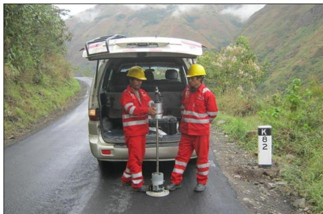
Figura 57. Medición con LWD en la base estabilizada a los 4 meses
