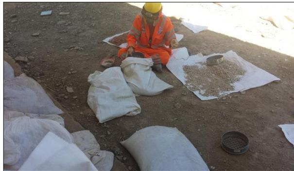
Figura 48. Control de materiales estabilizados en pista
