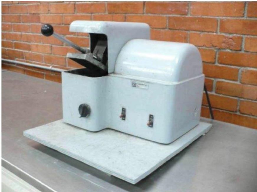
Figura 1.- Cortadora de disco abrasivo
