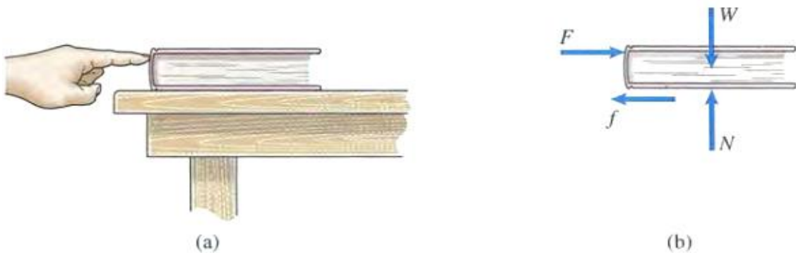
Fig 2. Análisis de fricción (Bedford, 2010)
