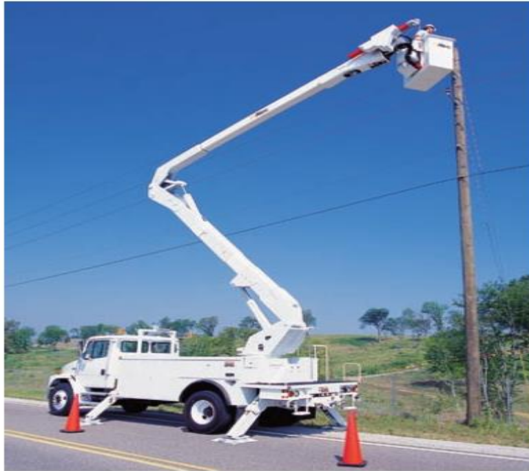
Figura 1. Fuerzas ejercidas por cilindros hidráulicos para posicionar un elevador. Fuente: BEER, R. Mecánica vectorial para ingenieros (2013)
