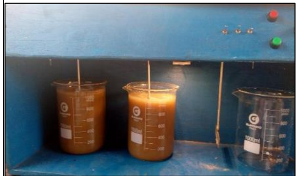
Figura 24. Muestra en el equipo de pruebas de jarras.
