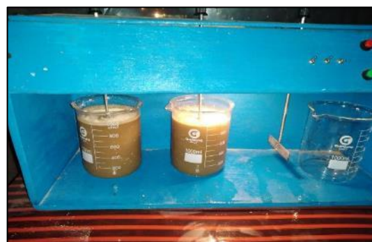
Figura 41. Efluente y tuna molida en equipo de pruebas de jarras.
