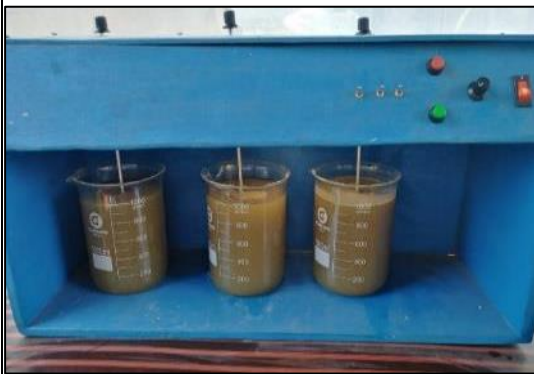
Figura 37. Mezcla de tuna molida en equipo de prueba de jarra.
