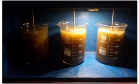
Figura 28. Mezcla de efluente y tuna en equipo de pruebas de jarras.
