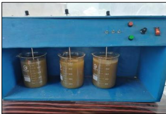
Figura 33. Mezcla de efluente en equipo de pruebas de jarras.
