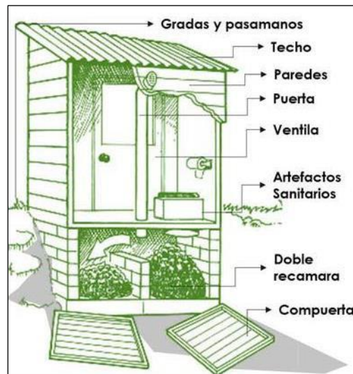
Figura 15. Segmentos de la unidad básica de saneamiento compostera (6)
