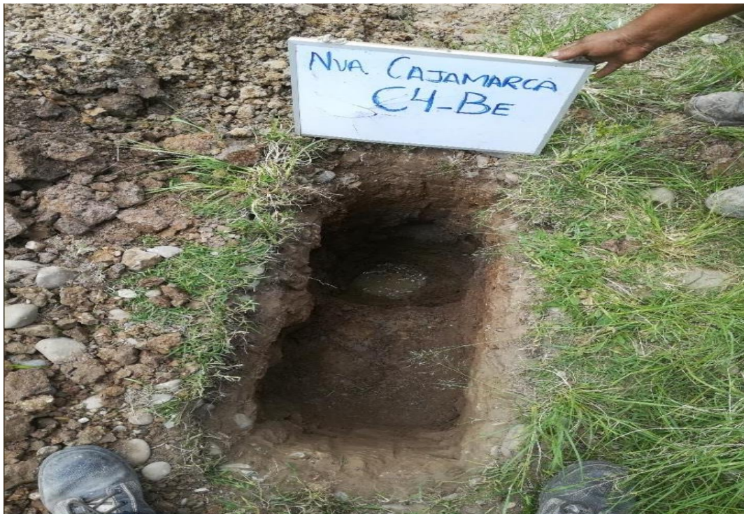
Figura 57. Ensayo de permeabilidad
