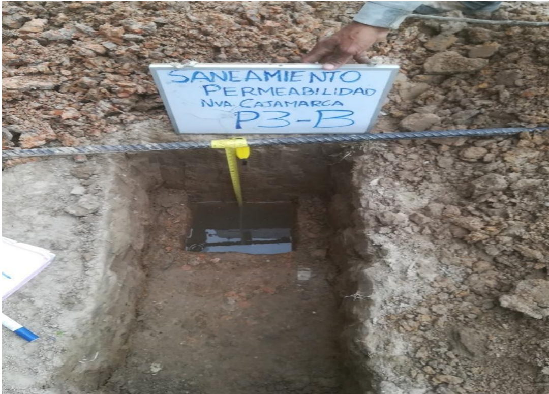
Figura 58. Ensayo de permeabilidad
