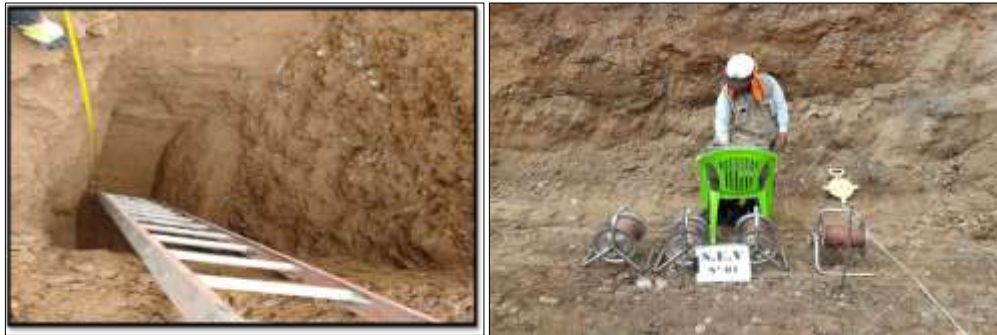
Figura 150: Calicata 01 y SEV (Sondeo eléctrico vertical) 01 para EMS
