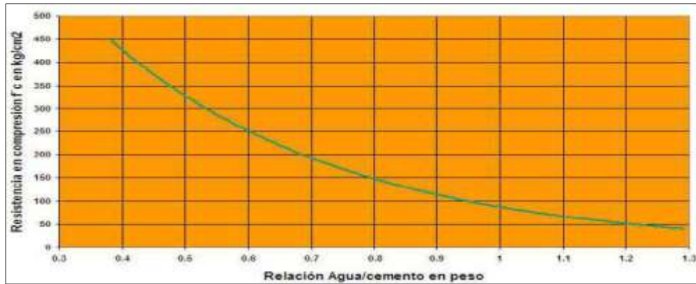
Figura 202: Relación agua-cemento para el concreto lanzado. Fuente: Shotcrete Vía Húmeda (Union de Concreteras S.A., 2014)
