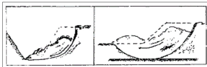
Figura 9: Fallas del talud
