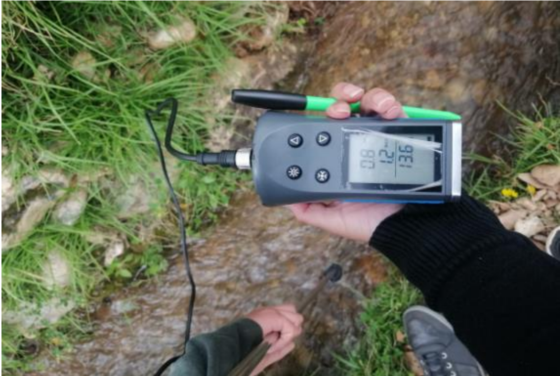
Figura 21. Toma de velocidades en el cuarto canal lateral (sección rectangular)
