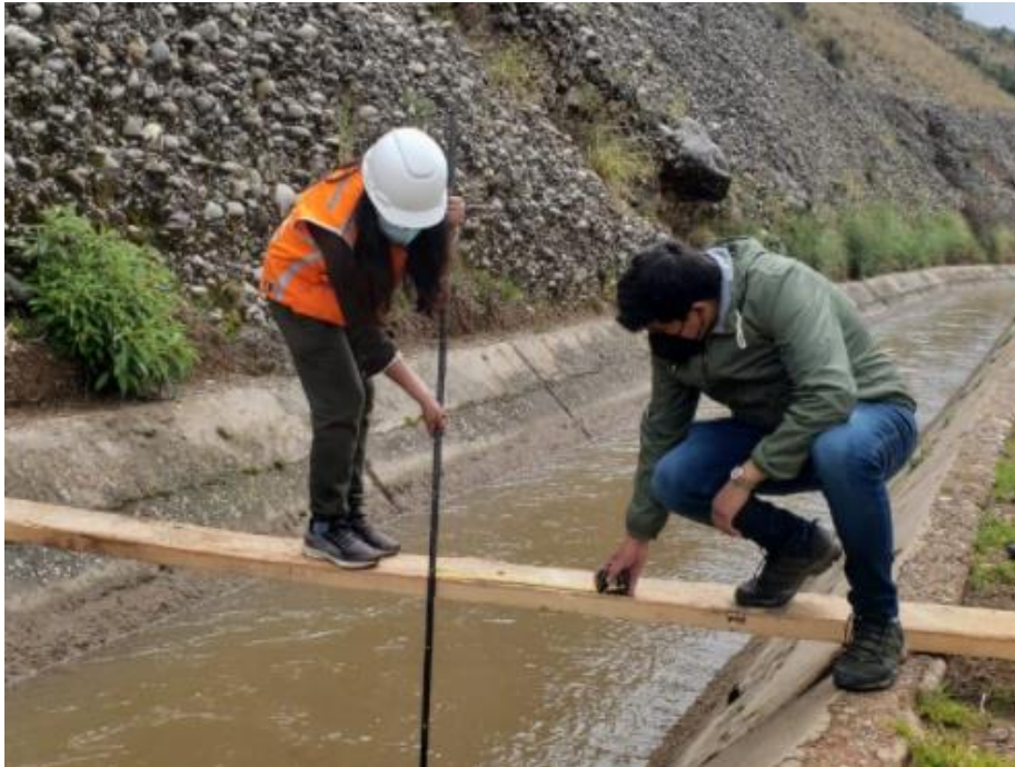
Figura 17. Toma de altura del tirante en la progresiva 0+020 km (canal trapezoidal)
