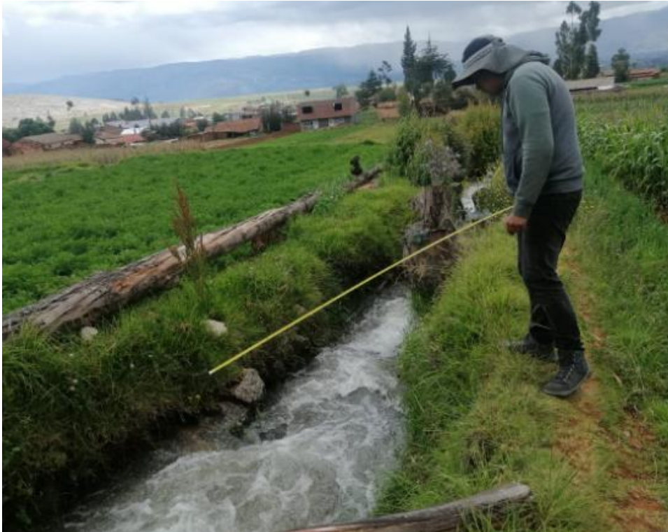
Figura 19. Toma del espejo de agua del segundo canal lateral (sección rectangular)
