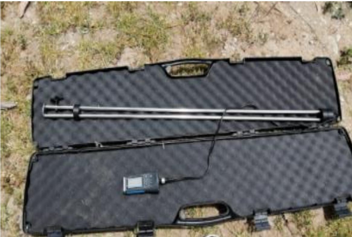
Figura 22. Equipo de medición de velocidades (El correntómetro Global Water FP111)
