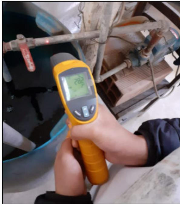
**Ilustración 33.** Toma de temperaturas en diferentes puntos de la torre de enfriamiento
