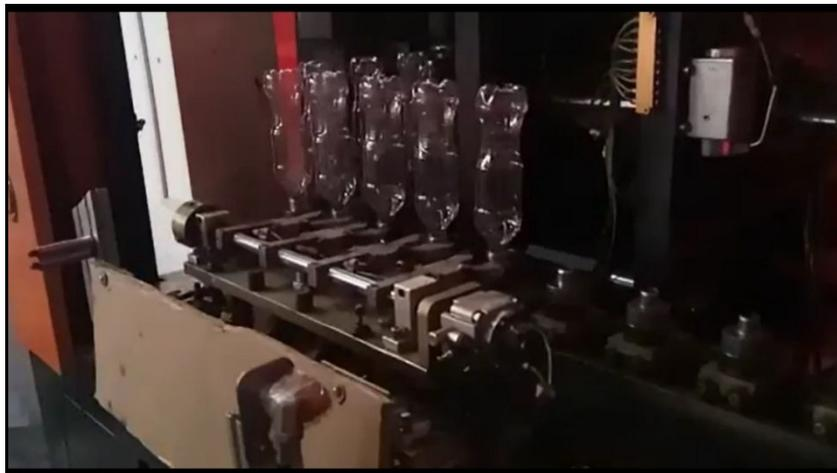
**Ilustración 29.** Sistema de salida de botellas
