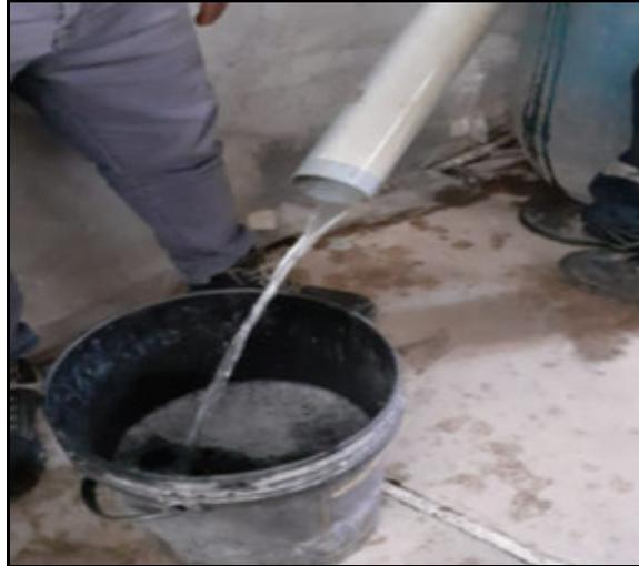
**Ilustración 34.** Medida de caudal en la caída de agua en torre de enfriamiento
