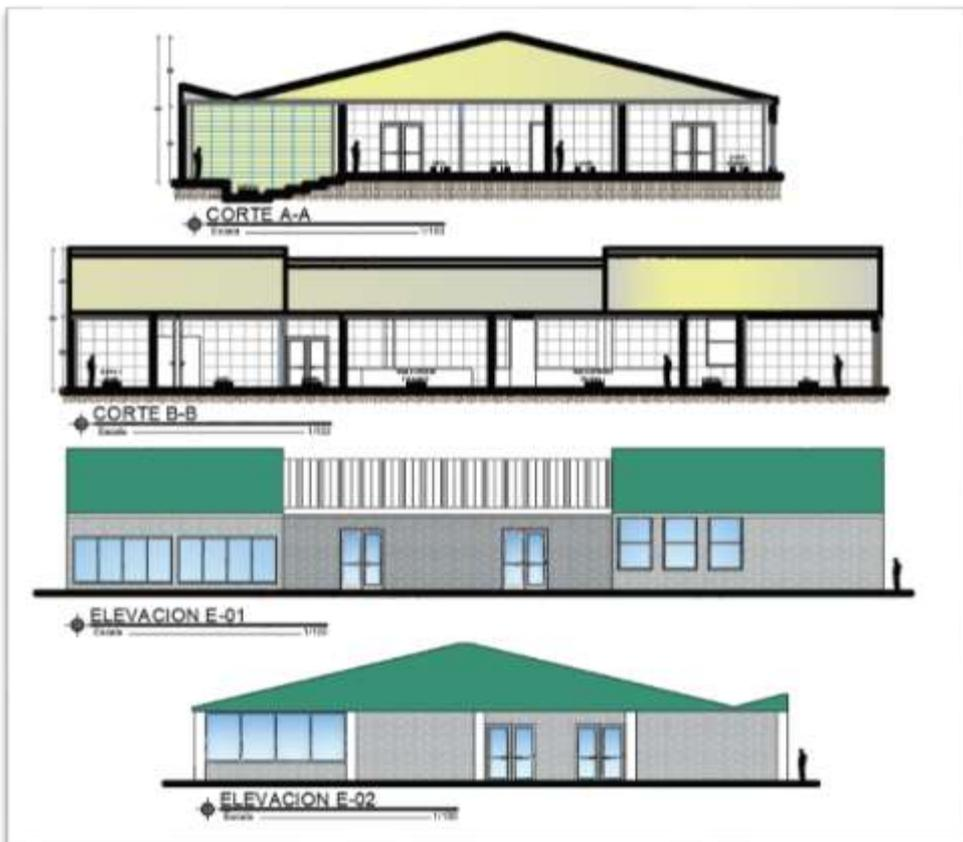
**Figura 47.** Cortes y Elevaciones Area de Exposición.
