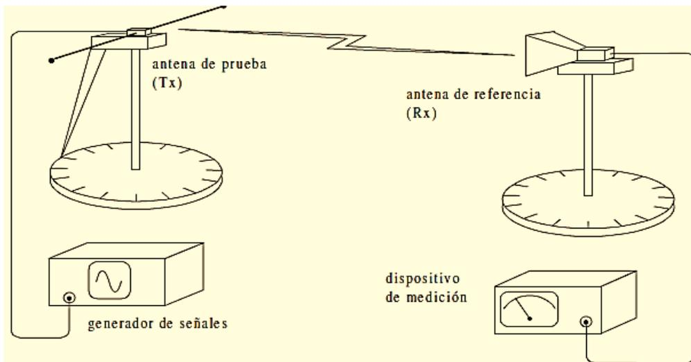
**Figura 5. Disposición de las antenas para obtener los patrones de radiación**
