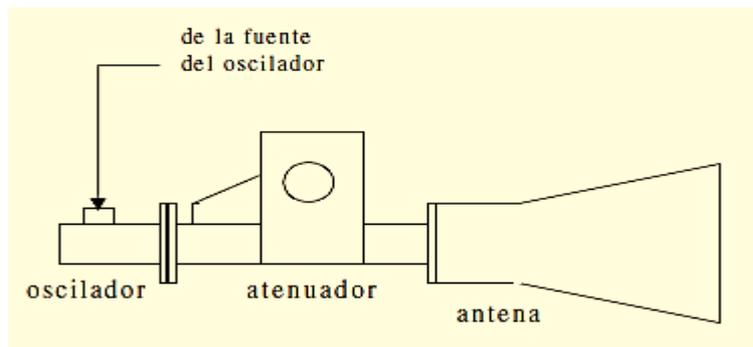
**Figura 6. Conexiones para la antena de corneta en el emisor**
