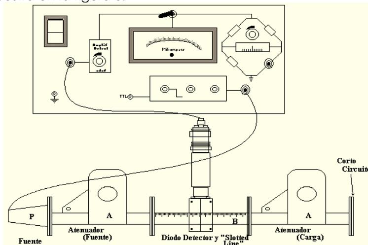
**Figura 3 Mediciones de potencia**
