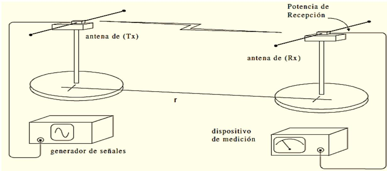
Una vez hecha la medición de la potencia de recepción se medirá la potencia de transmisión directamente a la entrada de la antena transmisora. Es muy importante que esta última medición se efectúe sin modificar los parámetros del generador que se utilizaron para la medición de la potencia de recepción.
