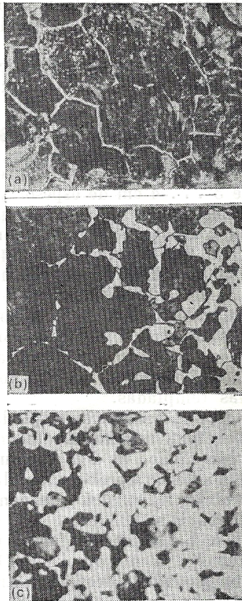
Fig. 54. Microestructura de la capa cementada después del enfriamiento lento, \times 400 : a , perlita y cementita secundaria en forma de red; b , perlita y red ferrítica; c , ferrita y perlita
