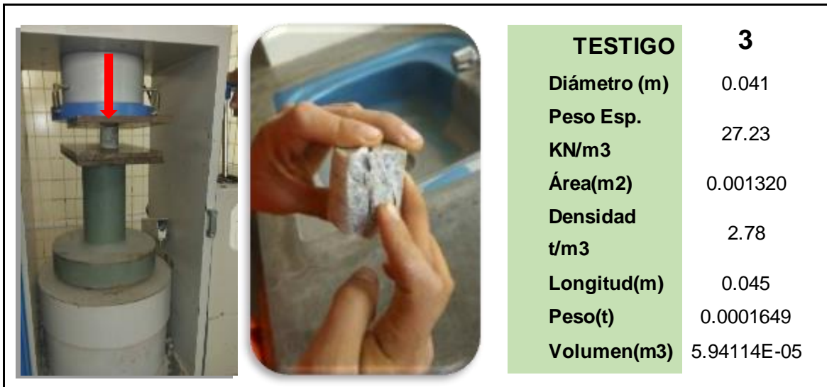
Figure 3-3. Ensayo tipo UCS sobre el testigo número 3
