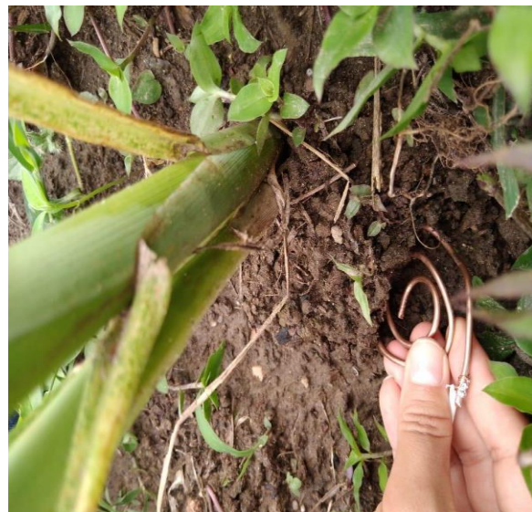
Anexo 10. Colocación del cátodo cerca de la raíz de la planta
