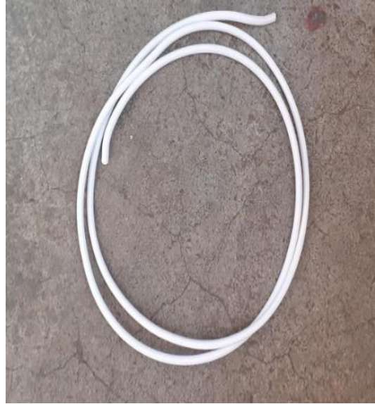
Anexo 6. Cable mellizo 12
