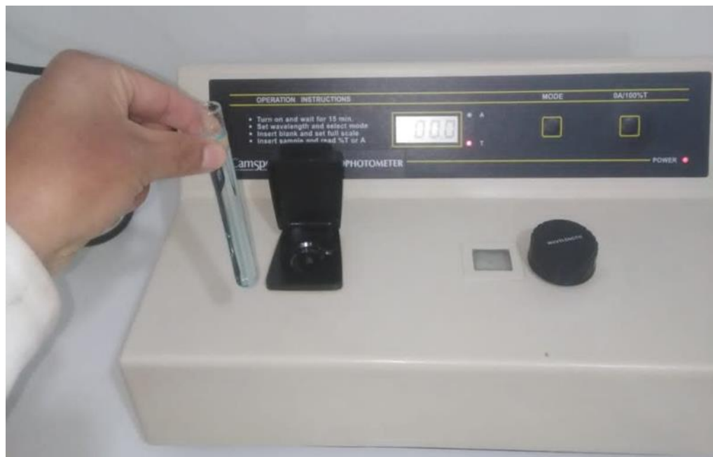
Figura 46. Determinación de fosfatos (método del colorímetro) de la muestra tratada con 58 V, durante 90 minutos, para el cumplimiento del objetivo específico 3.
