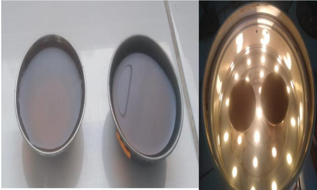
Figura 41. Muestra tomada para la verificación de los sólidos totales, a la izquierda se tiene las muestras antes de ingresar a la estufa y a la derecha dentro de la estufa, para el cumplimiento del objetivo específico 3.
