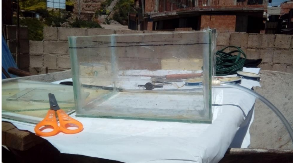
Figura 15. Celda electrolítica de 3 litros.
