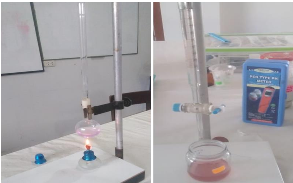
Figura 48. Determinación de materia orgánica (método dicromatometría fosfatos) de la muestra tratada con 58 V, durante 90 minutos, para el cumplimiento del objetivo específico 3.
