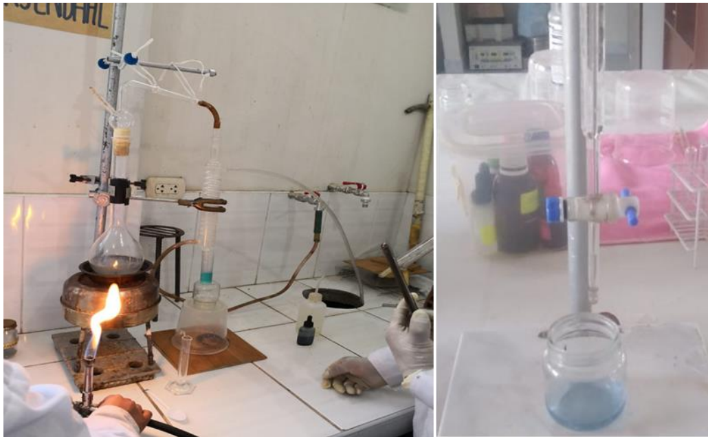
Figura 47. Determinación del nitrógeno total (método Kjeldahl) de la muestra tratada con 58 V, durante 90 minutos para, el cumplimiento del objetivo específico 3.
