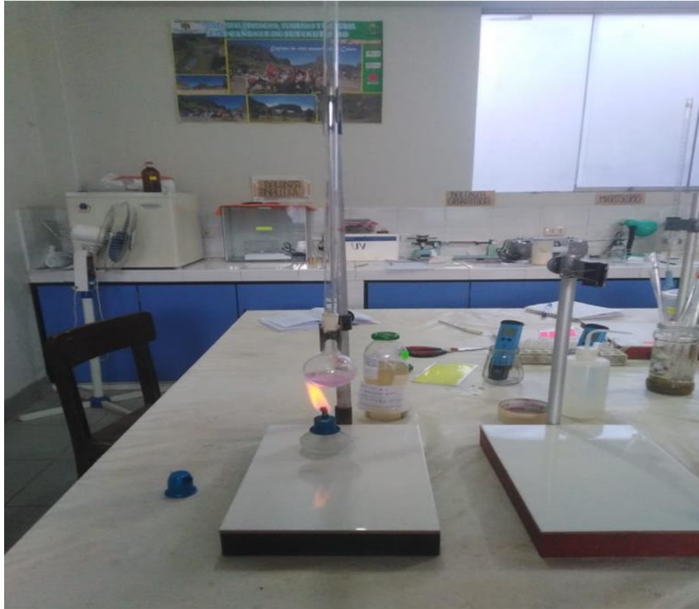
Figura 45. Determinación de la demanda química de oxígeno de la muestra tratada con 58 V, durante 90 minutos, para el cumplimiento del objetivo específico 3.
