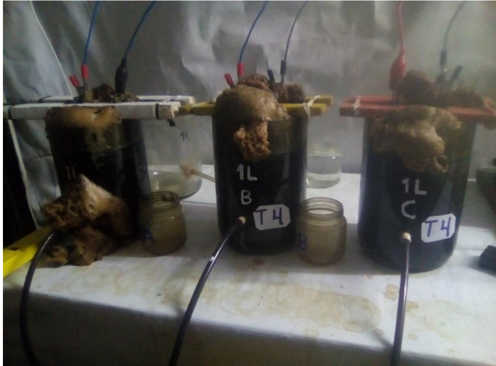
Figura 39. Muestra en proceso de tratamiento para el objetivo 2, durante 60 minutos, sometido a 70,8V.
