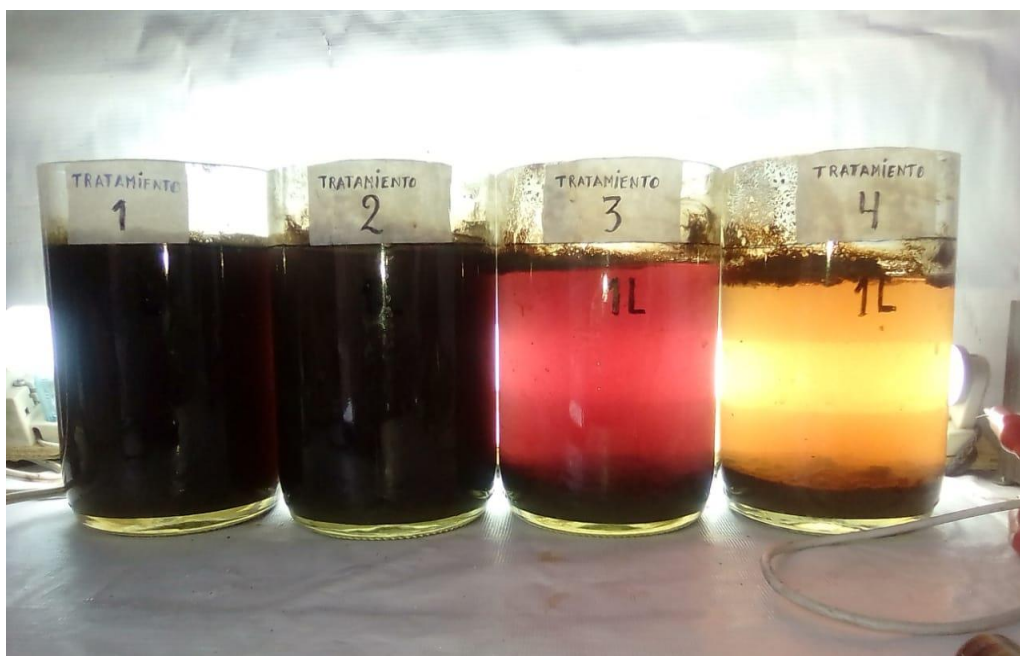
Figura 50. Muestras tratadas a diferentes tensiones, vistas a través de la luz para un tiempo de 30 minutos.
