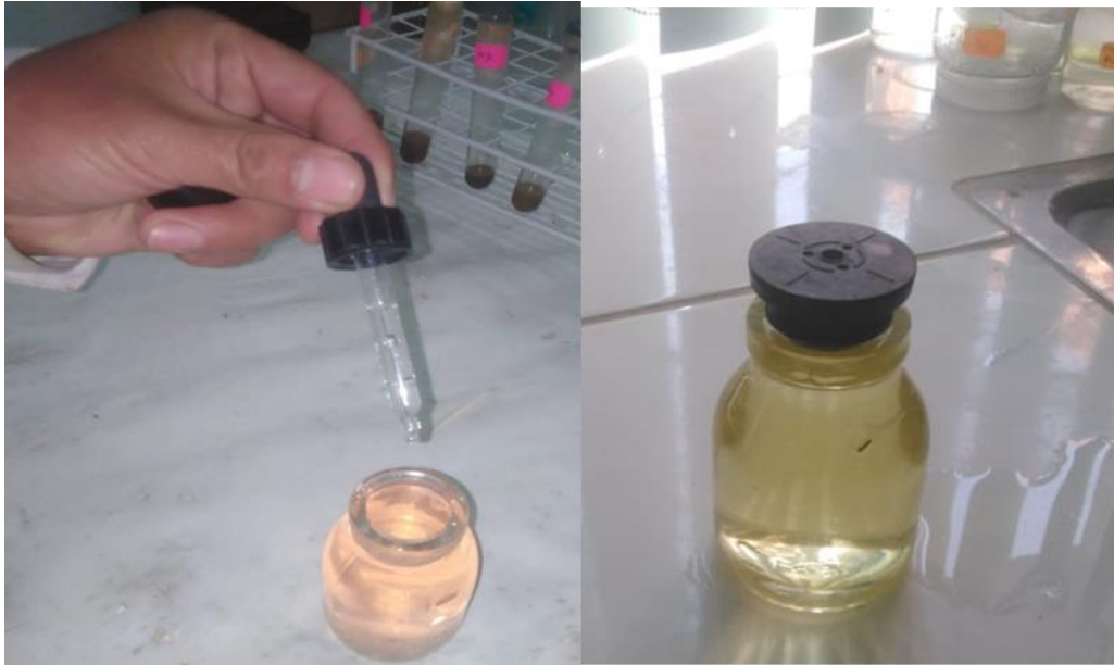
Figura 43. Proceso de fijación del oxígeno (método Winkler) en muestra de agua tratada con 58V, durante 90 minutos, para el cumplimiento del objetivo específico 3.
