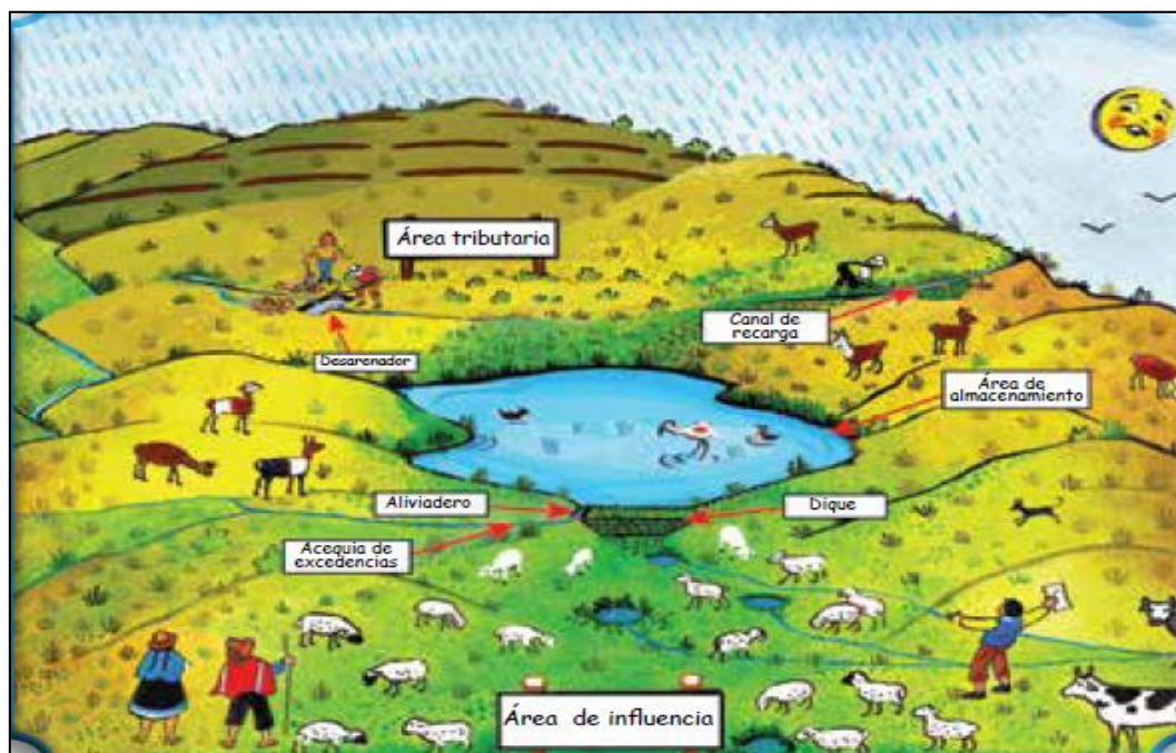
Figura 24. Diseño del aliviadero y de la acequia excedente. Fuente FONCODES Siembra y cosecha de Agua. Disponible en https://www.iproga.org.pe/descarga/guia_s_cosecha.pdf
