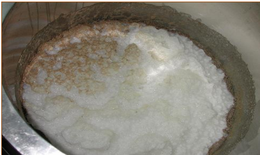
Figura 9. El espumeo por la generación de CO 2 dentro del fermentador
