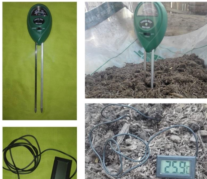
Figura 7. Equipos para tomar temperatura, pH y humedad del abono tipo Bocashi.
