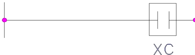
Figura 22. Ubicación extrema de banco de condensadores en una LT Fuente: Elaboración propia
