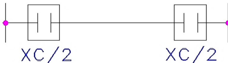
Figura 23. Ubicaciones extremas de banco de condensadores en una LT Fuente: Elaboración propia
