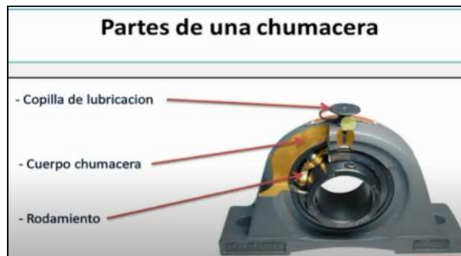
Figura 13. Partes de una chumacera Fuente: https://www.youtube.com/watch?v=nGJQ5jw2QrU
