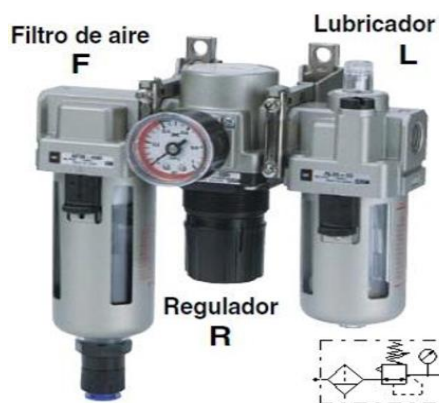
Figura 45. Unidad de mantenimiento Tomado de Alejandro Buenache, 2010
