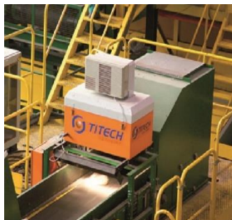
Figura 19. Escáner óptico Tomado de Reocup, 2016
