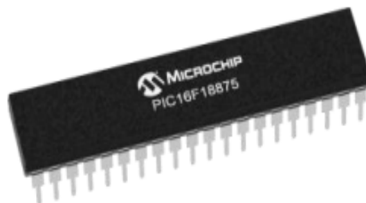
Figura 15. Microcontrolador PIC16F18875 Tomado de Jesús Torres, 2018
