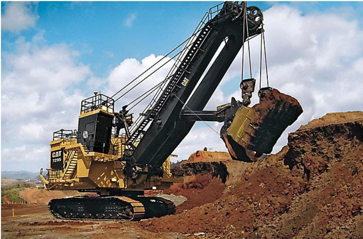
Figura 6. Pala eléctrica Caterpillar, modelo 7295. Tomado de Caterpillar website
