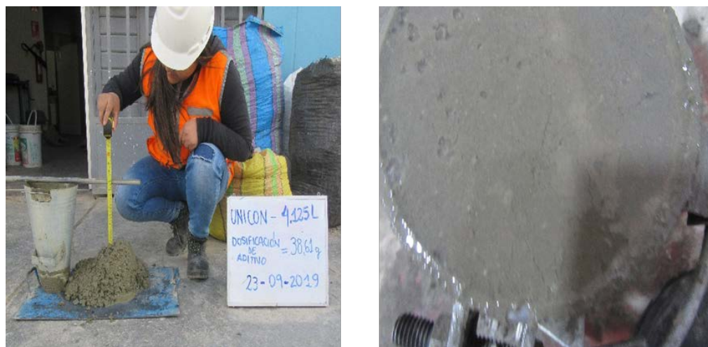
Figura 148. Dosis de aditivo de 200 ml (38.61 g) representada por la mezcla, el asentamiento y probeta que evidencia una ligera exudación (Unicon).
