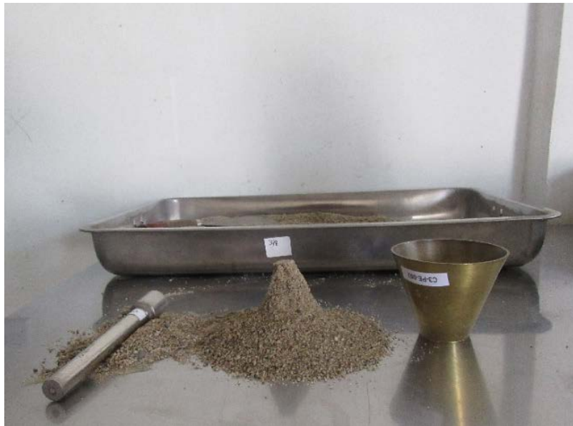
Figura 18. Prueba de humedad superficial por el ensayo provisional del cono.
