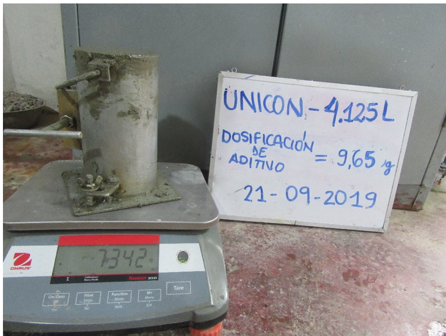
Figura 96. Especímen cilíndrico posterior a su elaboración, para determinar el peso unitario.
