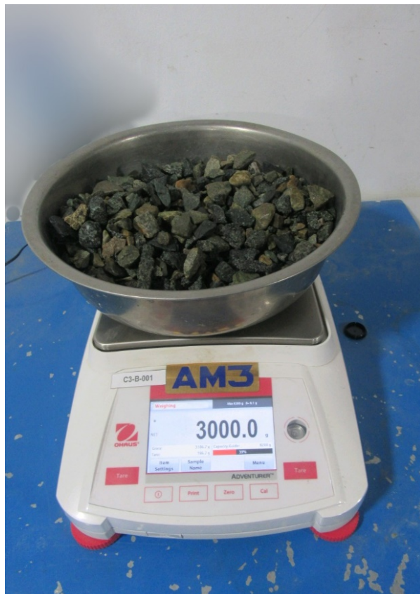
Figura 15. Balanza con la muestra superficialmente seca.
