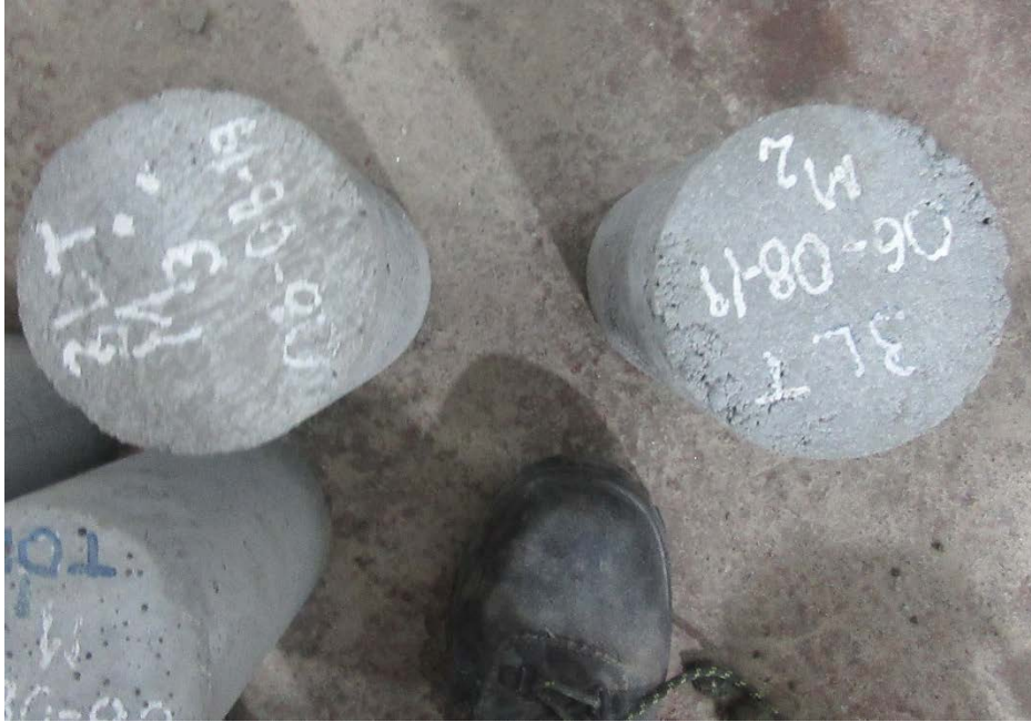
Fotografía 13: Probetas de concreto de dosificación 3 litros de agua previos al ensayo a la compresión.
