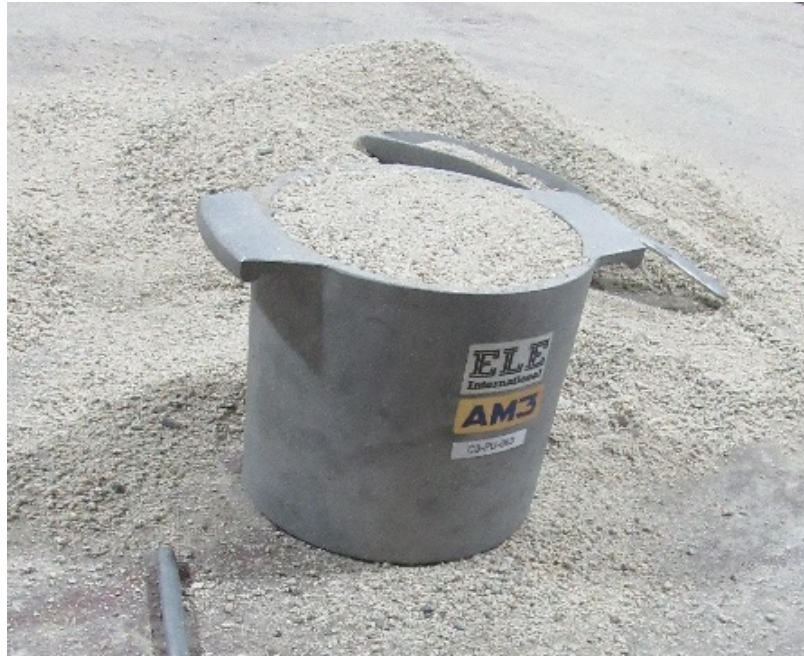
Figura 39. Balde con muestra de agregado fino después del apisonado en tres capas.
