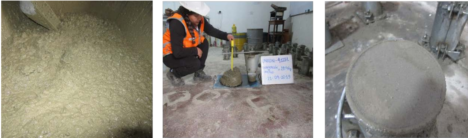
Figura 149. Dosis de aditivo de 150 ml (28.96 g) representada por la mezcla, el asentamiento y probeta que evidencia una ligera exudación (Unicon).
