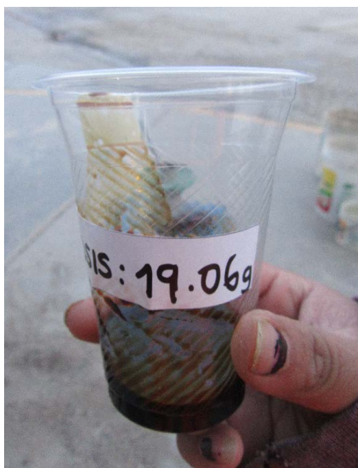
Figura 86. Aditivo Sika Cem con la dosis exacta.
