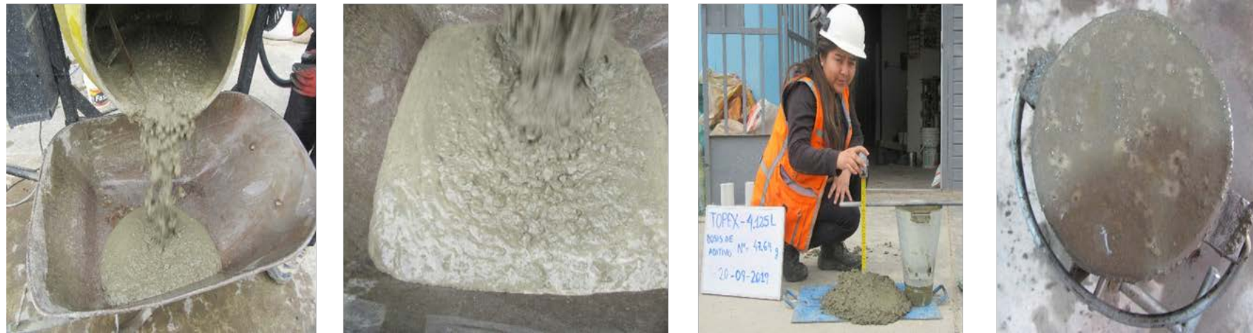
Figura 141. Dosis de aditivo de 250 ml (47.64 g) representada por la mezcla, el asentamiento y la probeta elaborada que evidencia exudación y segregación de materiales Topex.
