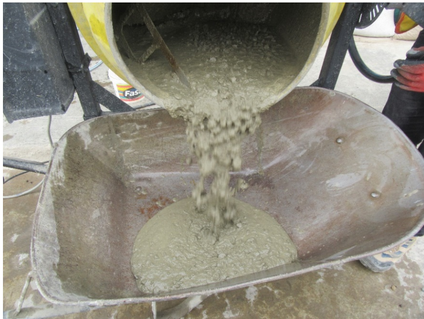
Figura 90. Mezcla vertida en la carretilla para proceder al muestreo.
