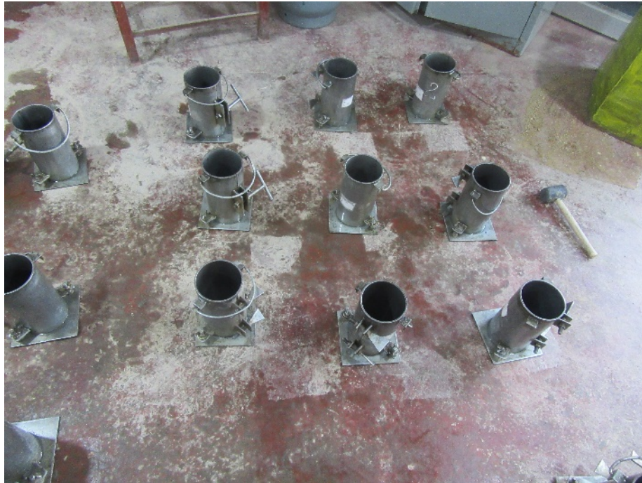
Figura 98. Habilitación de moldes con la aplicación de desmoldante.
