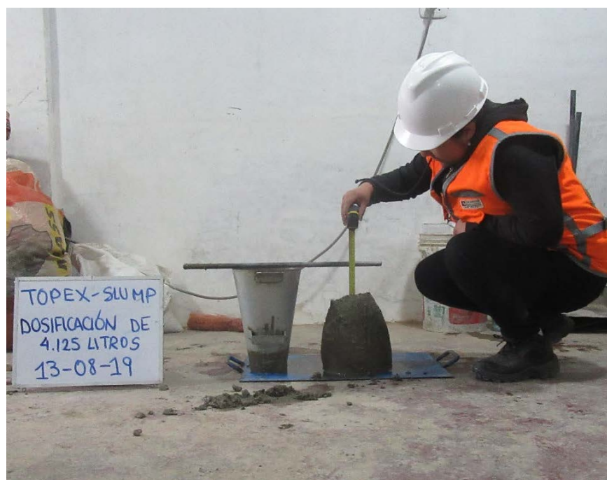
Figura 64. Medida de la consistencia de una mezcla de concreto para la marca Topex
