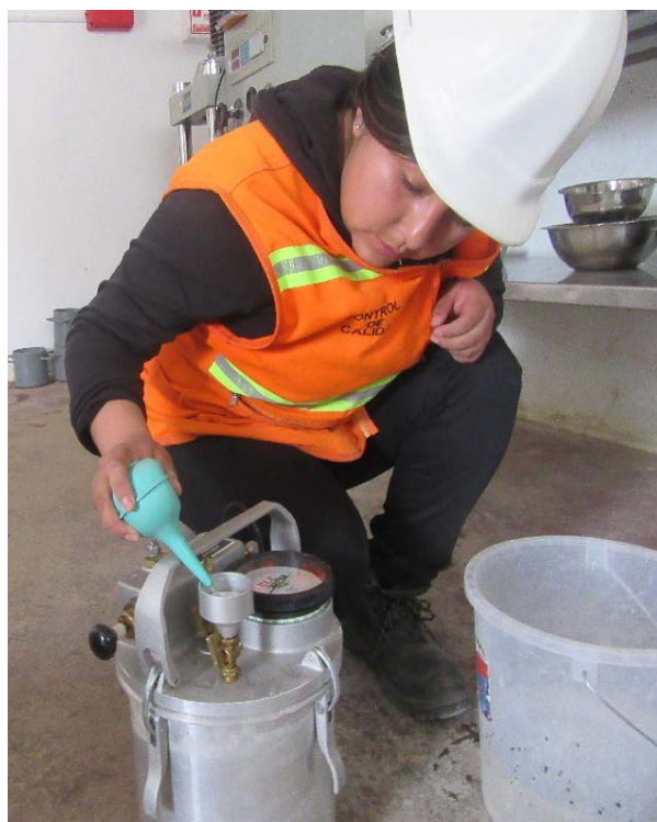
Figura 114. Llenado de agua usando la pera de succión.
