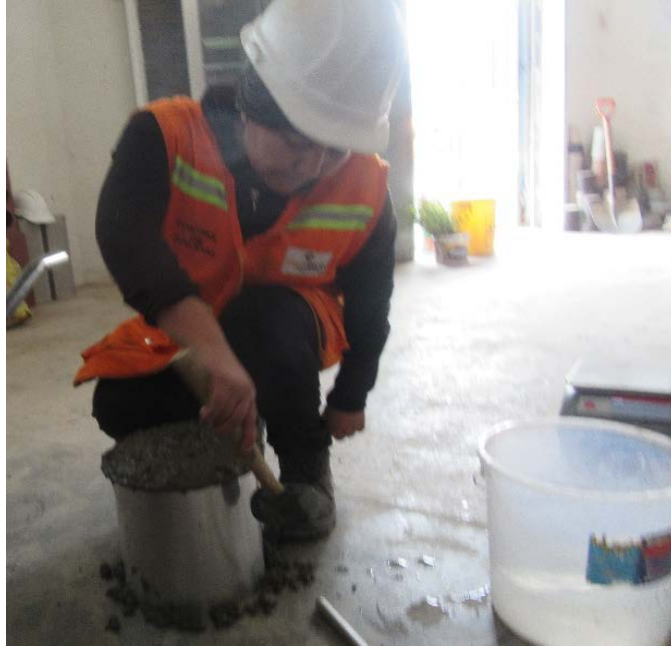
Figura 107. Uso del mazo de goma con los 12 golpes en los bordes del recipiente en la última capa de colocado de concreto.
