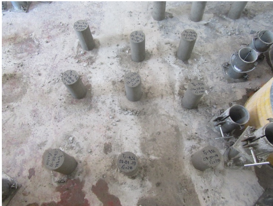
Figura 71. Especímenes después de ser desmoldadas.
