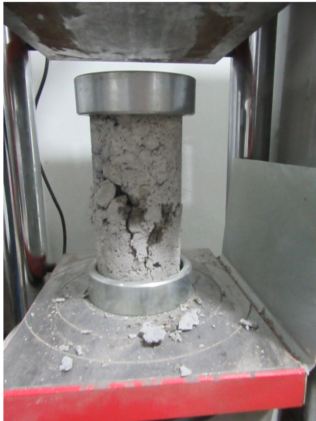
Fotografía 14: Ensayo a la resistencia a la compresión de la probeta de dosificación 3 litros de agua.
