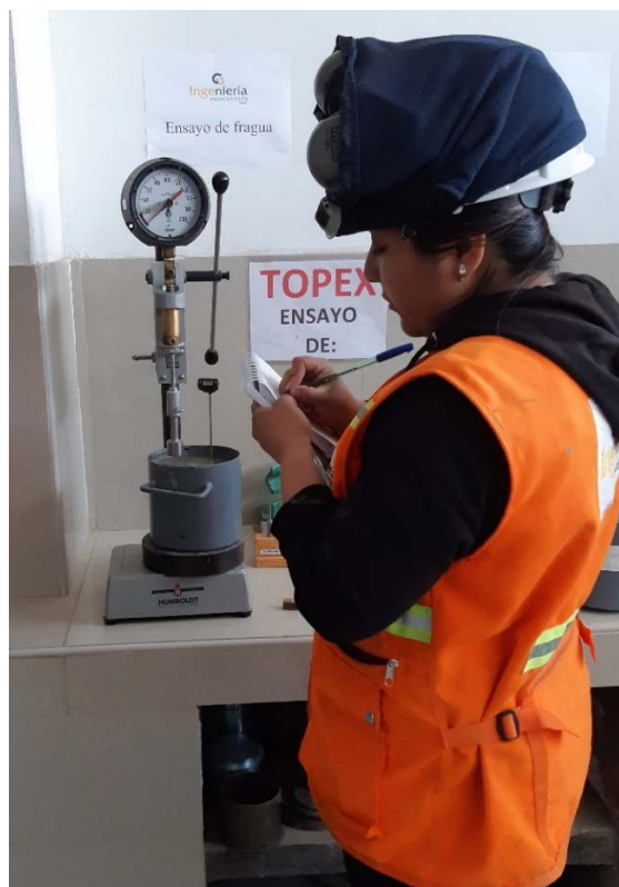
Fotografía 55: Ensayo del tiempo de fragua del embolsado Topex.
