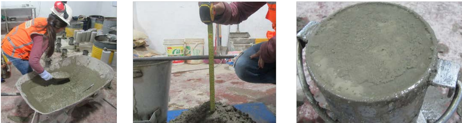
Figura 139. Dosis de agua de 4.75 litros representado por la mezcla, asentamiento, segregación y exudación del concreto Unicon.
