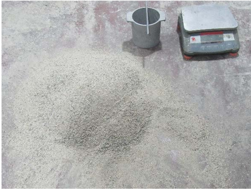
Figura 34. Homogenización de la muestra para iniciar el ensayo del agregado fino. Fuente: elaboración propia.
