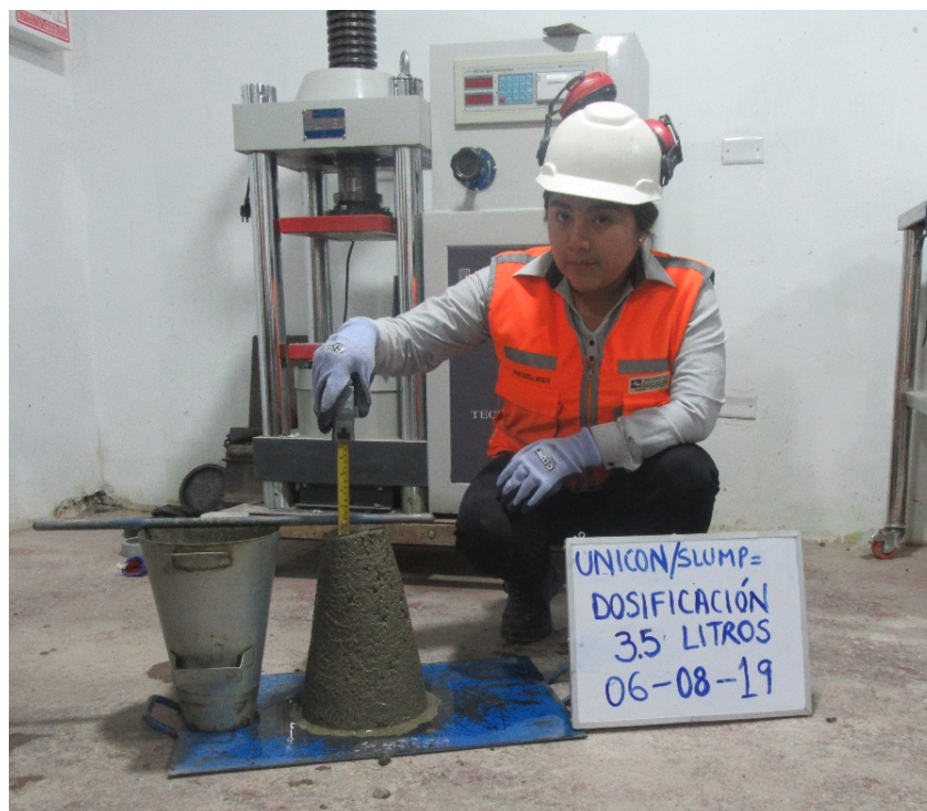
Figura 63. Medida de la consistencia de una mezcla con poca cantidad de agua para la marca Unicon.
