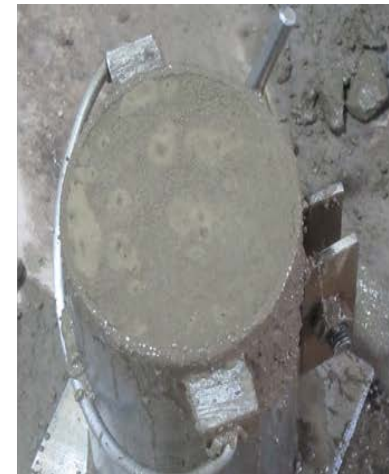
Figura 134. Dosis de agua de 4.75 litros representado por la mezcla, asentamiento, segregación y exudación del concreto Topex.
