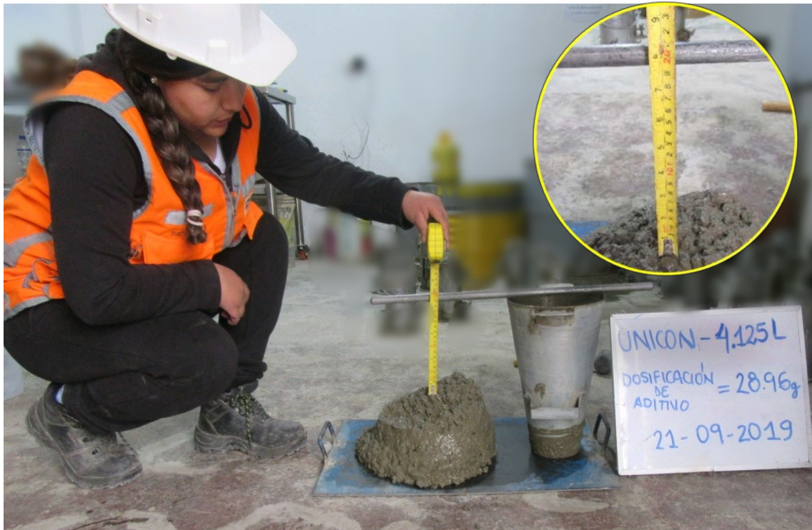
Fotografía 47: Control de asentamiento 7 3/4" de slump de dosificación de 28.96g de aditivo Sika Cem Plastificante del embolsado Unicon.
