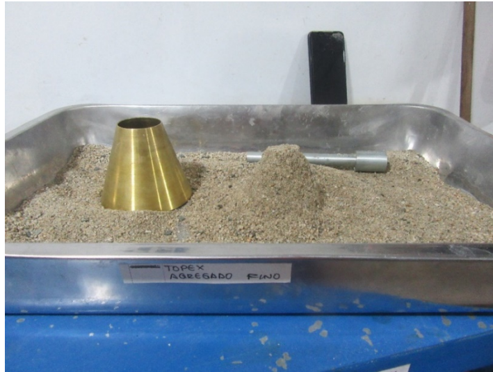
Figura 26. Prueba de humedad superficial por el método del cono para el ensayo de absorción.
