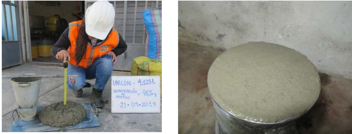
Figura 147. Dosis de aditivo de 250 ml (48.26 g) representada por la mezcla, el asentamiento y probeta que evidencia una ligera exudación (Unicon).
