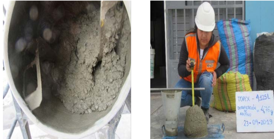
Figura 146. Dosis de aditivo de 25 ml (4.76 g) representada por la mezcla y el asentamiento (Topex).
