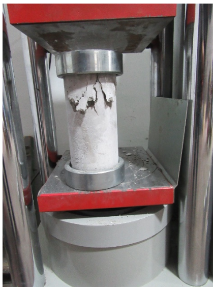
Figura 104. Espécimen cilíndrico de concreto después de ser ensayado.
