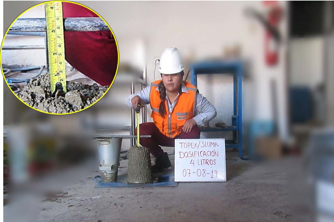
Fotografía 17: Control de asentamiento 3" de slump de dosificación de 4.00 litros de agua del embolsado Topex.
