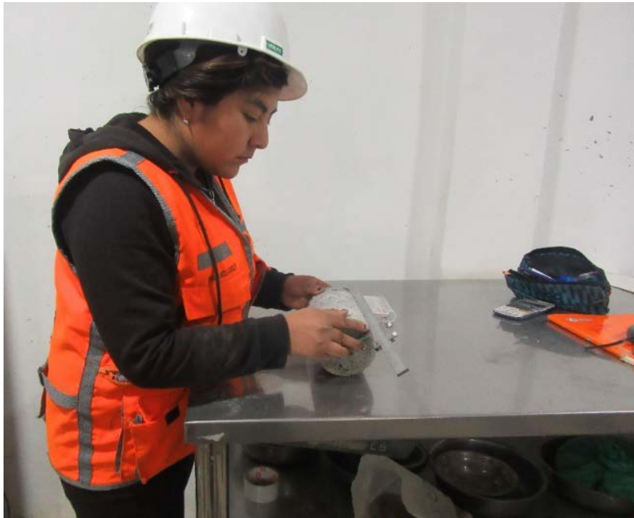
Figura 103. Determinación de medidas de altura y diámetros de los especímenes de concreto elaborados con aditivos.
