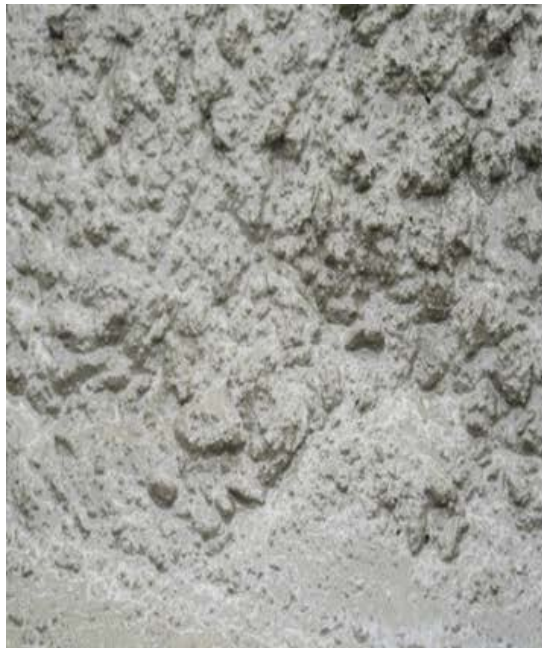
Figura 143. Dosis de aditivo de 150 ml (28.58 g) representada por la mezcla, asentamiento y probeta que evidencia exudación y segregación de materiales (Topex).
