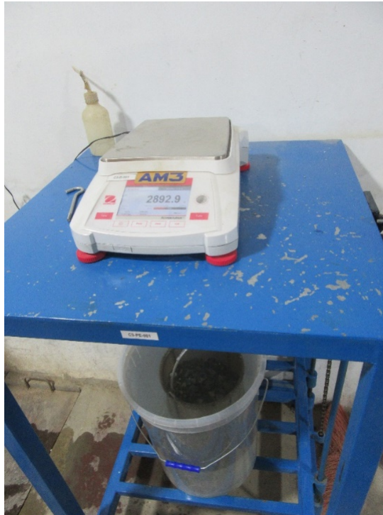
Figura 23. Determinación de la masa aparente del agregado en el agua.
