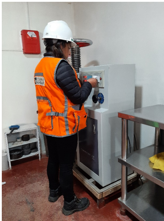
Figura 78. Realizando el ensayo de resistencia a la compresión
