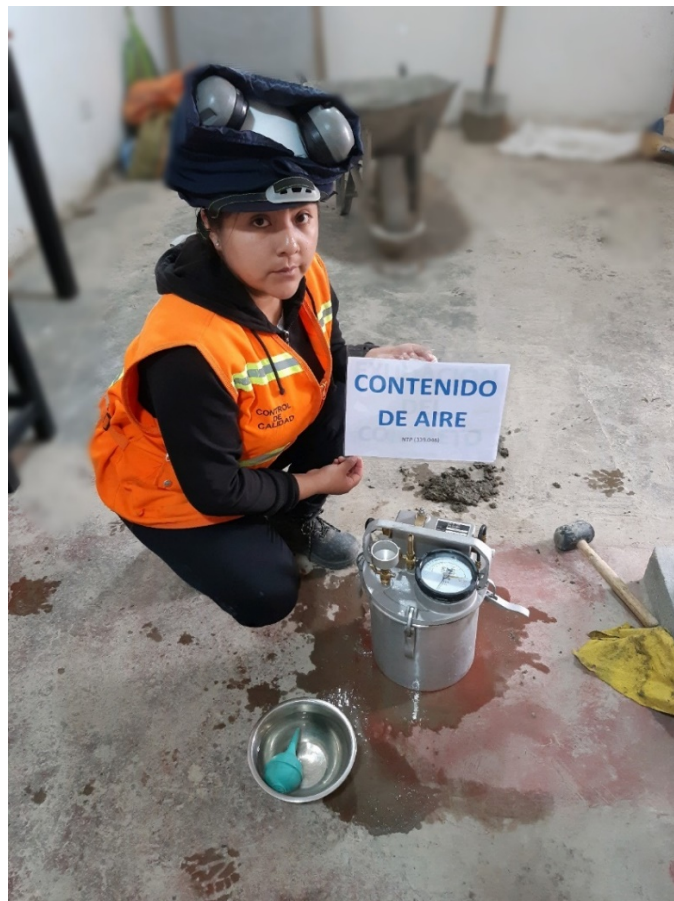
Fotografía 54: Ensayo de contenido de aire del concreto.
