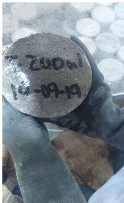
Figura 102. Probeta retirada de la poza de curado para realizar el ensayo de resistencia a la compresión.
