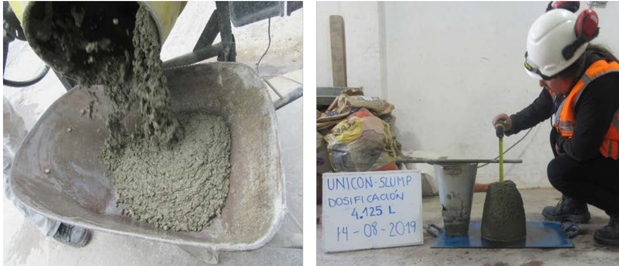
Figura 137. Proceso de mezclado y asentamiento para la dosificación de agua de 4.125 litros Unicon.
