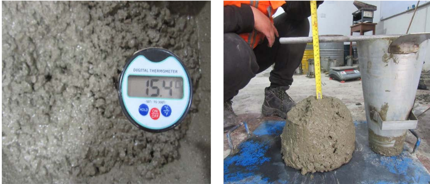
Figura 150. Dosis de aditivo de 100 ml (19.30 g) representada por la mezcla y el asentamiento (Unicon).
