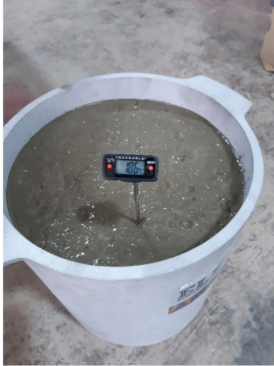
Figura 124. Determinación de la temperatura en el ensayo de exudación del concreto.
