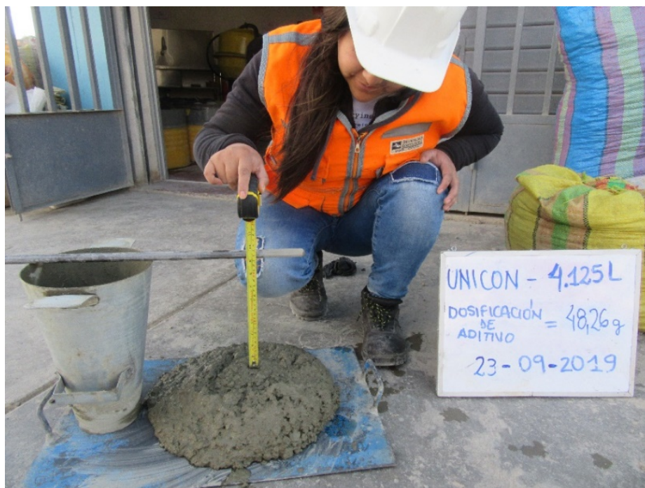
Figura 93. Controlando el asentamiento del concreto haciendo uso del aditivo en función a la dosis de 48.26 g.
