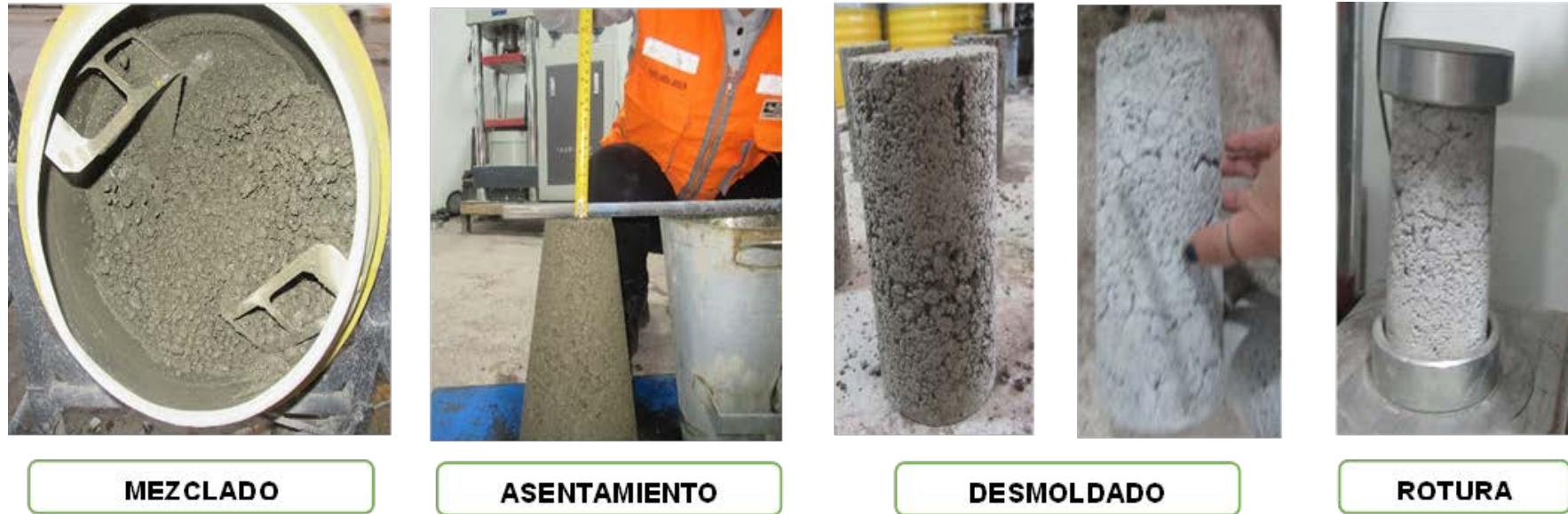
Figura 136. Proceso de elaboración hasta rotura de probetas dosificación de agua de 3 litros Unicon.
