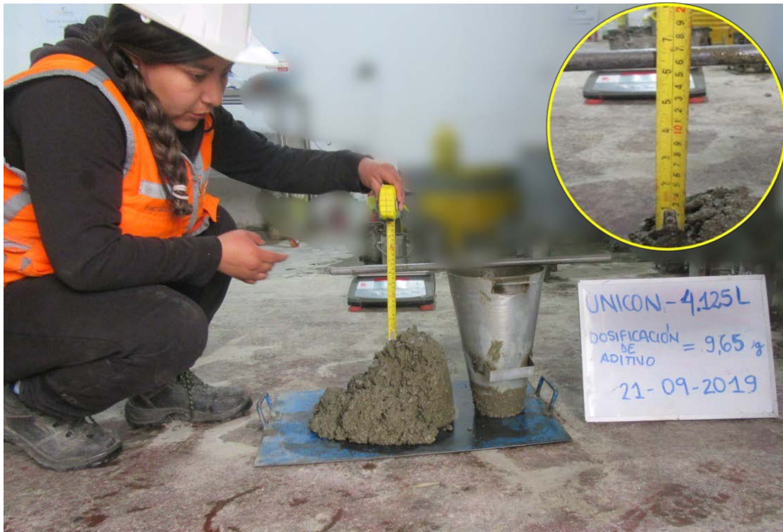
Fotografía 45: Control de asentamiento 6" de slump de dosificación de 9.65g de aditivo Sika Cem Plastificante del embolsado Unicon.
