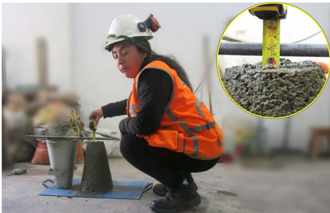
Fotografía 25: Control de asentamiento 3/4'' de slump de dosificación de 3.75 litros de agua del embolsado Unicon.
