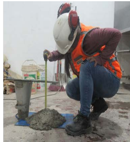
Figura 134. Dosis de agua de 4.75 litros representado por la mezcla, asentamiento, segregación y exudación del concreto Topex.
