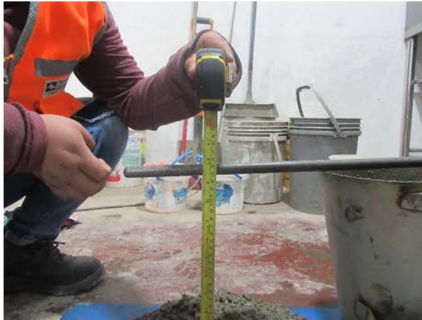
Figura 140. Dosis de agua de 5 litros representada por el asentamiento y la probeta elaborada que evidencia exudación y segregación de materiales Unicon
