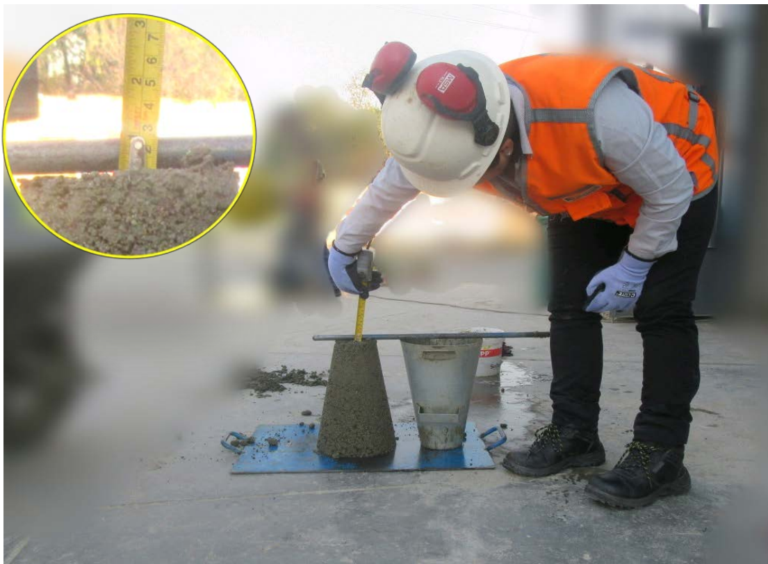
Fotografía 10: Control de asentamiento \frac{1}{4} " de slump de dosificación de 3 litros de agua del embolsado Topex.
