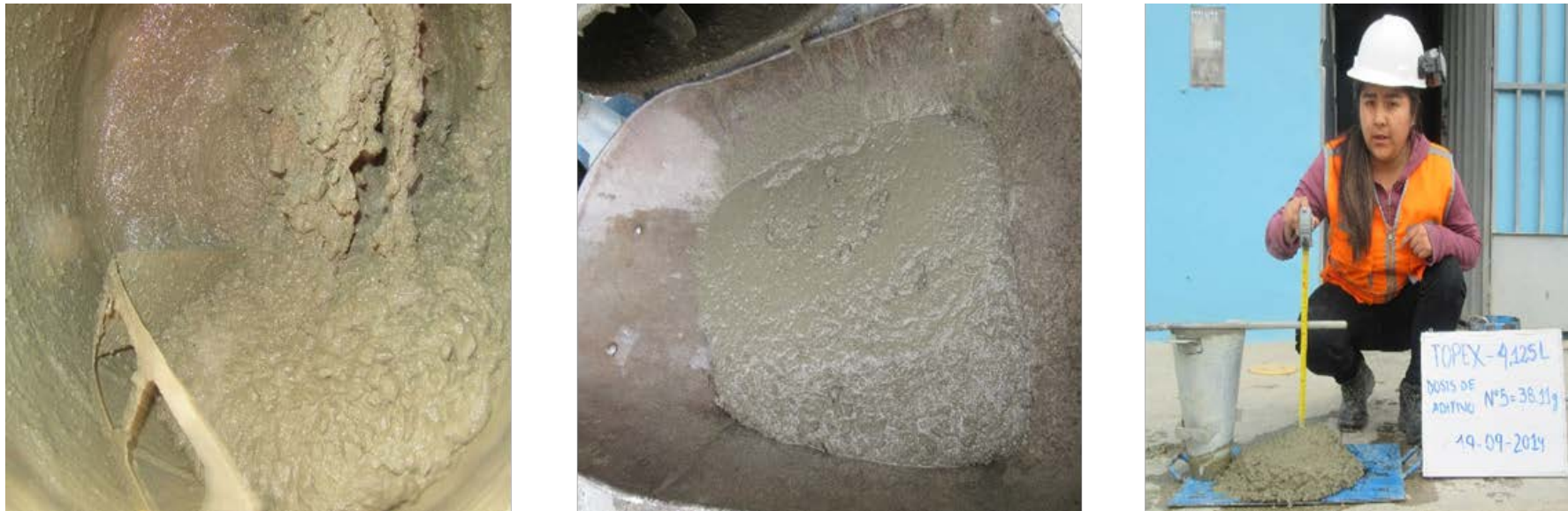
Figura 142. Dosis de aditivo de 200 ml (38.11 g) representada por la mezcla y el asentamiento que evidencia exudación y segregación de materiales (Topex).
