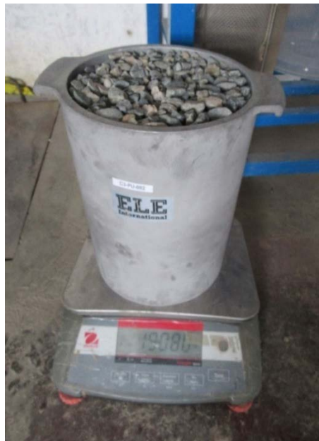
Figura 37. Determinación de la masa del recipiente y contenido del agregado grueso en el ensayo de masa por unidad de volumen suelto.
