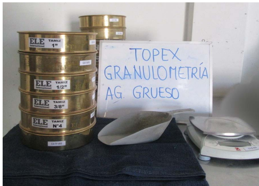
Figura 10. Aparatos usados para realizar el ensayo de análisis granulométrico.
