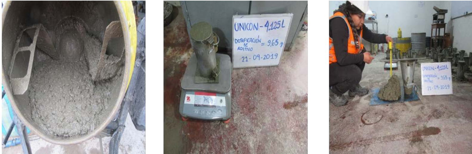
Figura 151. Dosis de aditivo de 50 ml (9.65 g) representada por la mezcla, el asentamiento y probeta que evidencia una ligera exudación (Unicon).
