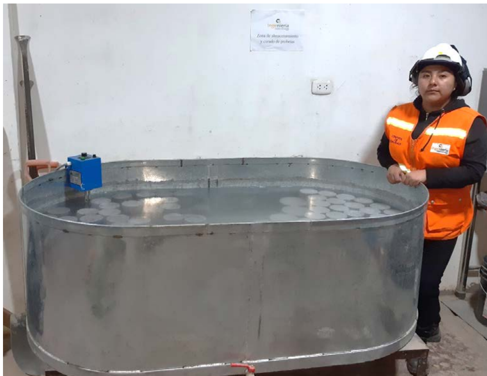
Fotografía 35: Poza de curado donde se almacenaron los especímenes de concreto.
