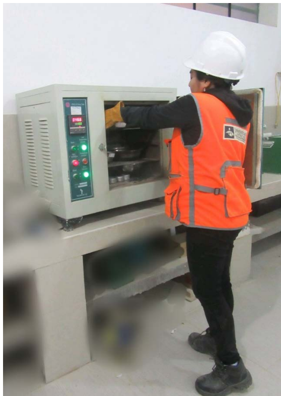
Fotografía 4: Extracción de muestras después de realizar el ensayo de humedad
