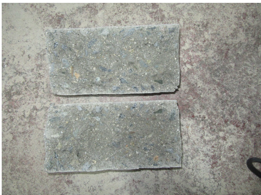
Figura 82. Distribución interna de los componentes del concreto posterior al ensayo a la compresión diametral.
