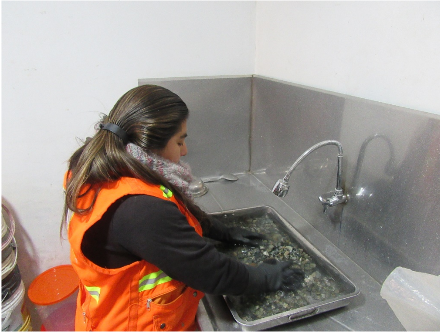
Fotografía 1: Lavado de agregados provenientes de una bolsa de 40 kg.
