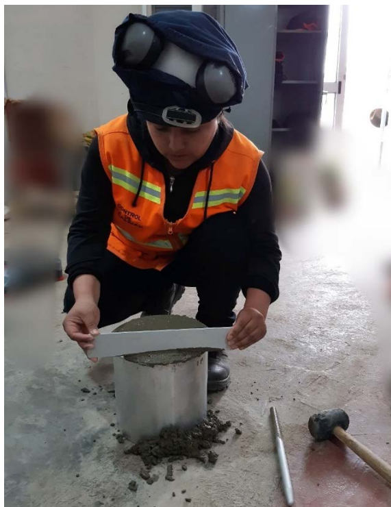
Figura 108. Enrazado con la placa plana ubicando los 2/3 de la superficie del borde superior del recipiente.
