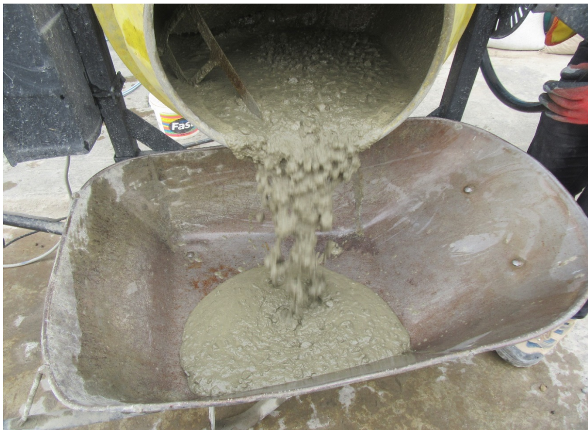
Fotografía 50: Elaboración de concreto con aditivo para realizar los ensayos del concreto en estado fresco.
