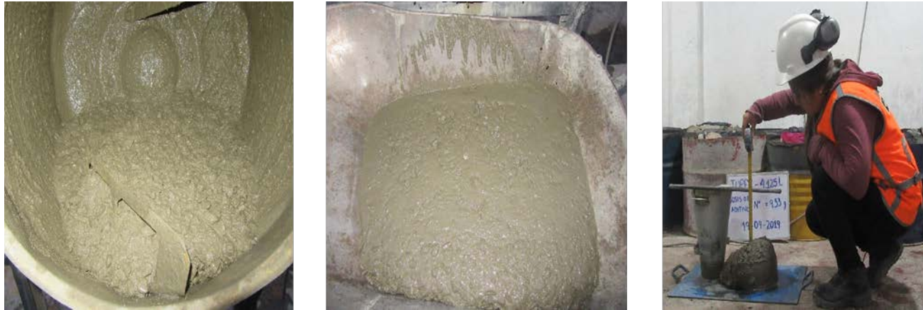
Figura 145. Dosis de aditivo de 50 ml (9.52 g) representada por la mezcla, el asentamiento y probeta que evidencia una ligera exudación (Topex).
