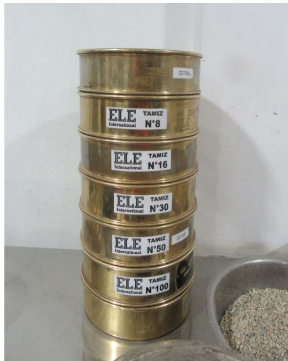
Figura 09. Juego de tamices utilizados para realizar el ensayo de granulometría del agregado fino.
