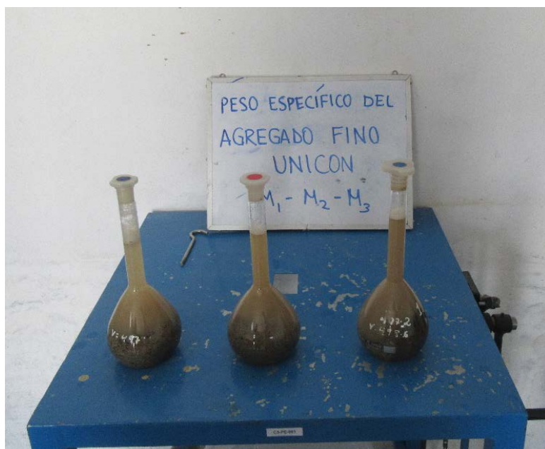
Figura 19. Muestras del proceso gravimétrico mediante el picnómetro.
