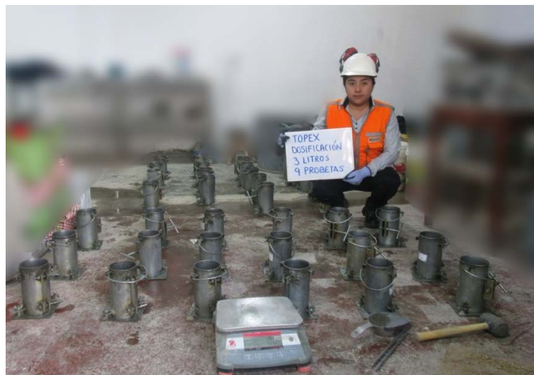
Figura 67. Habilitación de moldes para realizar el ensayo.
