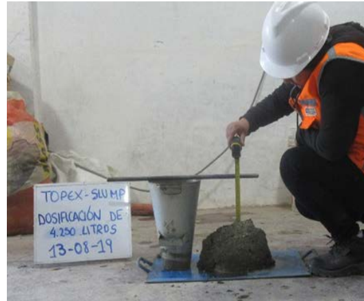
Figura 133. Dosis de agua de 4.5 litros representado por el asentamiento y exudación del concreto en una probeta Topex.
