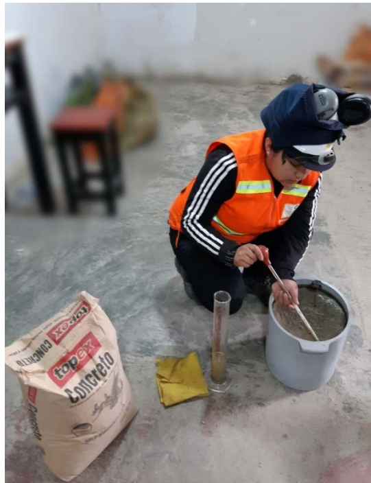
Figura 125. Extracción del agua del recipiente cilíndrico en la probeta graduada.
