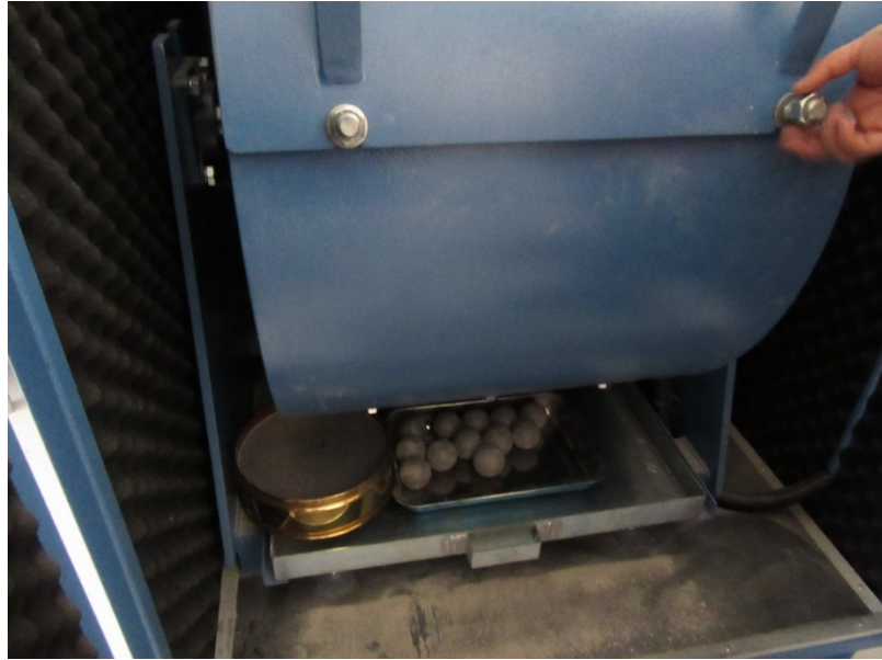
Figura 44. Materiales para realizar el ensayo de abrasión, tamiz, esferas metálicas, máquina de abrasión Los Ángeles.
