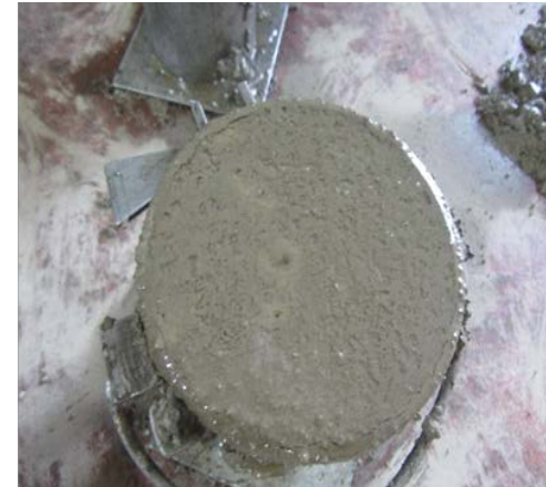
Figura 133. Dosis de agua de 4.5 litros representado por el asentamiento y exudación del concreto en una probeta Topex.
