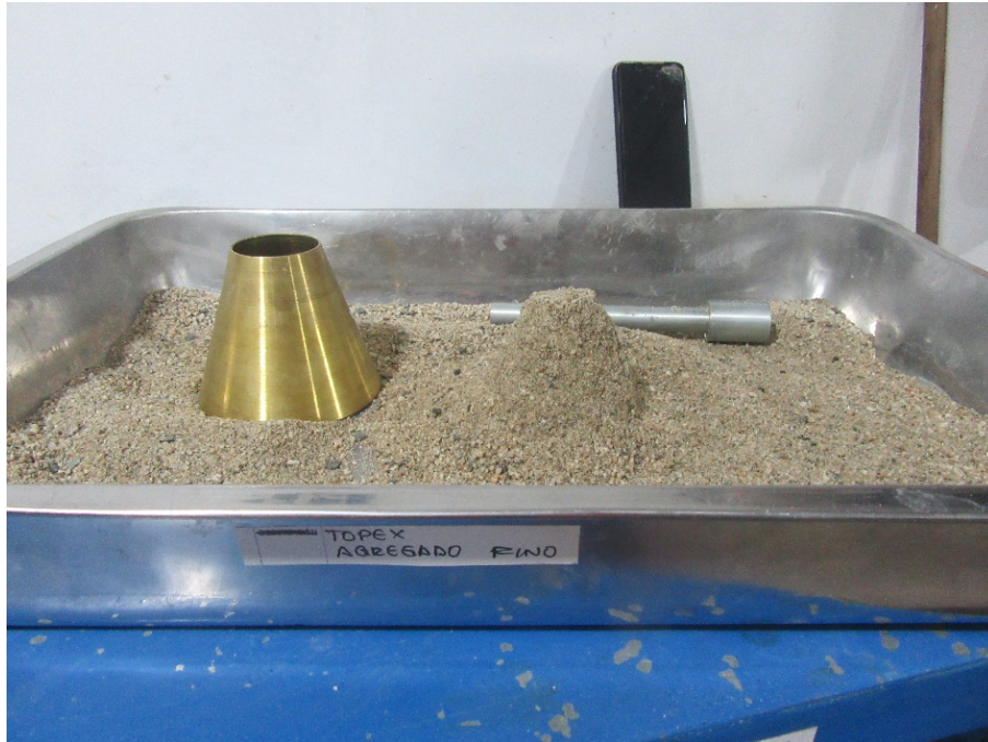
Figura 13. Cono metálico y apisonador para el ensayo de humedad.
