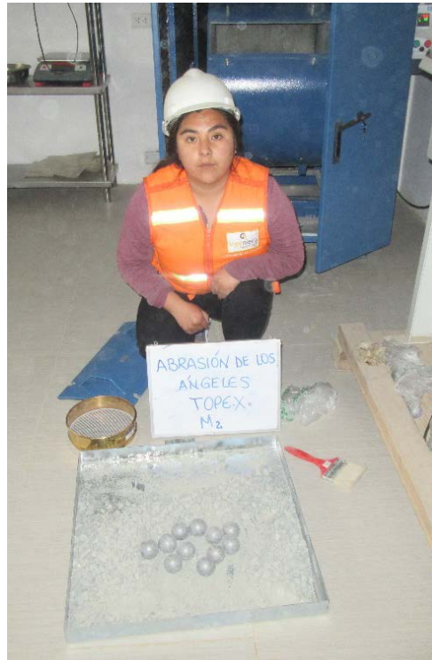
Figura 47. Muestra de agregados retiradas de la máquina.
