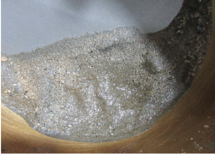
Figura 52. Agregados finos lavados retenidos en la malla N° 200.
