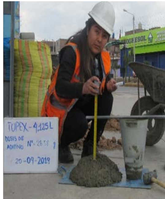
Figura 143. Dosis de aditivo de 150 ml (28.58 g) representada por la mezcla, asentamiento y probeta que evidencia exudación y segregación de materiales (Topex).
