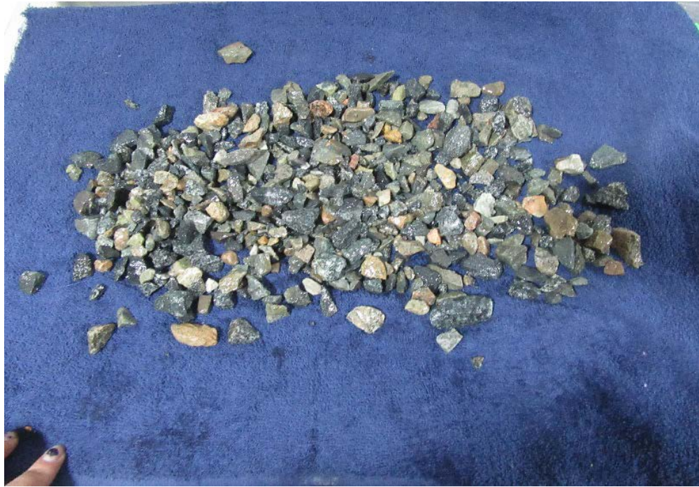
Figura 21. Eliminación de agua superficial haciendo uso de un paño absorbente.
