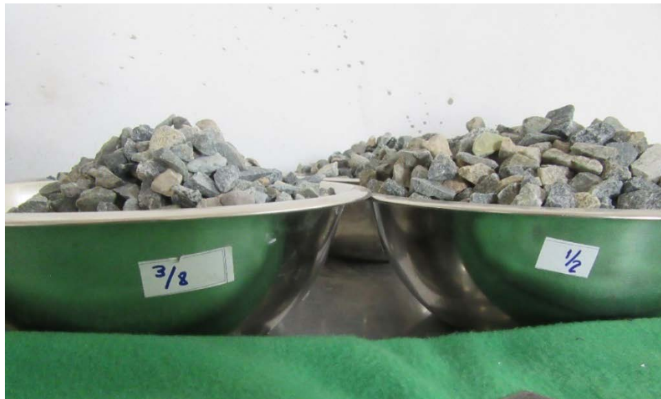
Figura 43. Muestra de agregados limpios y secos clasificados en los retenidos en \frac{1}{2} " y \frac{3}{8} ".
