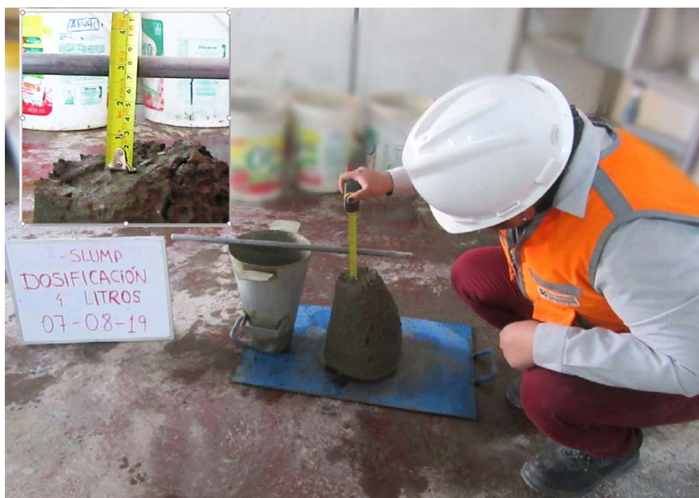
Fotografía 26: Control de asentamiento 2\ 3/4'' de slump de dosificación de 4.00 litros de agua del embolsado Unicon.
