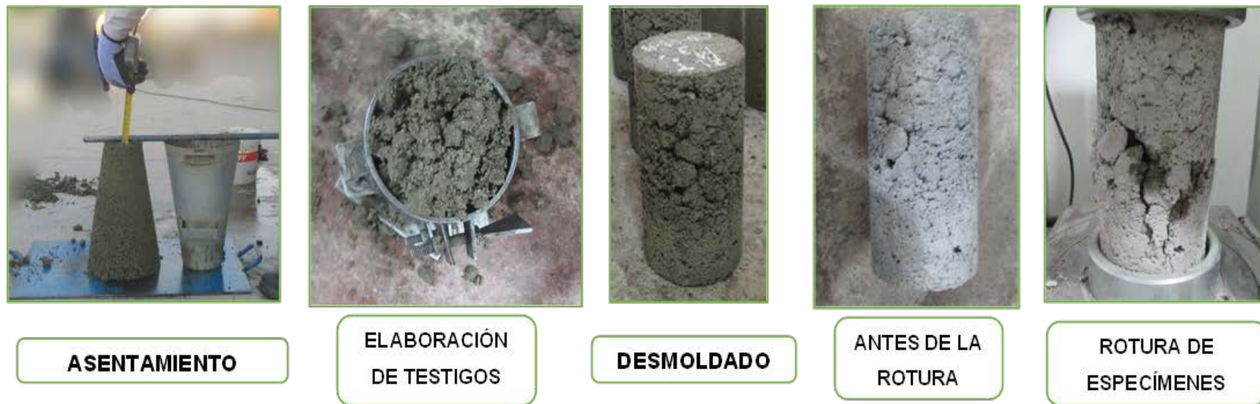
Figura 131. Proceso de elaboración hasta rotura de probetas dosificación de agua de 3 litros Topex.
