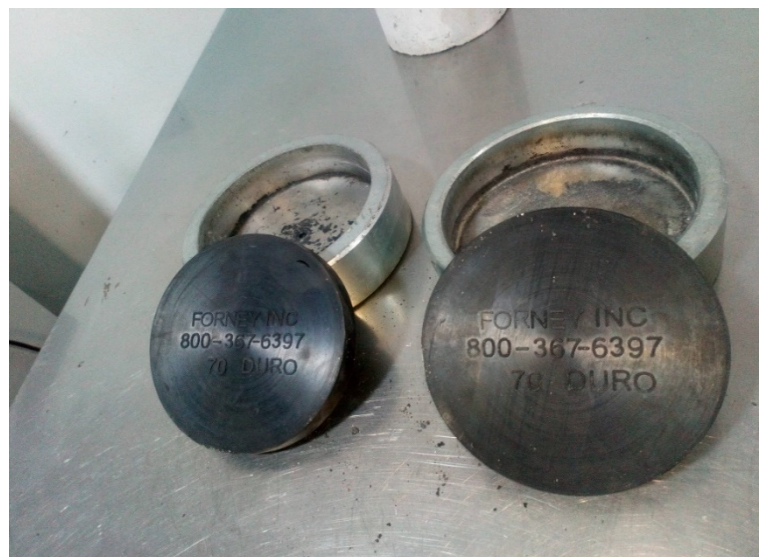
Figura 76. Almohadillas y cabezales que facilitan el ensayo a la compresión del concreto.
