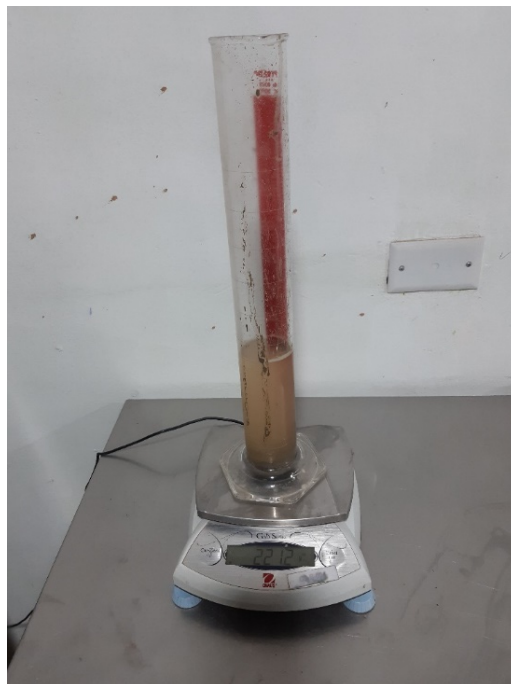
Figura 127. Determinación de la masa del agua total.
