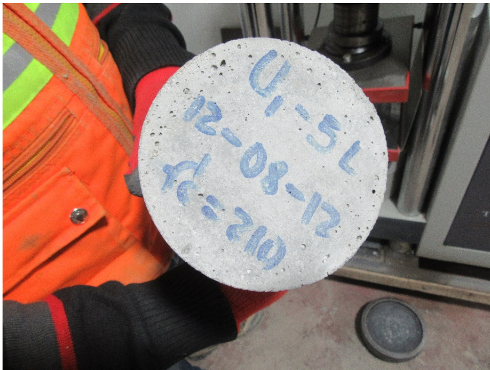
Figura 72. Especimen cilíndrico con los datos correspondientes al rotulado.
