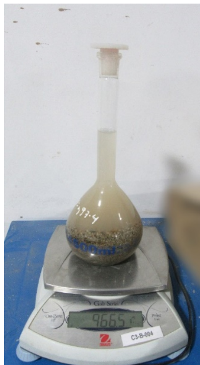
Figura 14. Picnómetro y balanza con la muestra de agregado fino.
