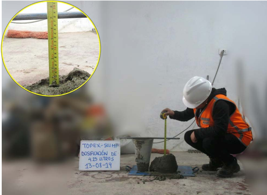
Fotografía 19: Control de asentamiento 6 3/4" de slump de dosificación de 4.25 litros de agua del embolsado Topex.
