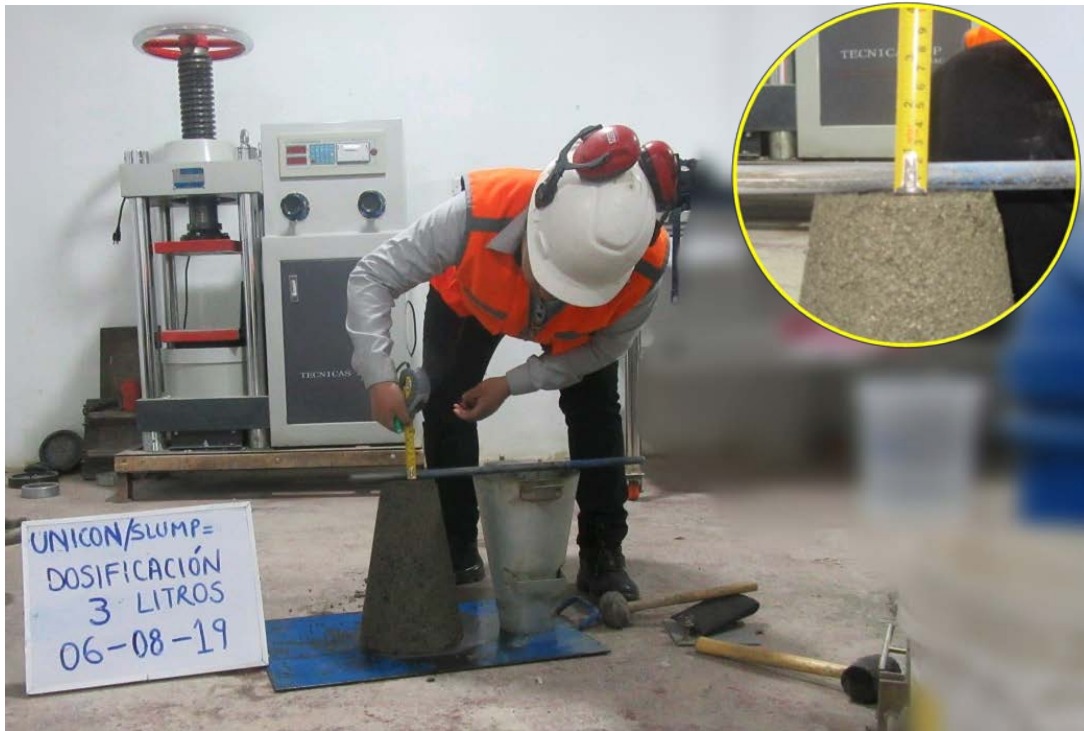
Fotografía 23: Control de asentamiento 0" de slump de dosificación de 3.00 litros de agua del embolsado Unicon.
