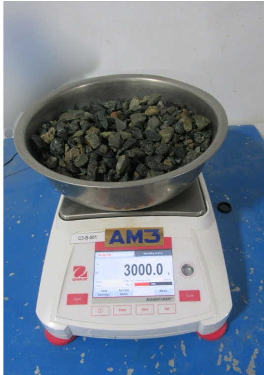
Figura 29. Cantidad de masa para el ensayo.
