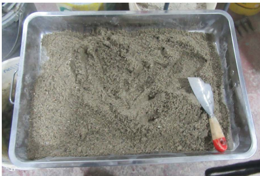
Figura 25. Muestra extendida para secado homogéneo.
