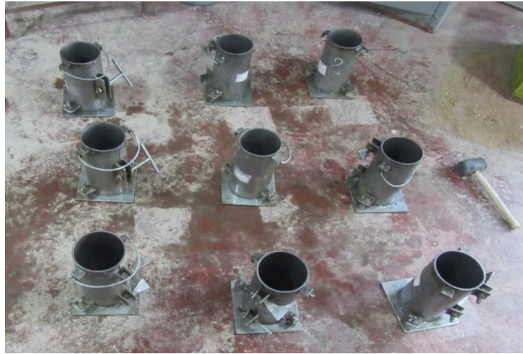
Figura 66. Moldes de 100 mm de diámetro a usar para el ensayo en una superficie nivelada y con desmoldante.
