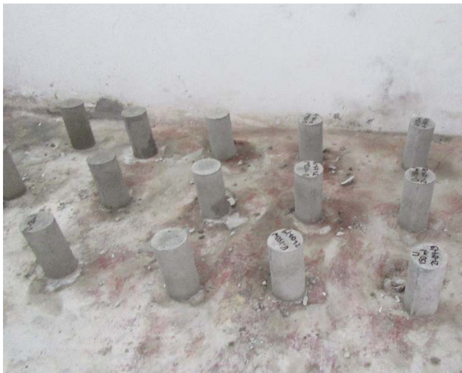
Figura 99. Especímenes cilíndricos posterior al desmoldado.
