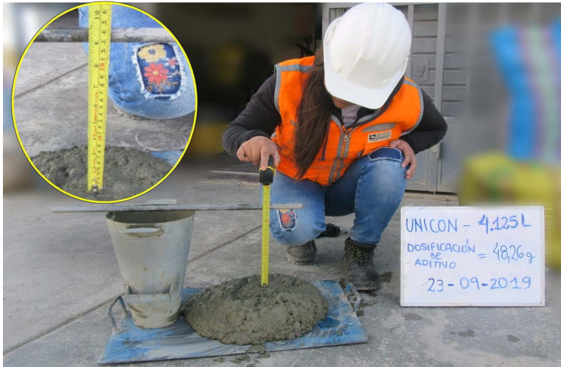
Fotografía 49: Control de asentamiento 9" de slump de dosificación de 48.26g de aditivo Sika Cem Plastificante del embolsado Unicon.
