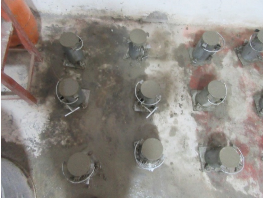
Figura 95. Especímenes cilíndricos que culminaron el proceso de elaboración.
