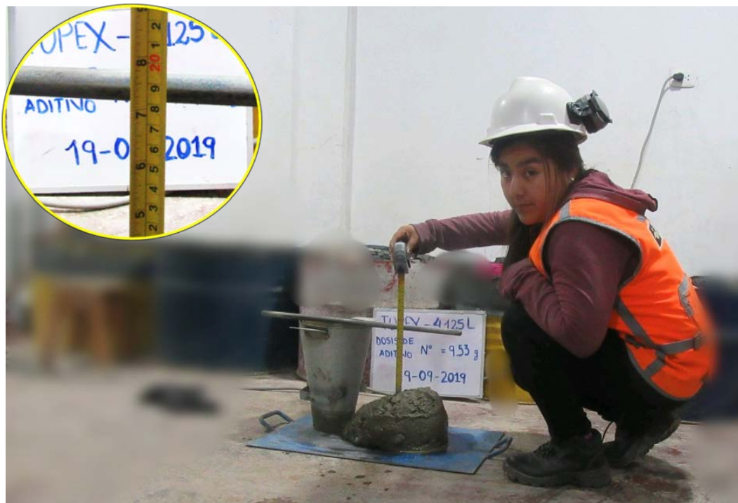
Fotografía 38: Control de asentamiento 7 1/4" de slump de dosificación de 9.53g de aditivo Sika Cem Plastificante del embolsado Topex.
