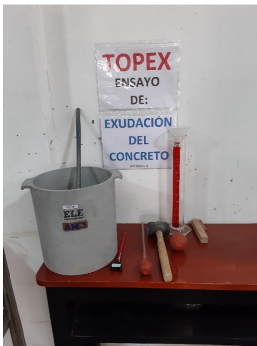
Figura 122. Materiales usados para realizar el ensayo.
