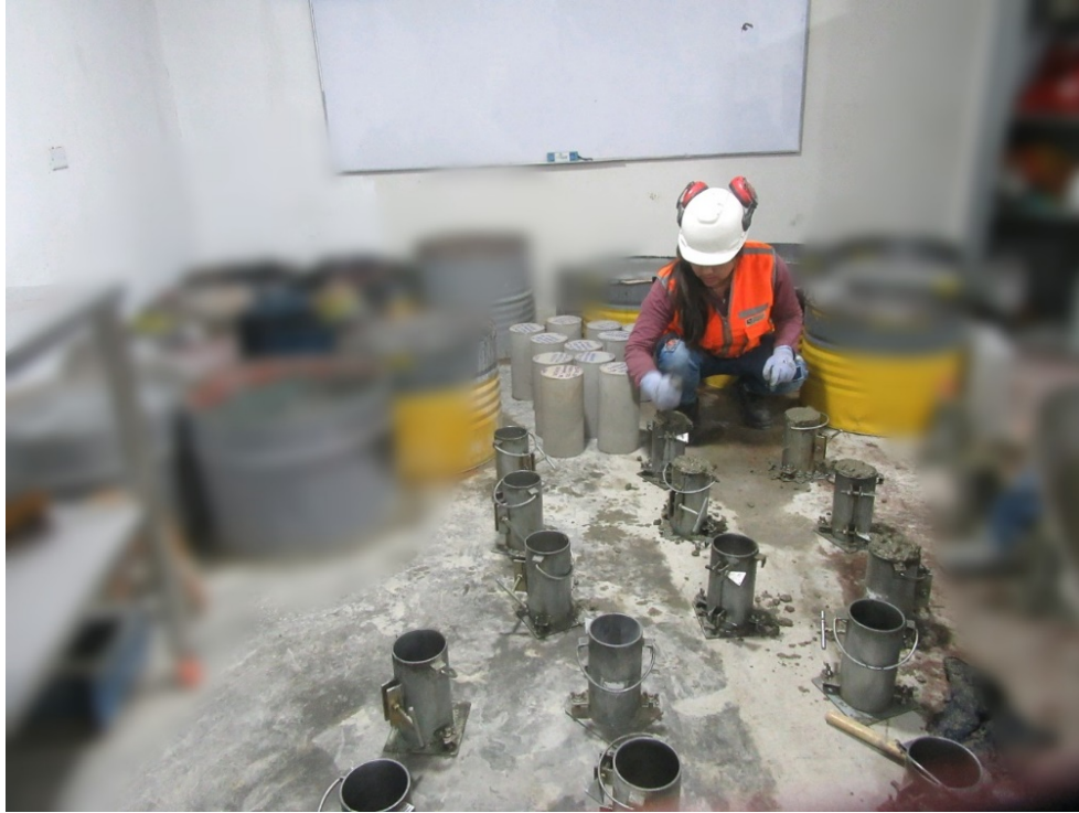
Figura 68. Apisonado de los especímenes y desarrollo del ensayo.
