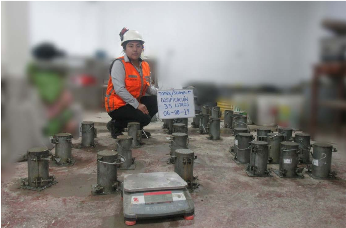
Fotografía 33: Final de la elaboración de los especímenes de concreto.
