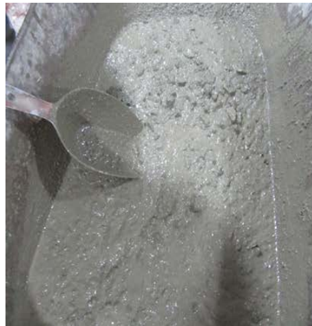
Figura 134. Dosis de agua de 4.75 litros representado por la mezcla, asentamiento, segregación y exudación del concreto Topex.
