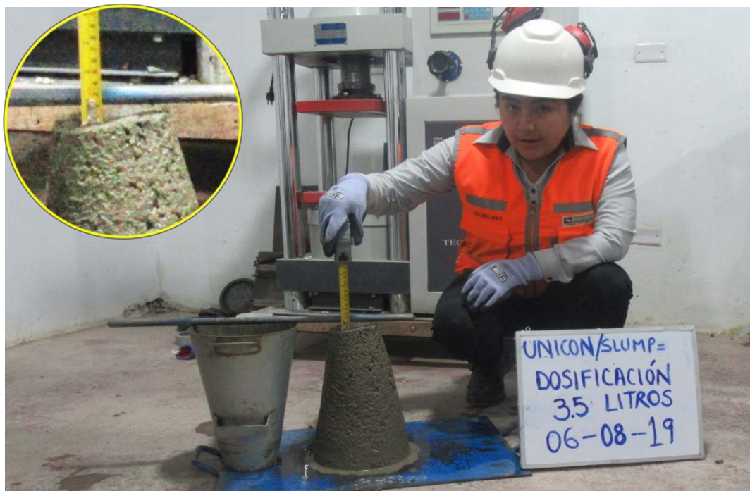
Fotografía 24: Control de asentamiento 1/2" de slump de dosificación de 3.50 litros de agua del embolsado Unicon.
