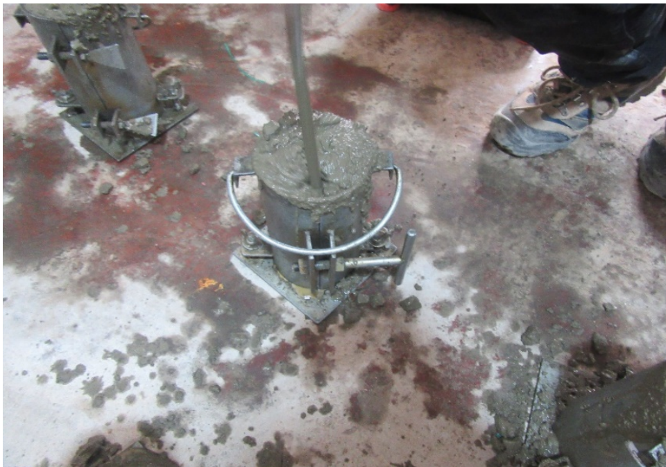
Figura 94. Proceso de compactación de especímenes cilíndricos.
