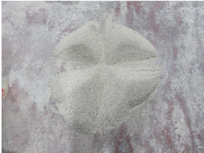
Figura 38. Cuarteo del agregado fino para el ensayo.
