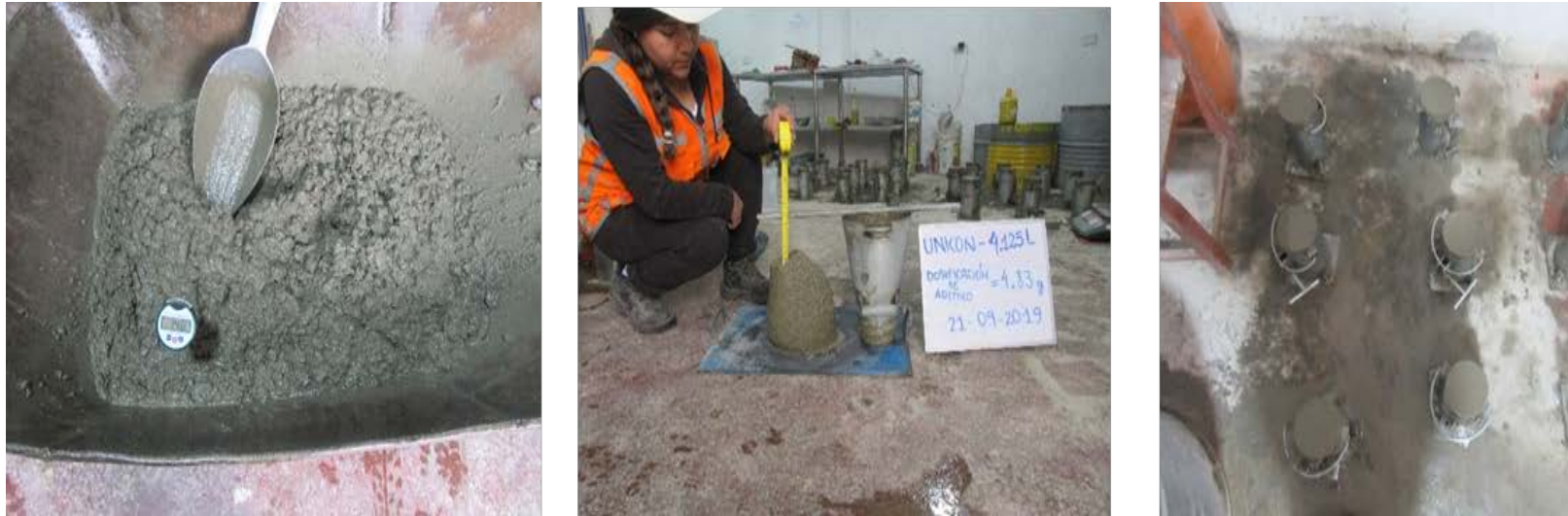
Figura 152. Dosis de aditivo de 25 ml (4.83 g) representada por la mezcla, el asentamiento y probetas.
