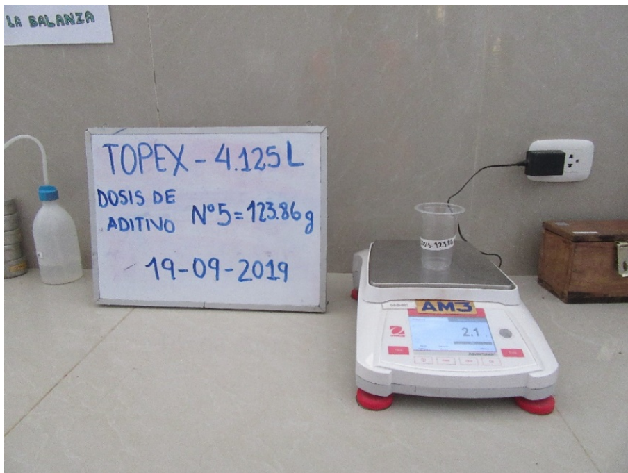
Figura 57. Dosificación del aditivo para el embolsado Topex.
