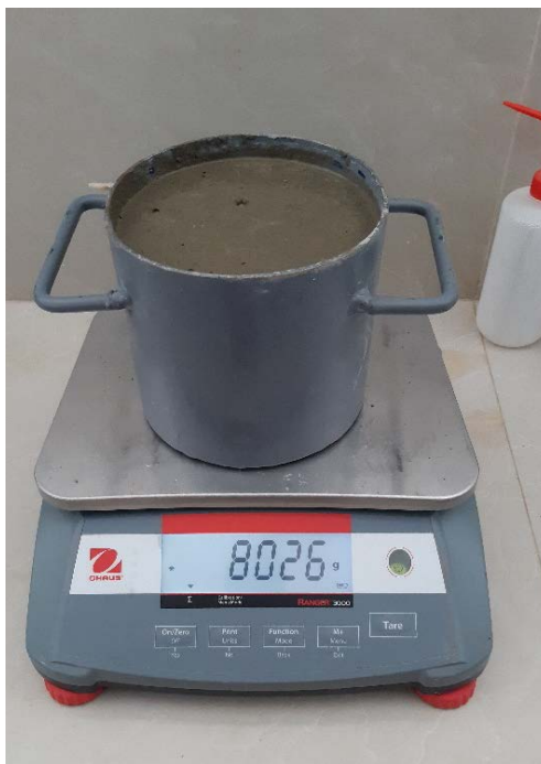
Figura 117. Determinación de la masa del recipiente y el mortero.
