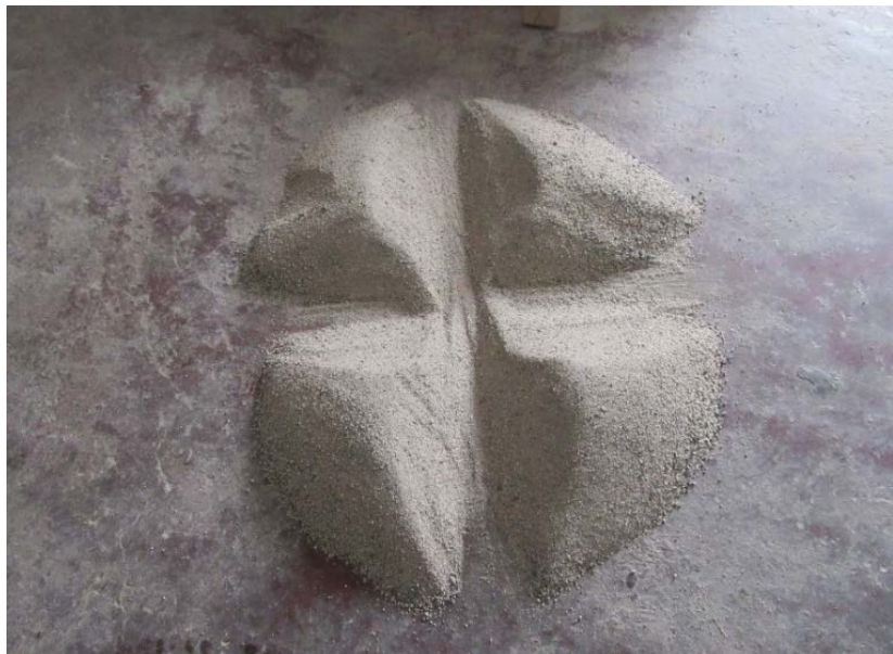
Figura 33. Cuarteo del agregado fino
