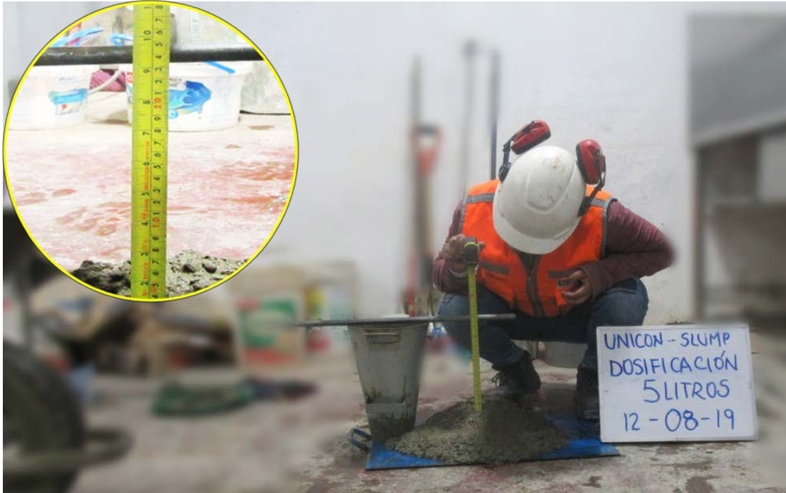
Fotografía 31: Control de asentamiento 9 1/2" de slump de dosificación de 4.75 litros de agua del embolsado Unicon.
