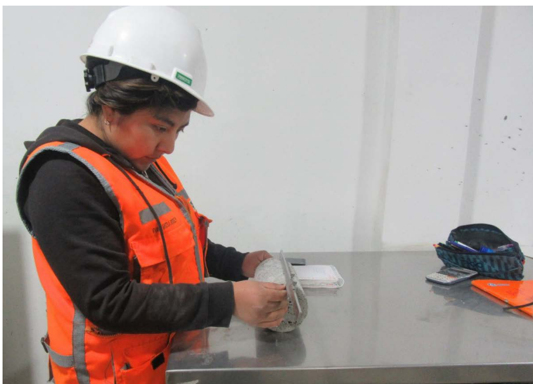
Fotografía 36: Medición de dimensiones del espécimen cilíndrico.
