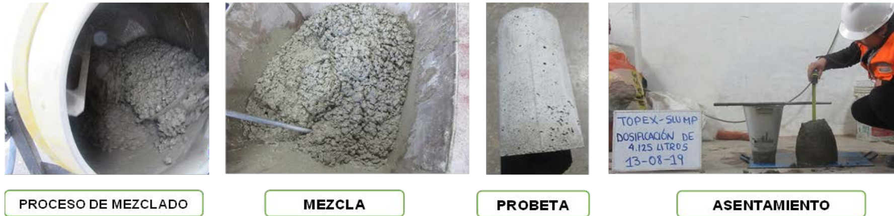
Figura 132. Proceso de elaboración hasta rotura de probetas dosificación de agua de 4.125 litros Topex.
