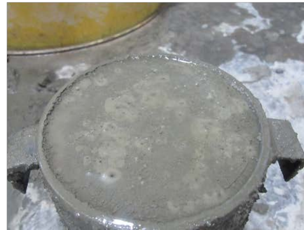
Figura 140. Dosis de agua de 5 litros representada por el asentamiento y la probeta elaborada que evidencia exudación y segregación de materiales Unicon
