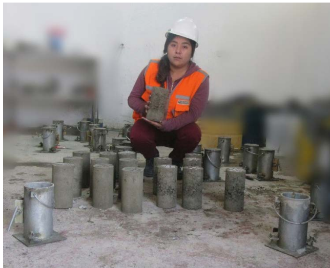
Figura 70. Desmoldado de especímenes cilíndricos.
