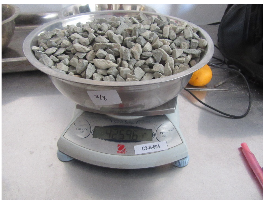
Figura 12. Determinación de la masa retenida por la malla 3/8".
