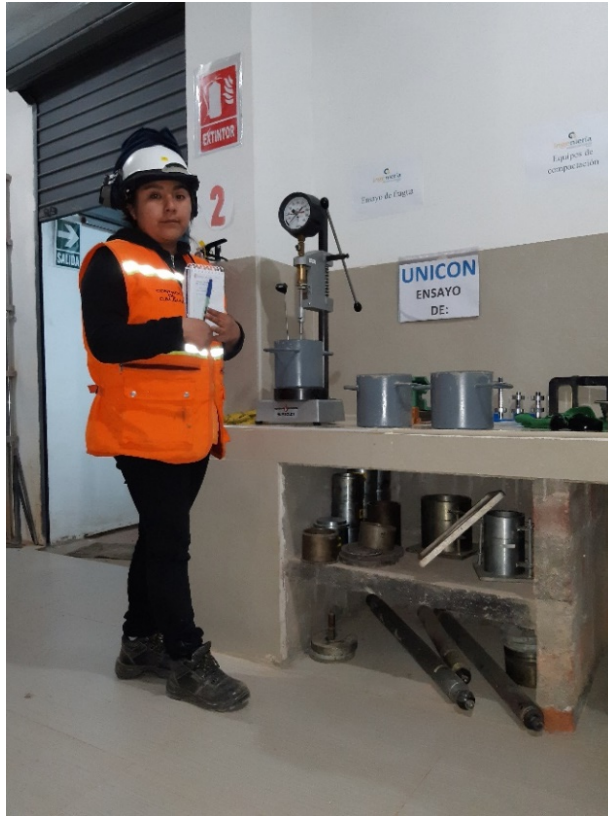
Figura 120. Ensayo de las 3 muestras de tiempo de fragua.
