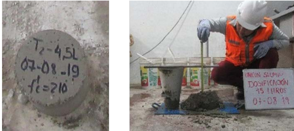
Figura 138. Dosis de agua de 4.5 litros representado por el asentamiento y exudación del concreto en una probeta Unicon.
