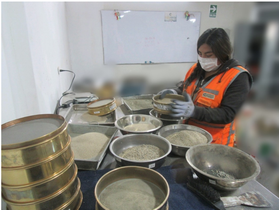
Fotografía 2: Ensayo del análisis granulométrico.
