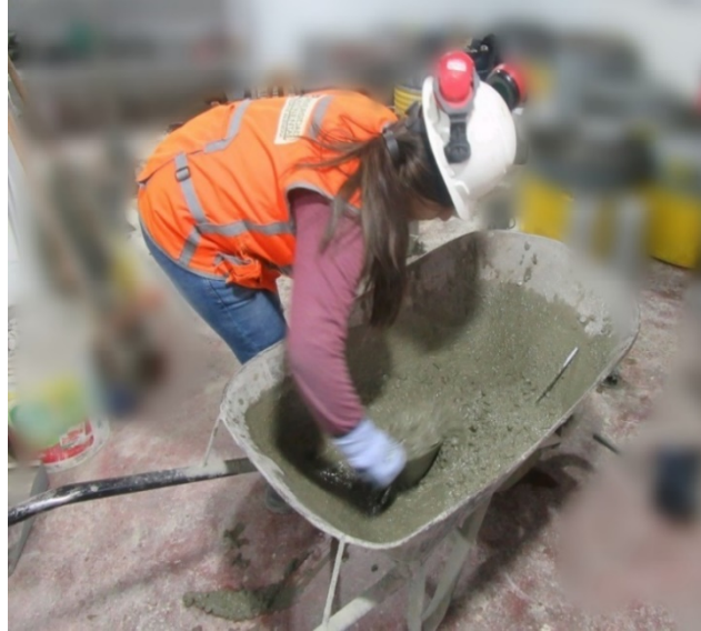
Figura 65. Remezclado de concreto fresco para los ensayos posteriores.
