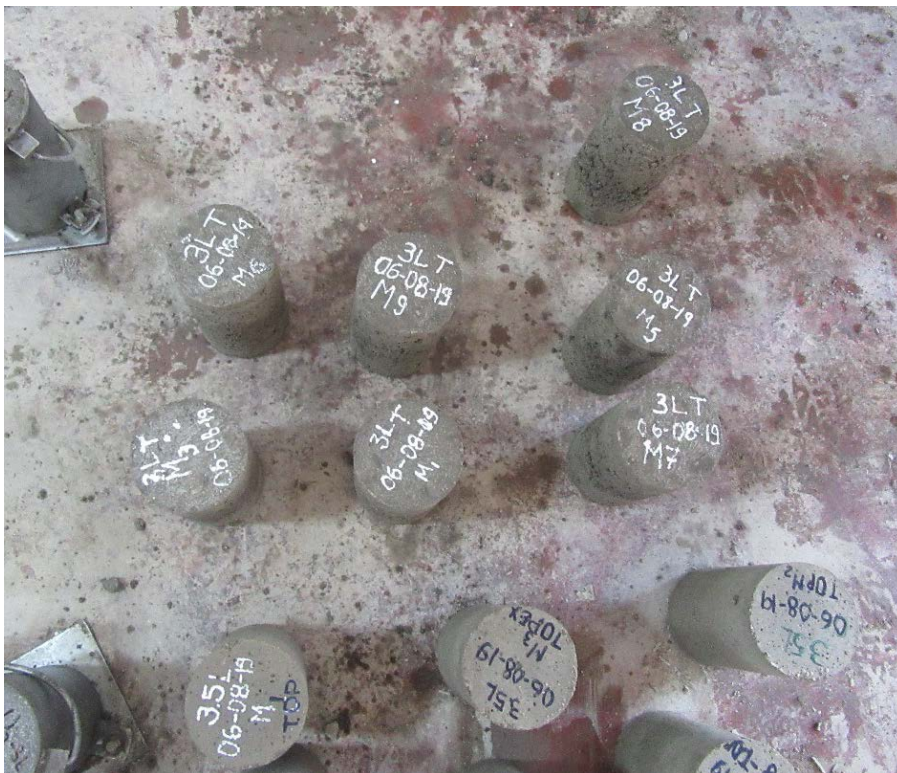
Fotografía 12: Desencofrado de especímenes cilíndricos
