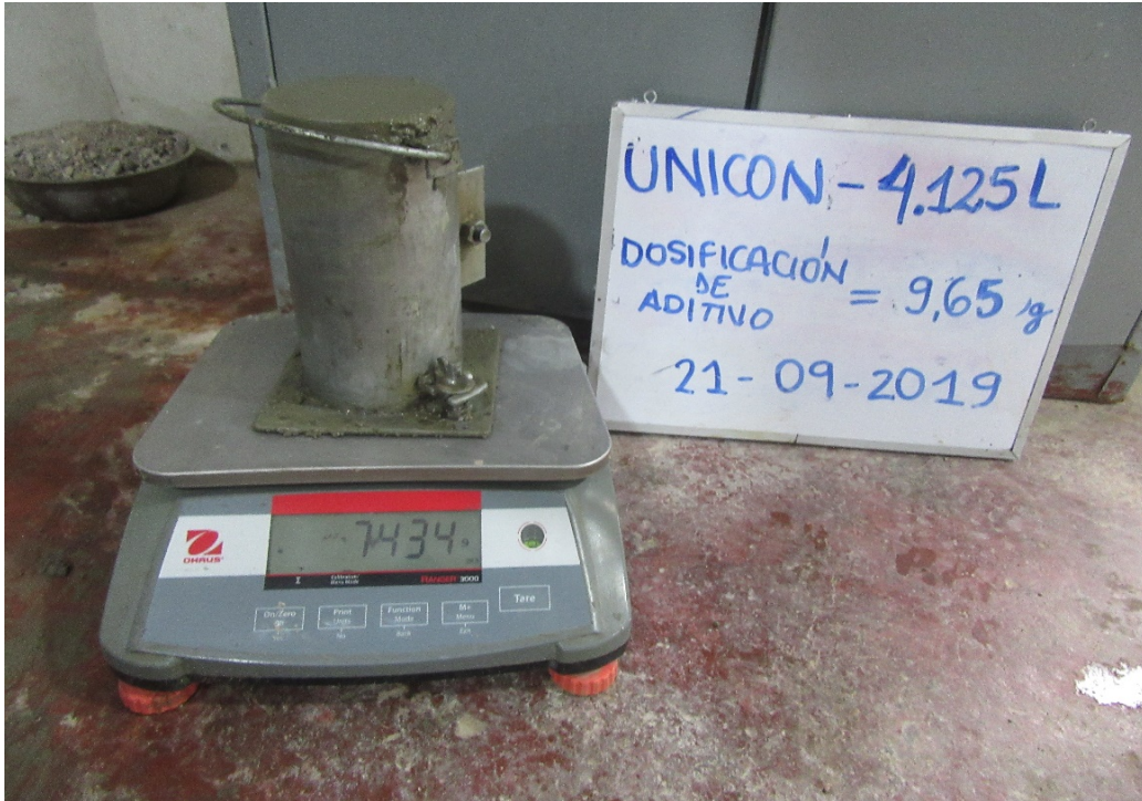
Fotografía 53: Ensayo del peso unitario del concreto.
