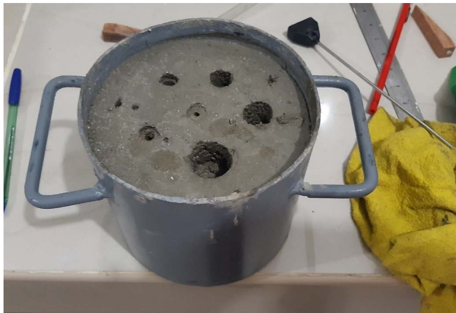
Figura 121. Ensayo de fraguado terminado con las penetraciones de todas las agujas.
