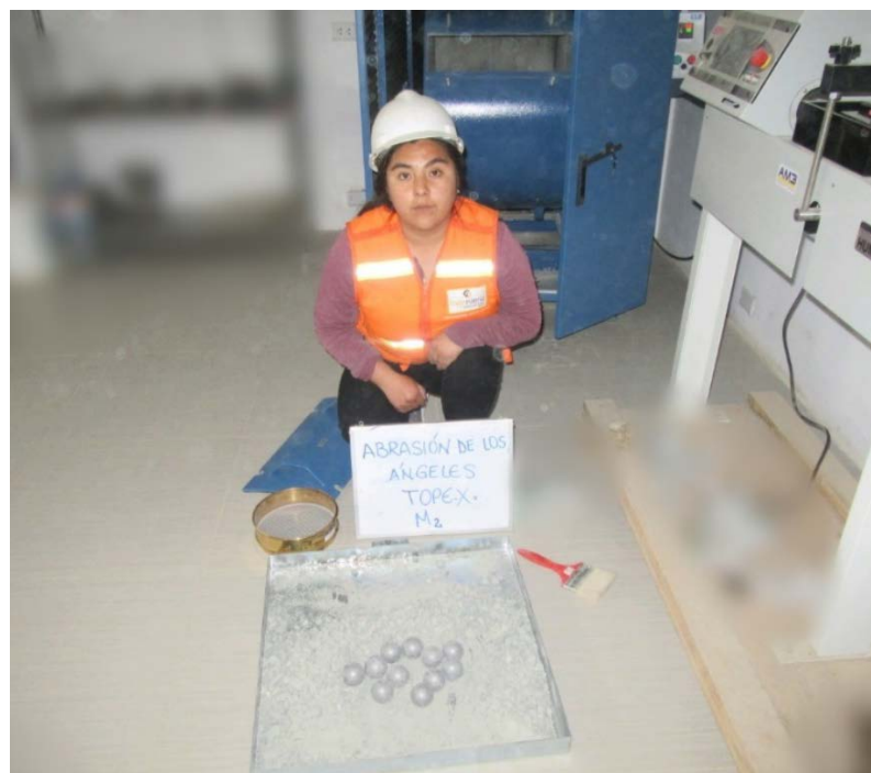
Fotografía 6: Ensayo de abrasión de los Ángeles agregados del embolsado Topex.
