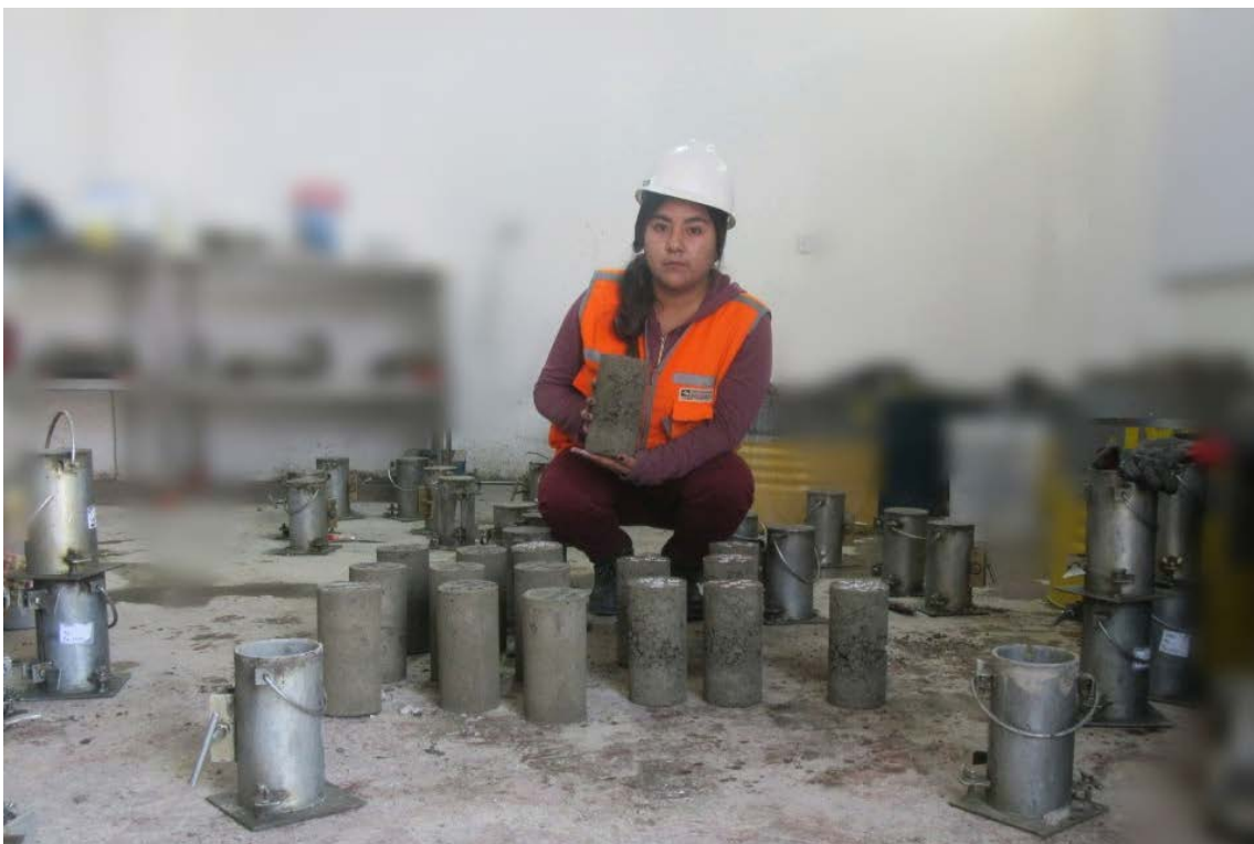
Fotografía 34: Desmoldado de especímenes de concreto.
