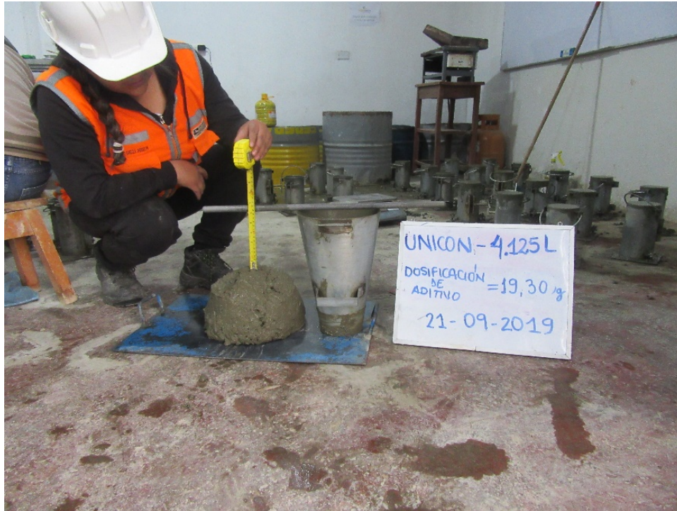
Figura 92. Control de asentamiento de embolsado Unicon con la dosis de 19.30g de aditivo.
