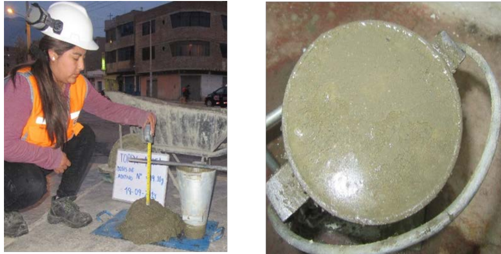
Figura 144. Dosis de aditivo de 100 ml (19.06 g) representada por el asentamiento y probeta que evidencia una ligera exudación (Topex).
