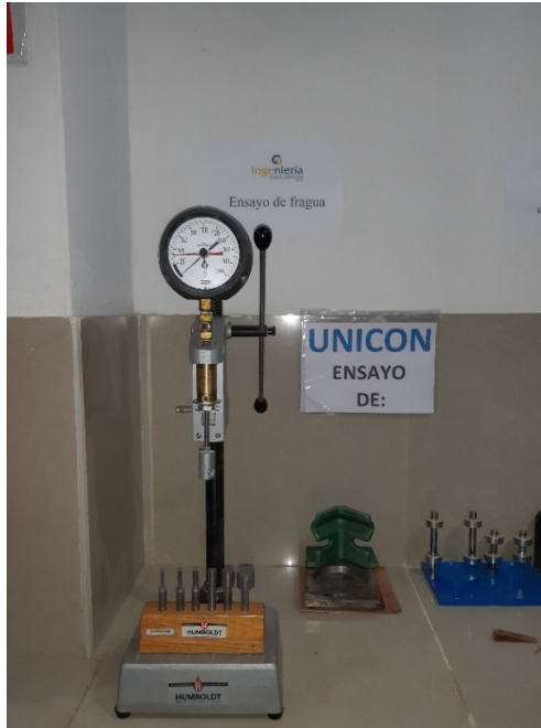
Figura 116. Aparato de carga (penetrómetro) con todas las agujas habilitado para el ensayo de tiempo de fraguado.
