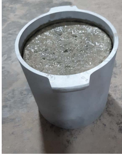
Figura 128. Ensayo de exudación finalizado sin la presencia de agua en la superficie.
