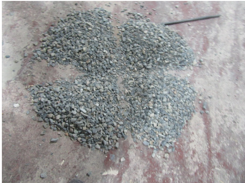
Figura 36. Cuarteo para el ensayo de masa por unidad de volumen suelto del agregado grueso.
