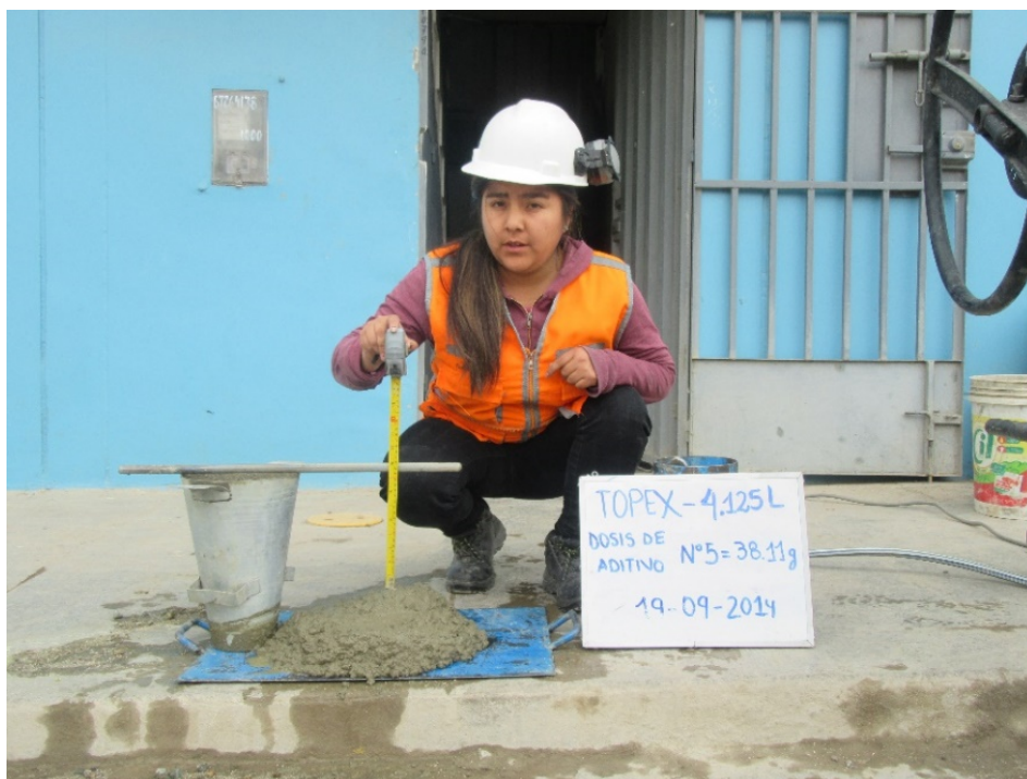
Figura 91. Control de asentamiento de concreto para el embolsado Topex con la dosis de aditivo de 38.11 g.
