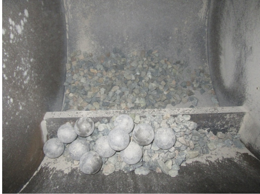
Figura 46. Muestra del agregado en la máquina de abrasión de Los Ángeles, posterior a su ensayo.
