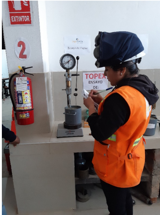
Figura 118. Registro en el dial de los datos de penetración.
