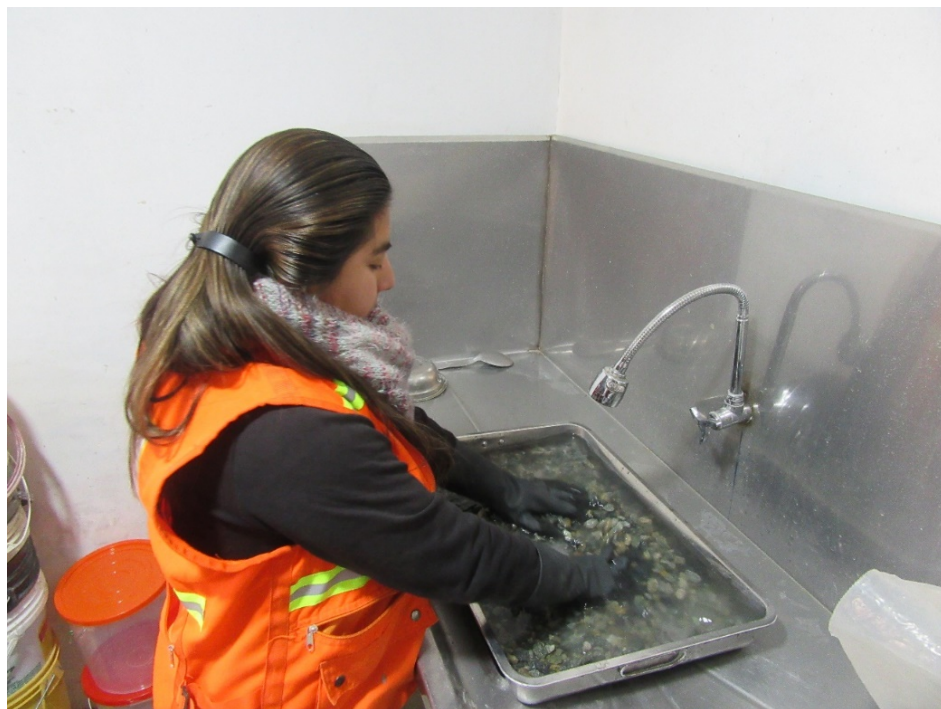
Figura 49. Lavado del agregado grueso retenido en el tamiz N°12.
