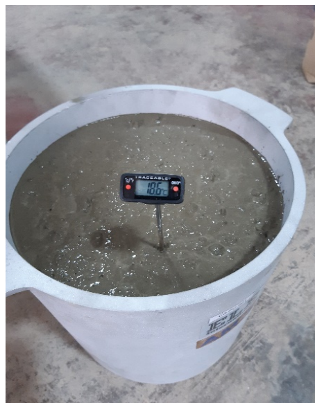
Figura 105. Toma de temperatura en el ensayo de exudación del concreto en estado fresco.
