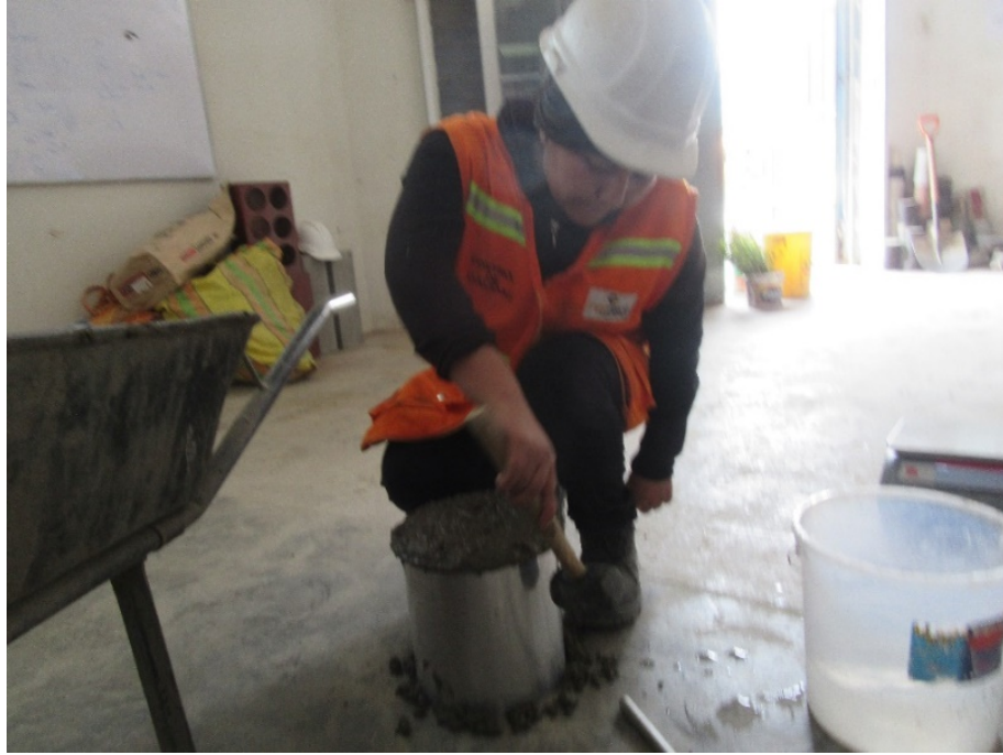
Figura 111. Realización del ensayo de contenido de aire usando el mazo de goma.
