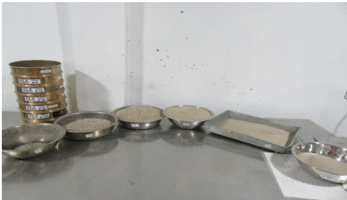
Figura 11. Muestras que representan la cantidad por cada retenido.
