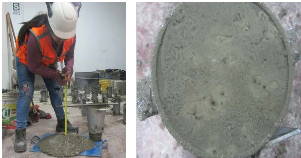
Figura 135. Dosis de agua de 5 litros representada por el asentamiento y la probeta que evidencia exudación y segregación de materiales Topex.
