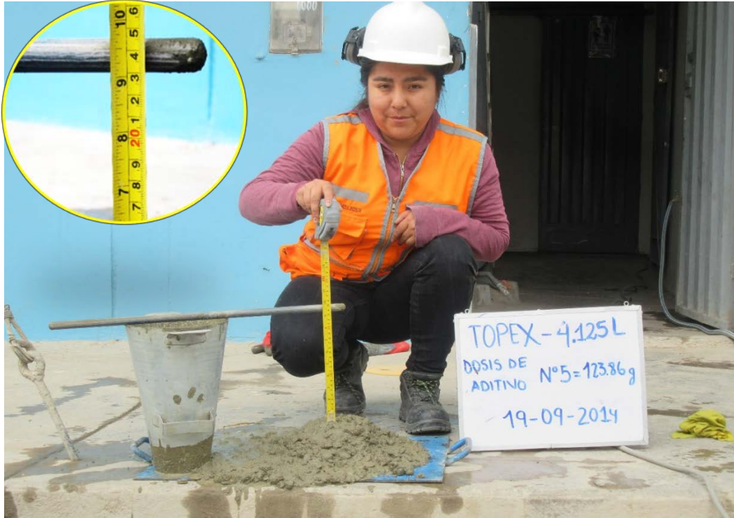
Fotografía 43: Control de asentamiento 9 1/4" de slump de dosificación de 123.86g de aditivo Sika Cem Plastificante del embolsado Topex.
