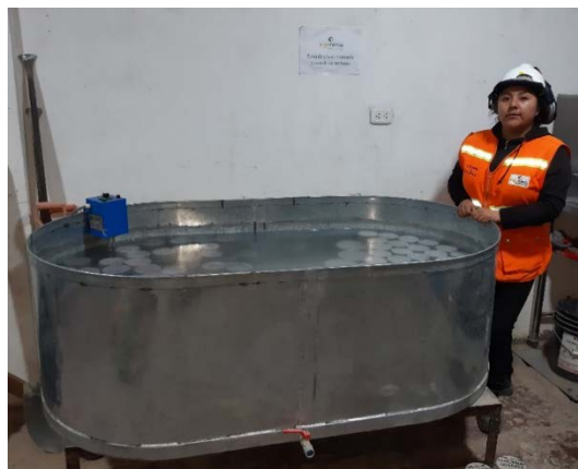
Figura 73. Posa de curado de especímenes de concreto.
