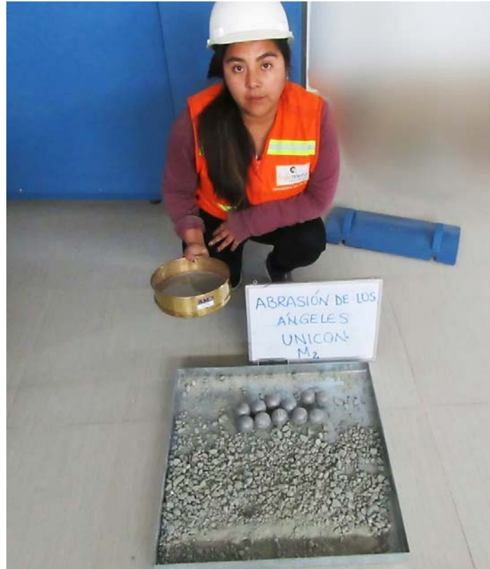
Fotografía 5: Ensayo de abrasión de los Ángeles del embolsado Unicon.
